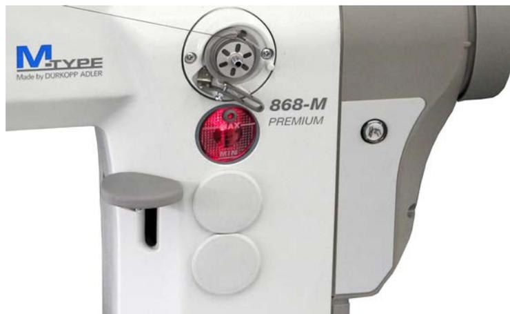
2. Si le niveau d'huile est inférieur au repère minimum (1) : Ajouter de l'huile par l'orifice de remplissage (1) sans dépasser le repère de niveau maximum (2).
