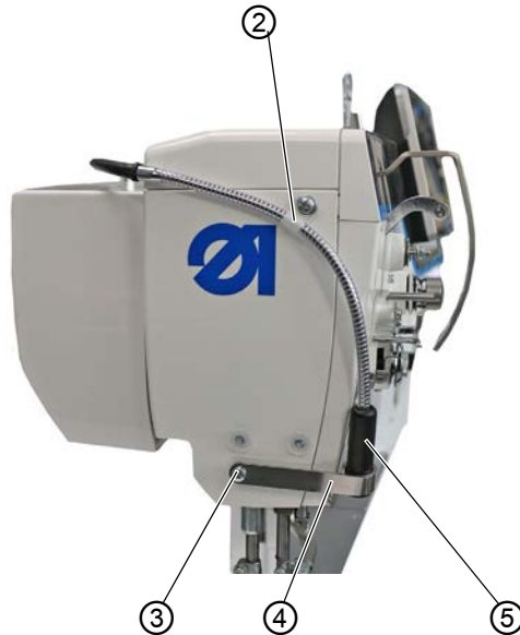
Image 80: Monter la lampe de couture à diodes (2)
