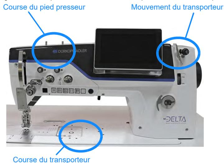
En position de piquetage *Levée de boucle*, il est possible d'effectuer tous les réglages de base pour **Course du pied presseur**, **Course du transporteur** et **Mouvement du transporteur**.
