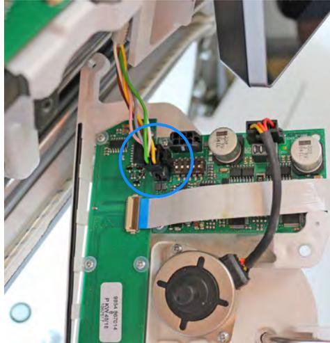
Sur les machines à 2 aiguilles, le connecteur doit être retiré de la borne **X103** depuis la platine derrière la plaque de tension des fils.
