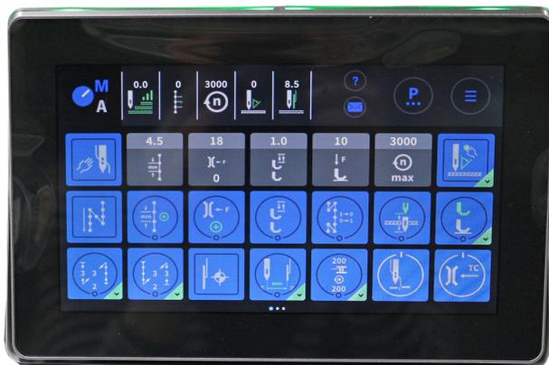
Tous les réglages du logiciel de la machine se font via le panneau de commande Commander DELTA.
