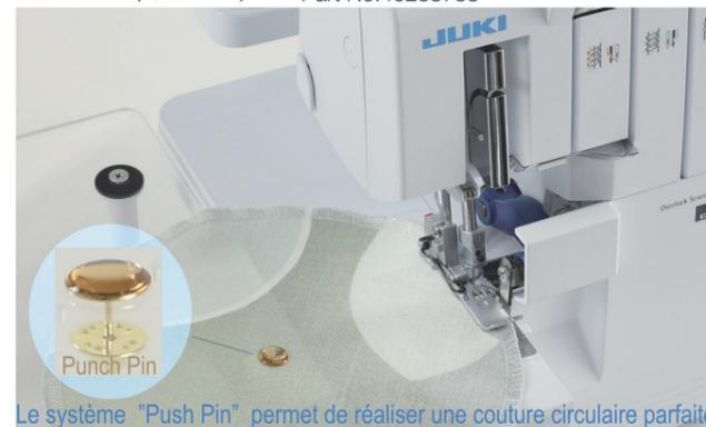
Le système "Push Pin" permet de réaliser une couture circulaire parfaite
