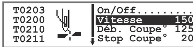
Lors de l'activation du paramètre *Vue paramètre*, les menus en mode manuel et en mode automatique comportent un élément supplémentaire : *Appel paramètre*. Cette fonction est décrite séparément (📖 p. 70).
