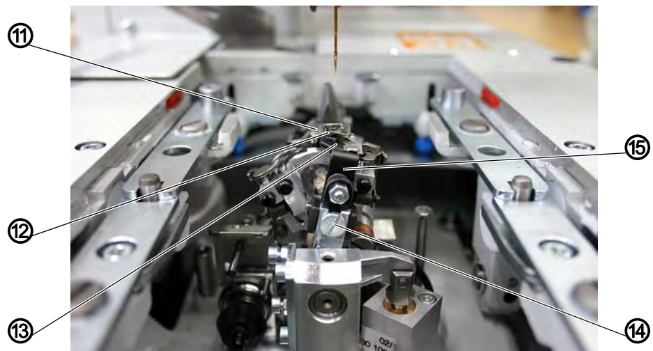
Abb. 113: Régler la pince du fil de crochet (3)
