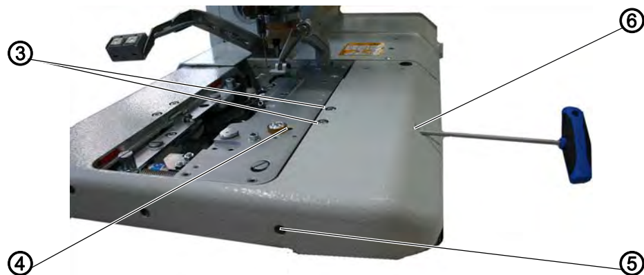
Abb. 31: Plaques de serrage, régler l'écartement (2)
