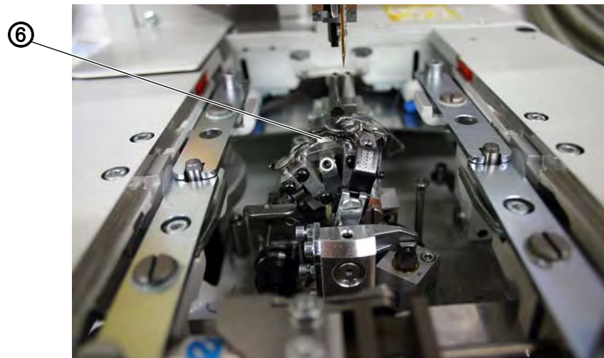
Abb. 81: Régler le couteau de fil d'aiguille (3)
