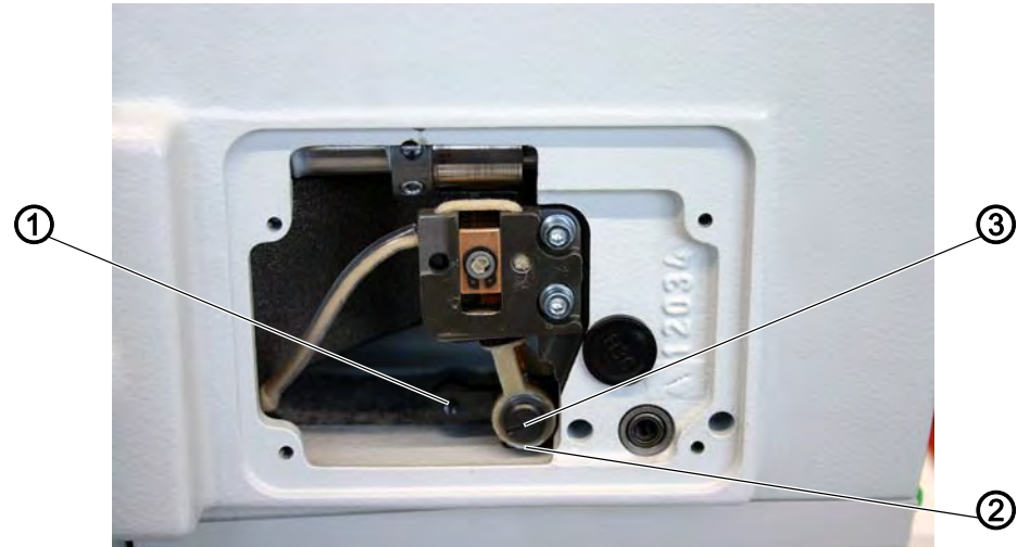
Abb. 41: Régler la largeur de point zigzag
