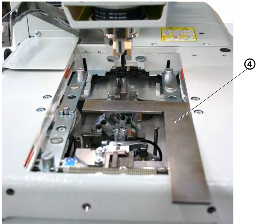
Abb. 15: Aligner le support de crochet (4)
