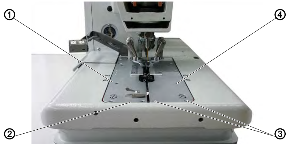
Abb. 27: Insérer les plaques de serrage
