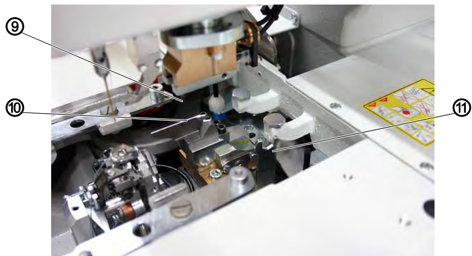
Abb. 52: Régler le couteau, Multiflex (2)
