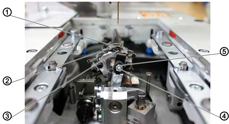
Abb. 111: Régler la pince du fil de crochet (1)
