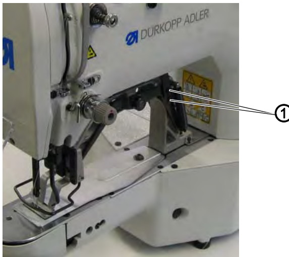
Fig. 22: Régler les pieds-presseurs
