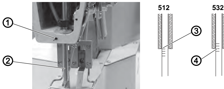
Fig. 16: Régler la hauteur de la barre à aiguille
