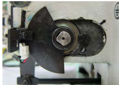
Fig. 32: Disque de capteur du dispositif coupe-fil
