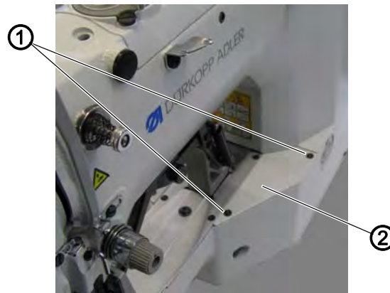
Fig. 4: Enlever et remettre la protection latérale à droite
