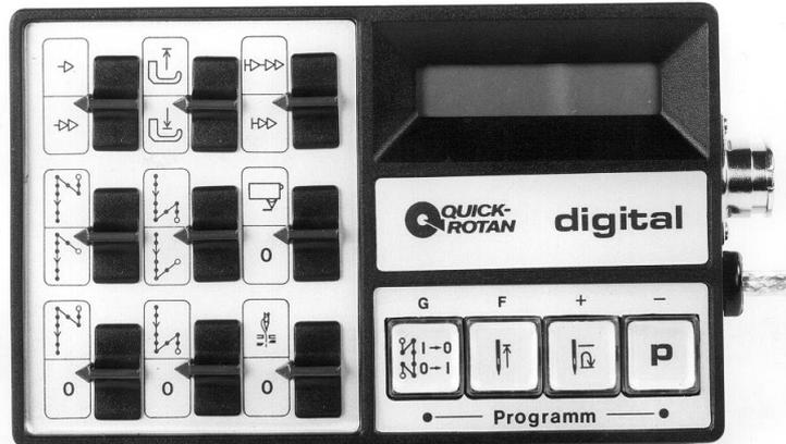
Afin d'éviter la modification de paramètres par mégarde, on ne peut y avoir accès qu'en passant par le niveau TECHNICIEN.
