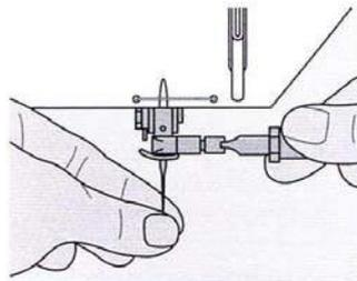
Pour desserrer et bien resserrer la vis, utiliser le tournevis, prévu à cet effet; il est inclus dans les accessoires.
