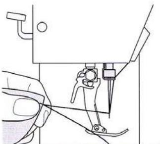
Avant d'enlever l'ouvrage, amener le tendeur de fil à sa position supérieure. Alors seulement, le fil est libéré et peut être tiré vers l'arrière.
