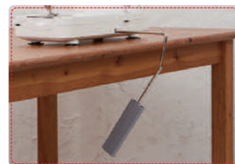
● Levier de Genouillère Le levier de genouillère fourni permet de lever ou baisser le pied presseur sans utiliser les mains. Le pied-de-biche peut être levé à une hauteur de 12mm.
