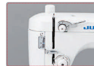
● Pression du Pied Presseur Le réglage de la pression du pied presseur peut être ajusté pour tenir compte des différentes épaisseurs de tissu en tournant le régulateur situé sur le haut de la machine.
