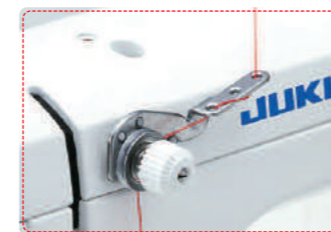
● Unité de Pré-tension L'unité de pré-tension est le même système qui est monté sur nos machines industrielles. Il assure une meilleure alimentation au second bloc de tension et donc par la suite à l'aiguille. Il offre un débit de fil beaucoup plus régulier et permet une couture nettement plus précise à des vitesses élevées car il permet un meilleur lissage et moins de flottement du fil.
