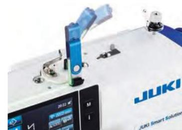
Les données de couture peuvent être gérées numériquement pour garantir la « qualité constante » et la « réduction des délais nécessaires aux changements de configuration ». Les données de couture quantifiées peuvent être extraites de la machine à coudre au moyen d'une tablette Android ou d'une clé USB.
