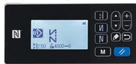
Les données de couture peuvent être gérées numériquement pour garantir la « qualité constante » et la « réduction des délais nécessaires aux changements de configuration ». Les données de couture quantifiées peuvent être extraites de la machine à coudre au moyen d'une tablette Android ou d'une clé USB.
