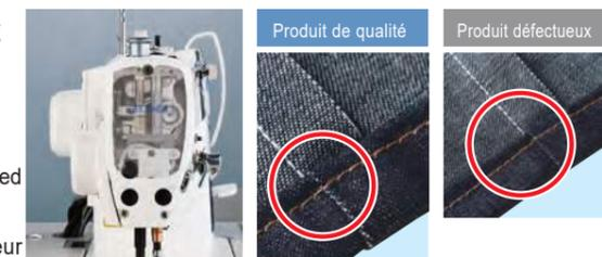
**Le mécanisme de pression du pied presseur actif démontre son efficacité dans la prévention de l'amasement de points et de points lâches.**
