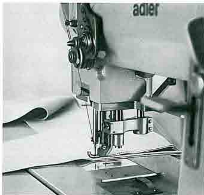
Adler 167-72/V 1 Zusammensteppen und Beschneiden von Taschentellen Joining and trimming bag section Assemblage avec coupe simultanée de poches Pespunteando y recortando piezas de bolsas
