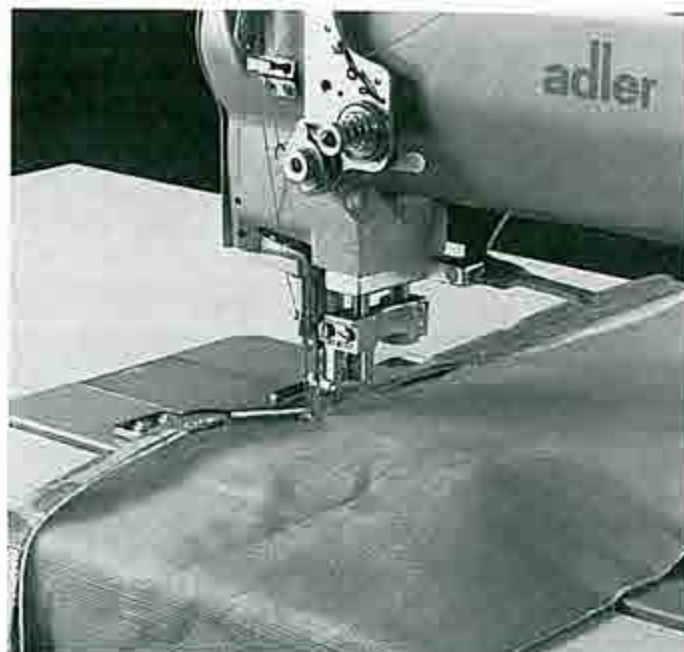
Nähen von Keder mit Kordel einlage Sewing of piping with insert Piquage d'un passepoil avec renfort de cordon Aplicar vivos con intercalación de un cordón
