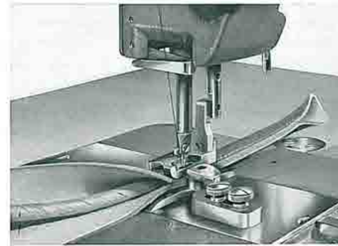
Nähen von gestanzten Handtaschengriffen mit GPK 78 Sewing of handbag handles with GPK 78 Piquage d'un poignée de sacs à main à l'aide du GPK 78 Cosiendo asas de bolsas con GPK 78
