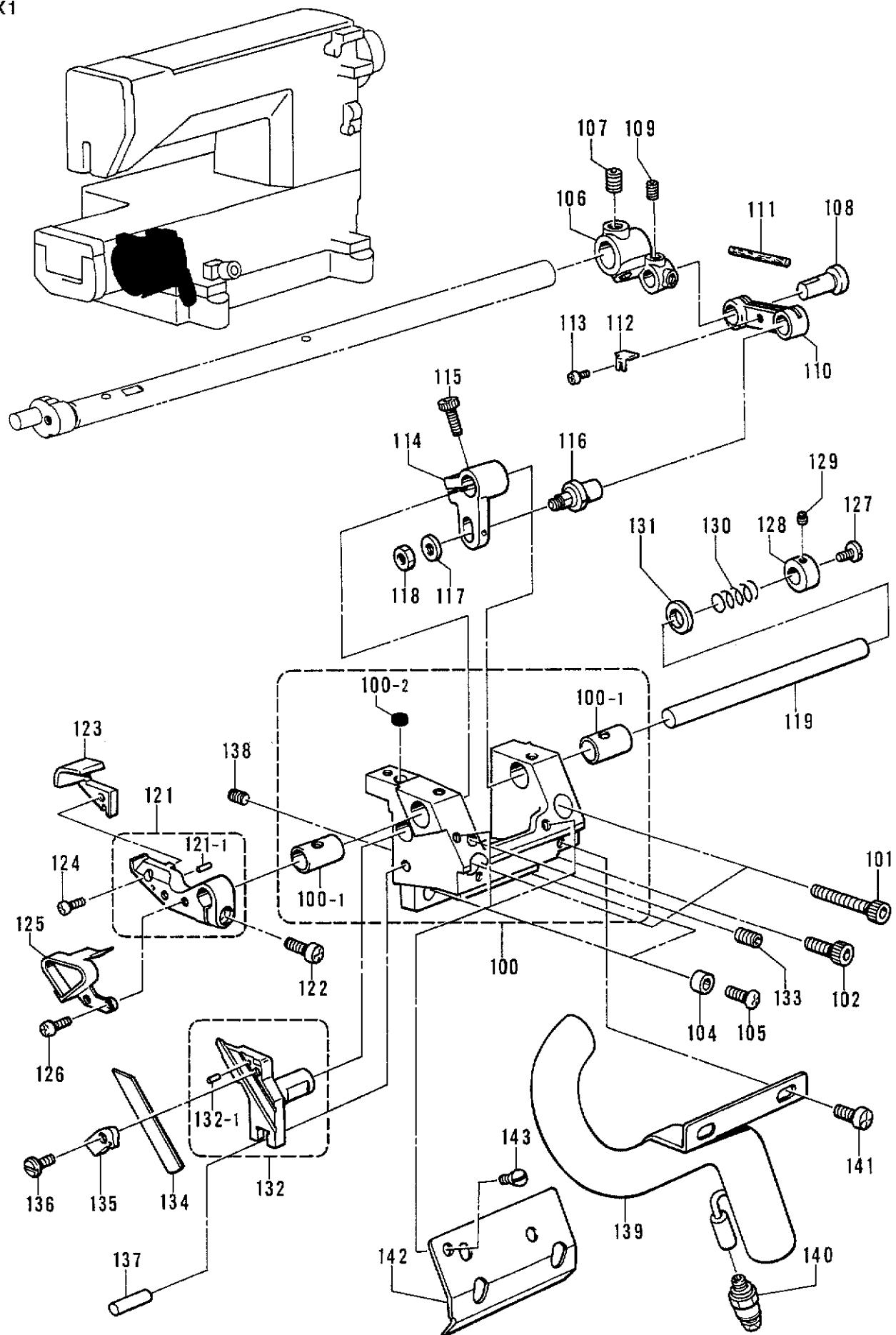
M2. トリミングメス関係 / Trimming knife mechanism / Fadenabschneidemessereinheit
