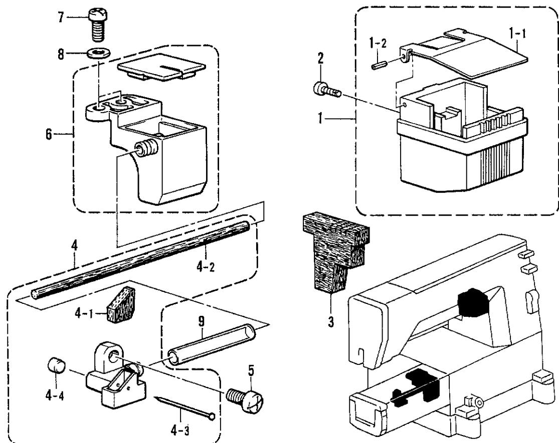
C2. 押工関係 / Presser foot mechanism / Stoffdrückerfuß /
