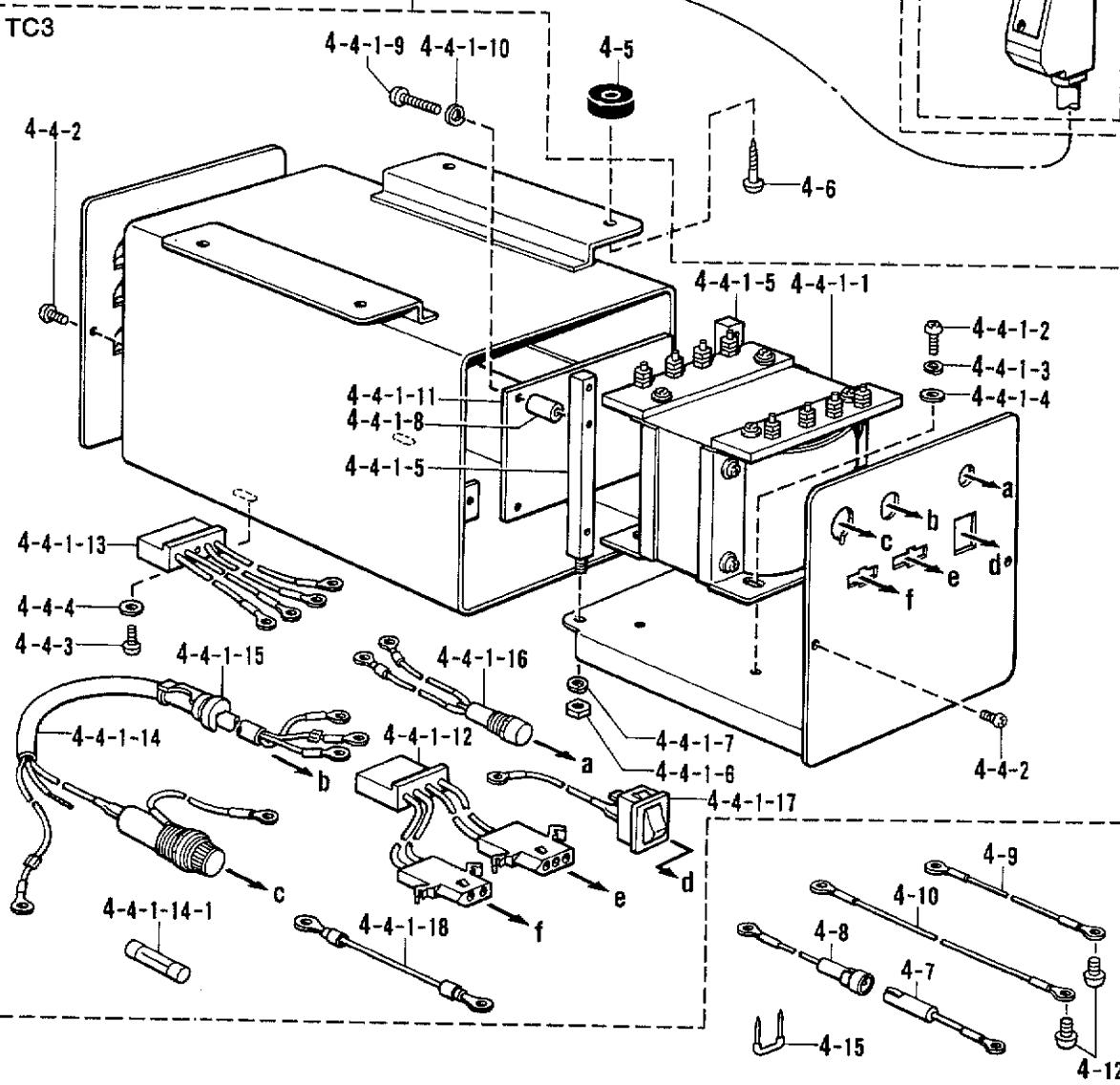
Q5. テープカッター装置関係 / Tape cutter mechanism / Bandabschneidesolenoid /
