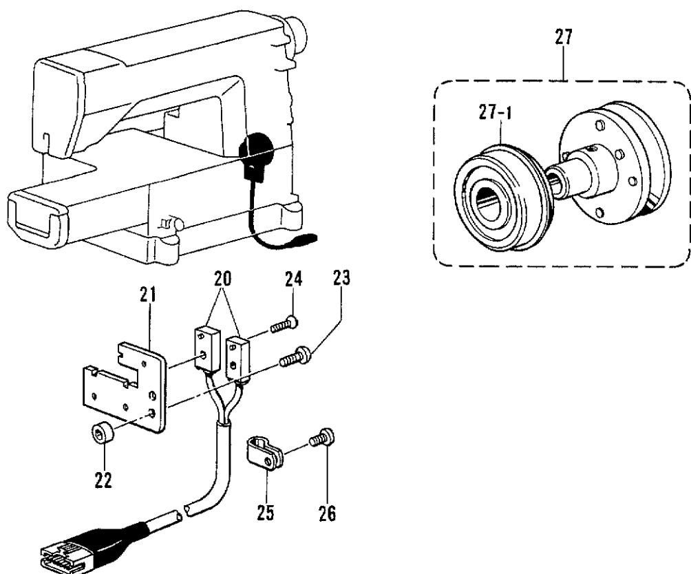
Q1. 電磁式テープカッター装置関係 / Solenoid type tape cutter mechanism / Bandabschneidesolenoid /
