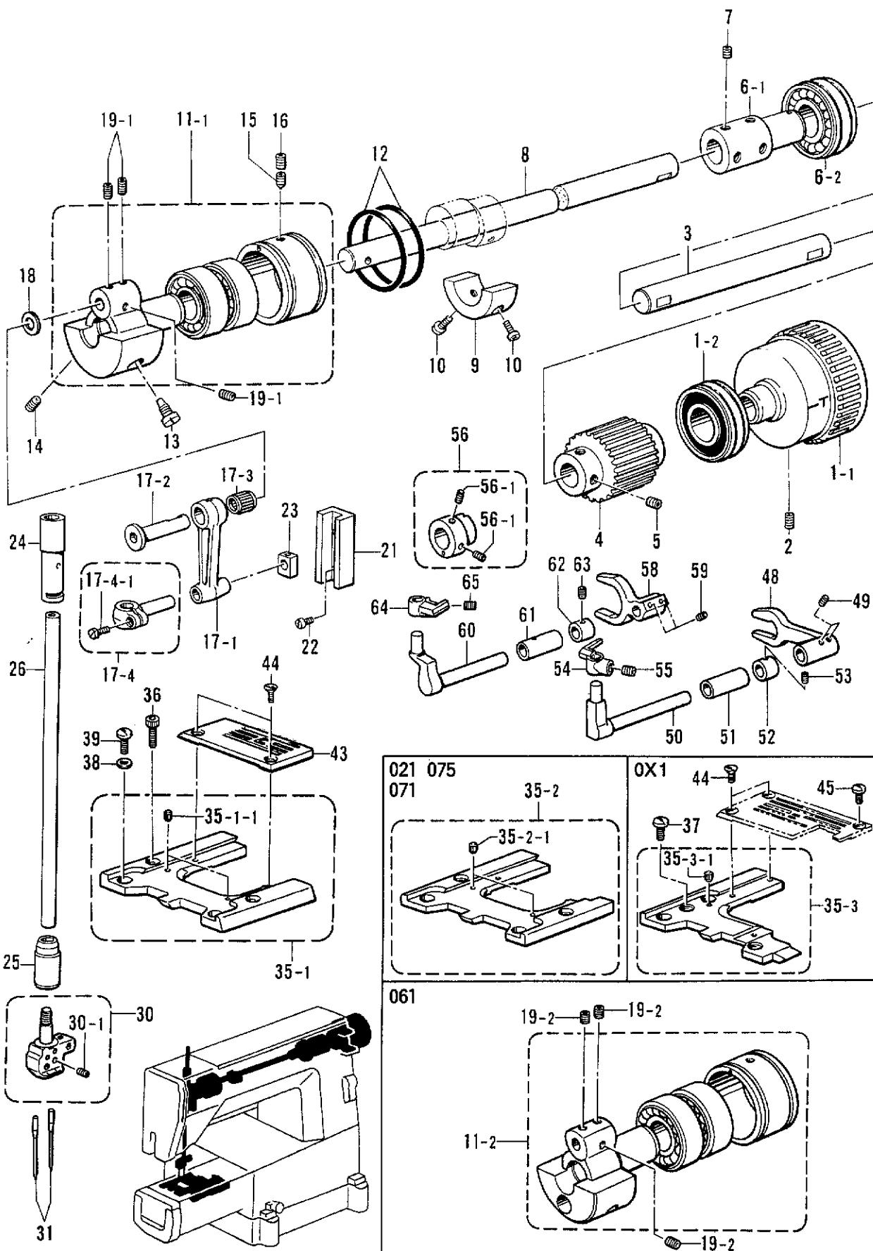
B. 上軸・針棒関係 /Upper shaft and needle bar mechanism/ Obere welle und Nadelstangenvorrichtung /
