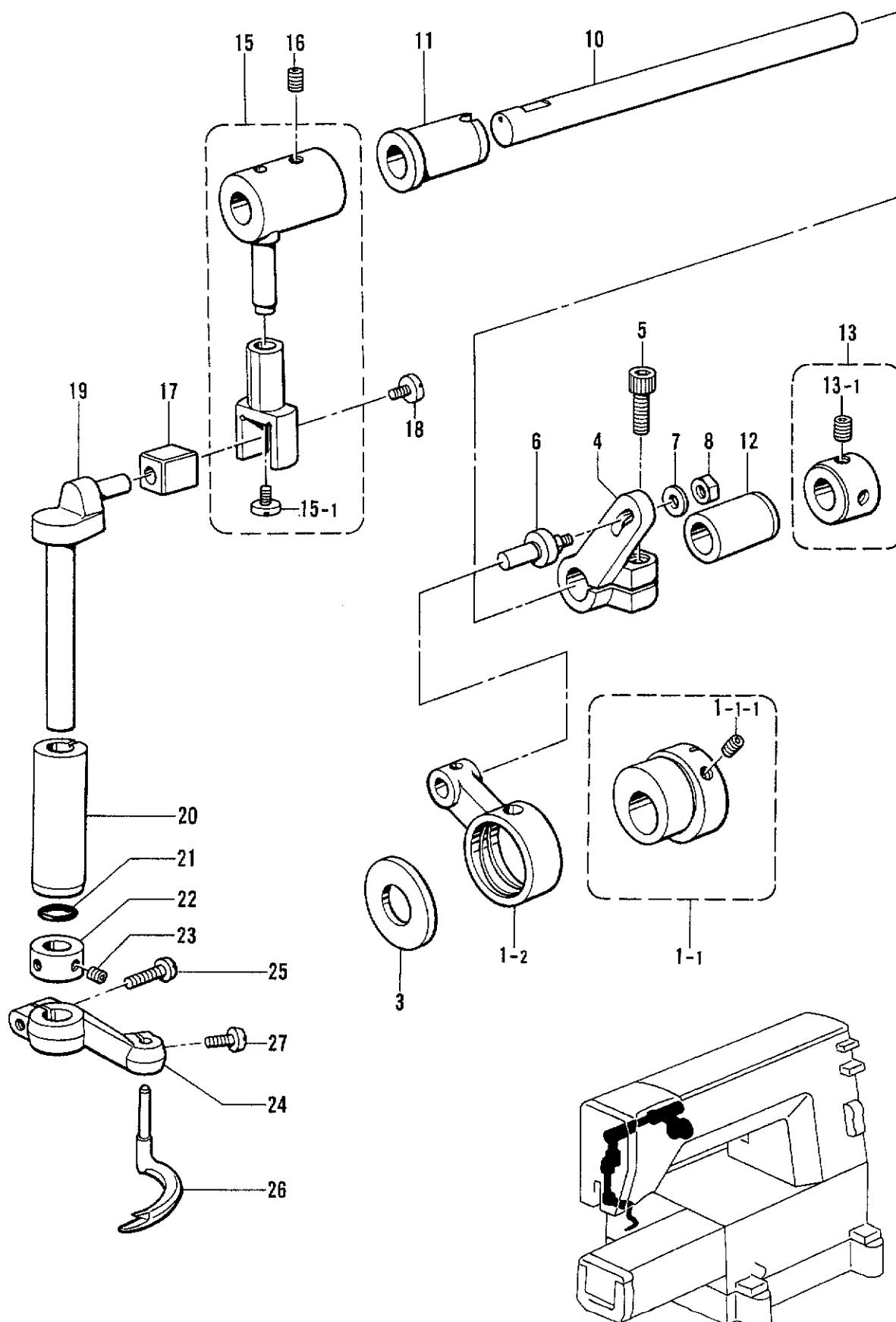
J. スプレーダー関係/Spreader mechanism/Spreizvorrichtung
