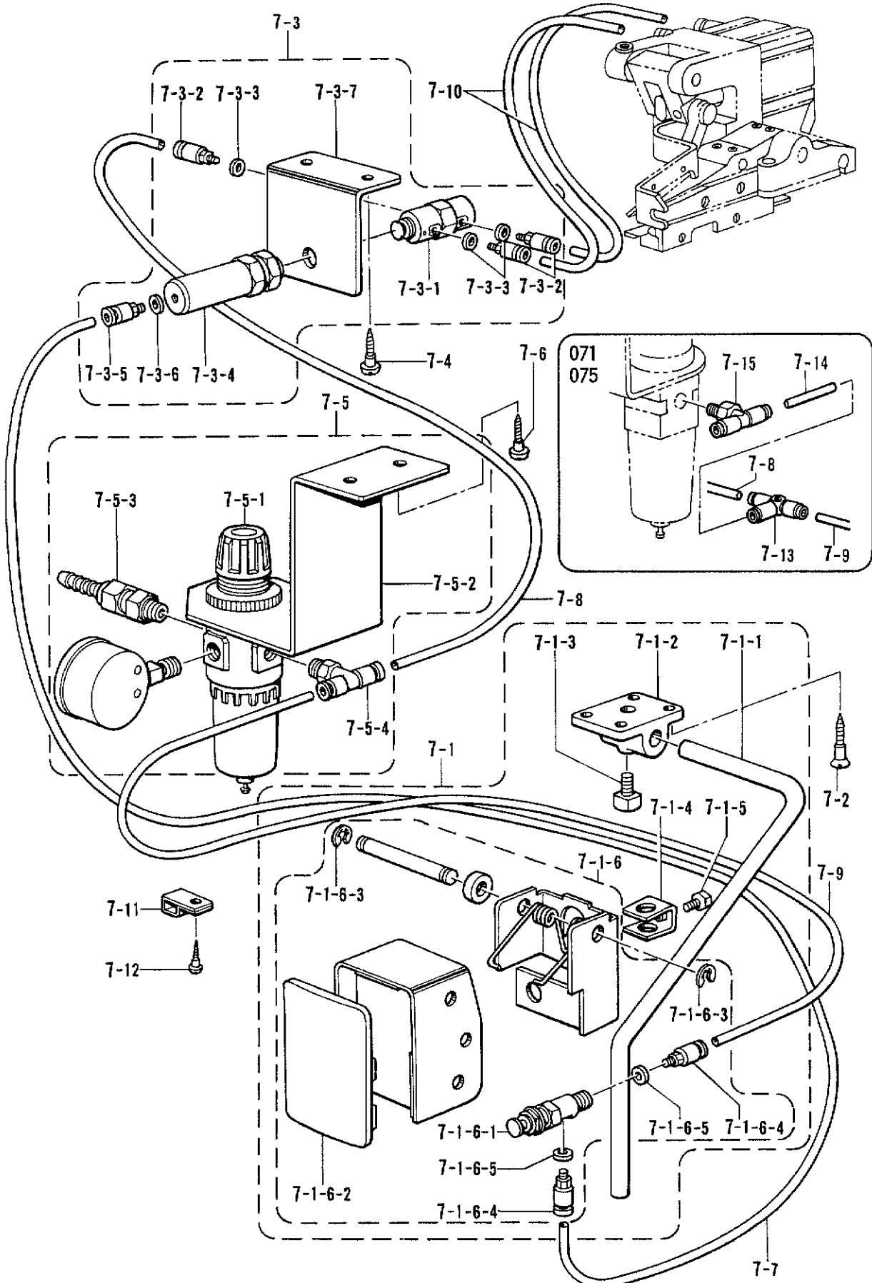
Q7. エアー式テープカッター装置関係 / Air type tape cutter mechanism / Druckluftbetätigte Bandabschneidereinheit / Mécanisme coupe-ruban de type à air / Mecanismo cortador de cintas a aire
