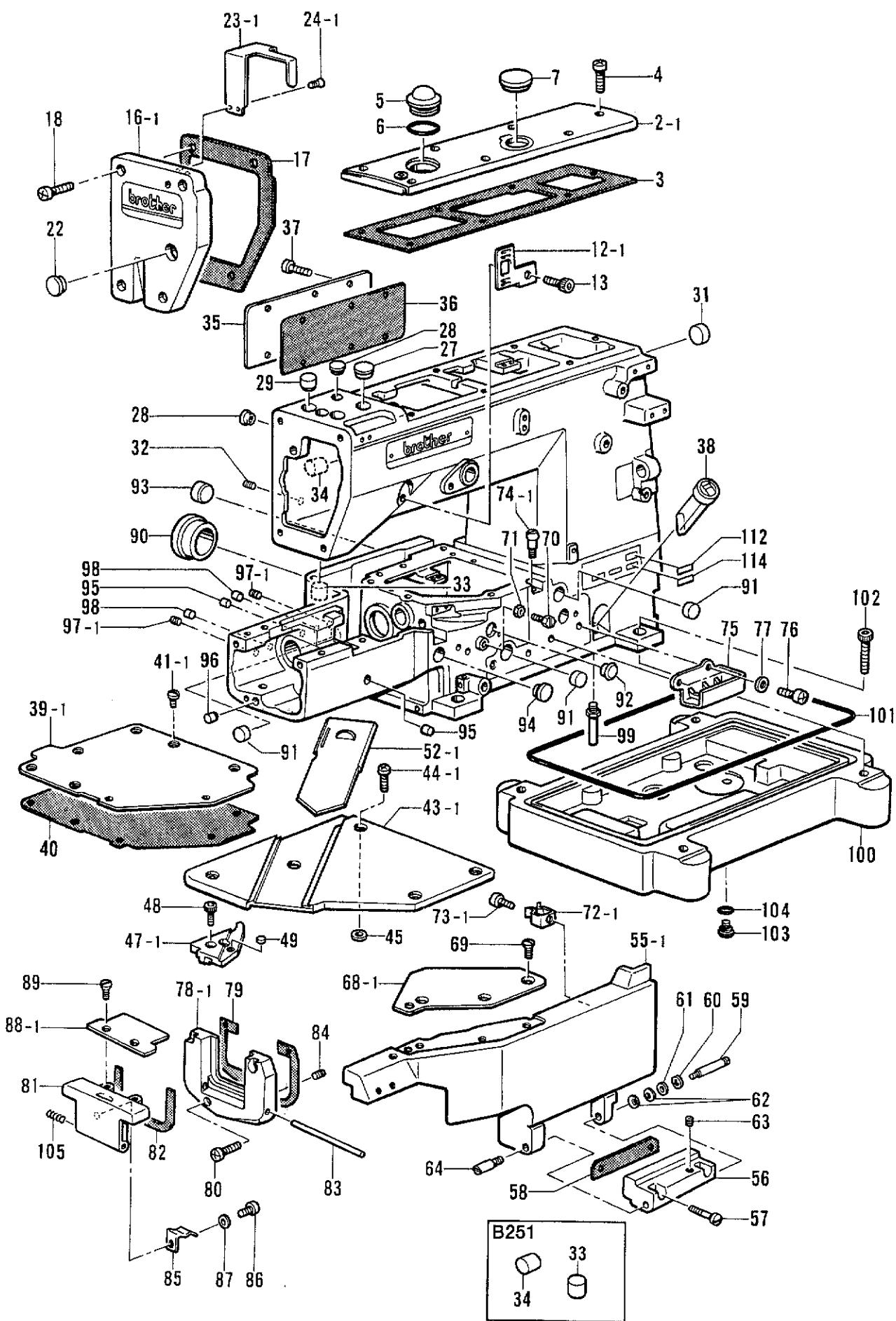
A1. 主体関係 /Machine body/Maschinengehäuse/
