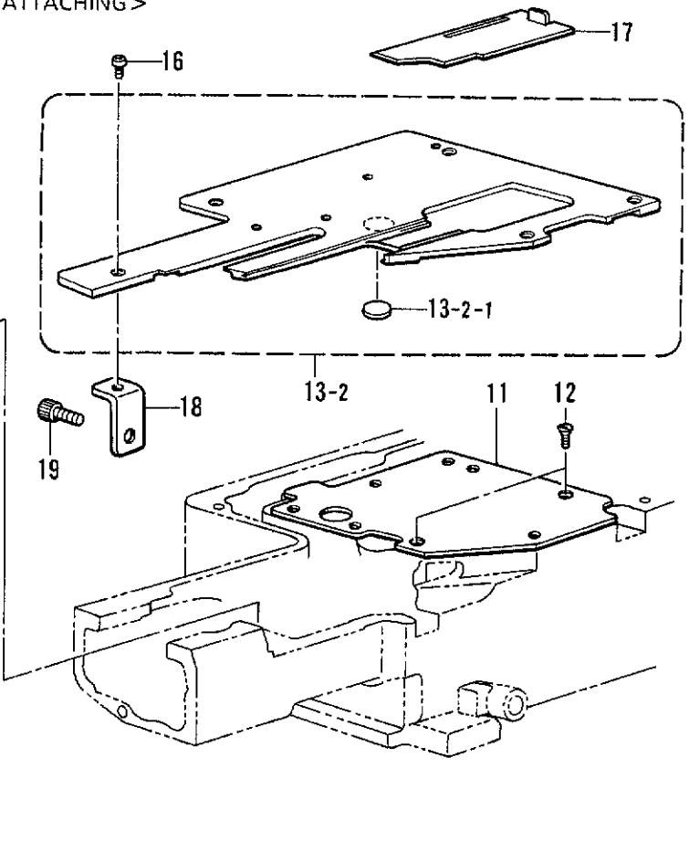
Q4. テープカッター装置関係 / Tape cutter mechanism / Bandabschneidesolenoid /
