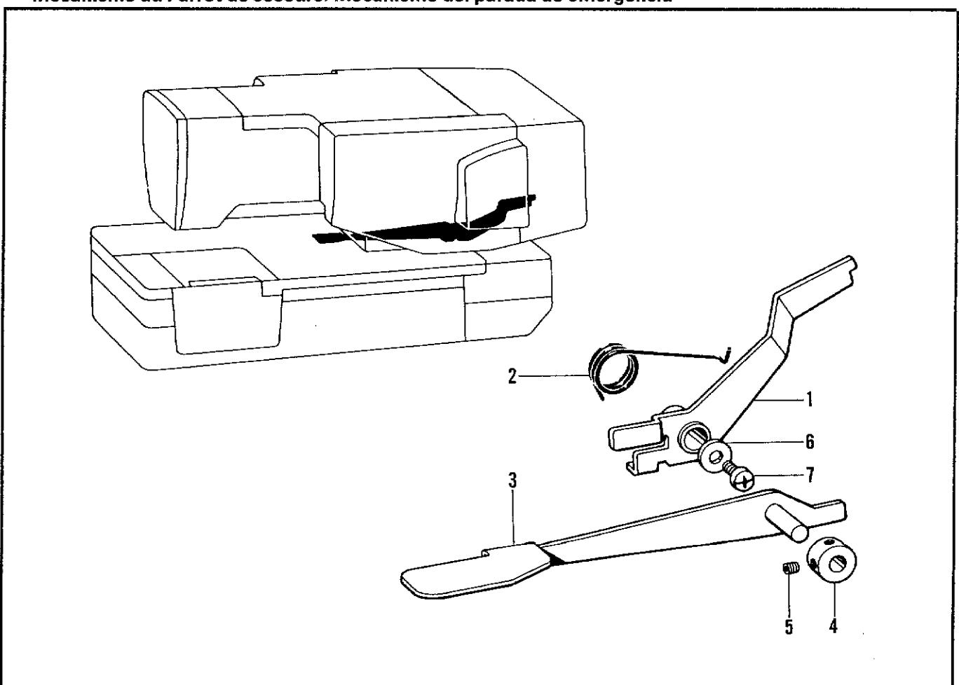
G. ベルト寄せ関係 / Belt shift mechanism / Riemenumstellvorrichtung /
