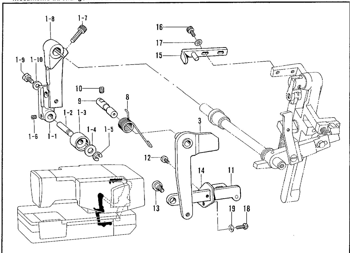
H. 非常停止関係 / Emergency stop mechanism / Abschaltvorrichtung /
