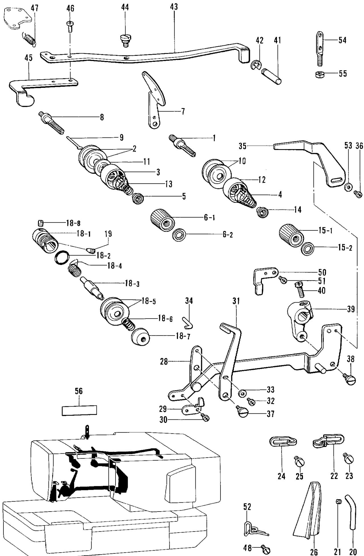
T. 糸通シ関係/Threading mechanism/Fadenführungs vorrichtung/
