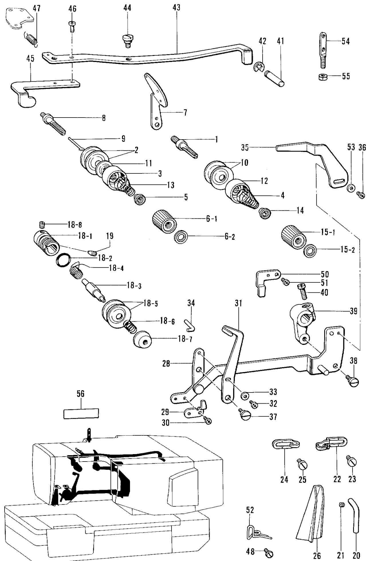
T. 糸通シ関係/Threading mechanism/Fadenführungs vorrichtung/
