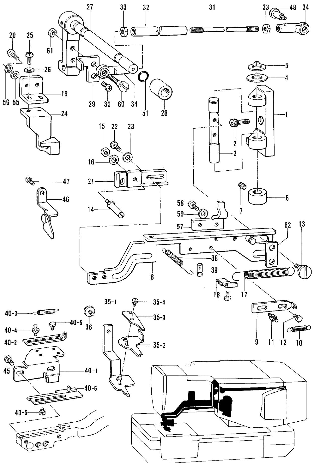
**U. 上糸切り関係/Upper thread trimmer mechanism/Oberer Fadenabschneider/
