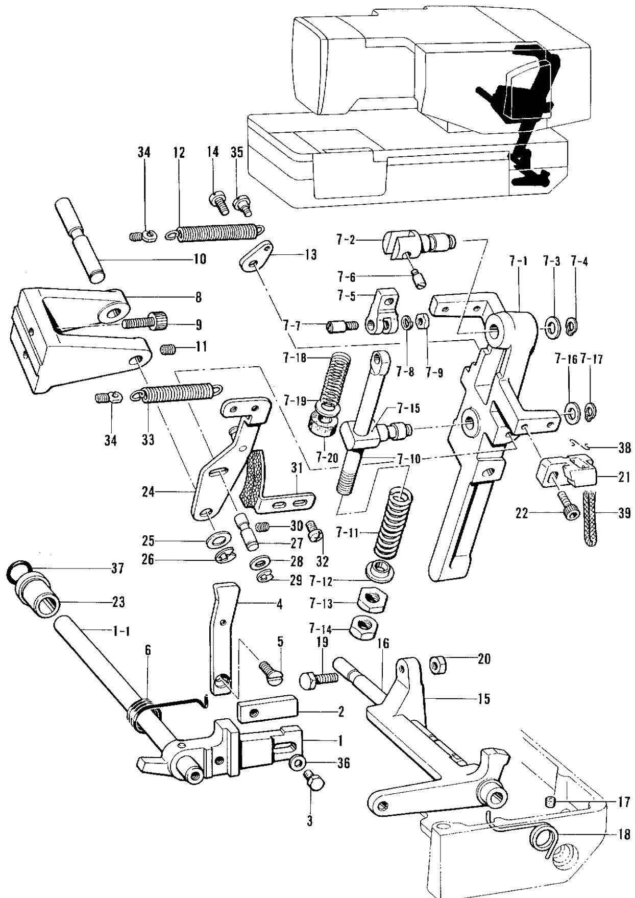
F. 停止関係/Clutch mechanism/Kupplungsvorrichtung/
