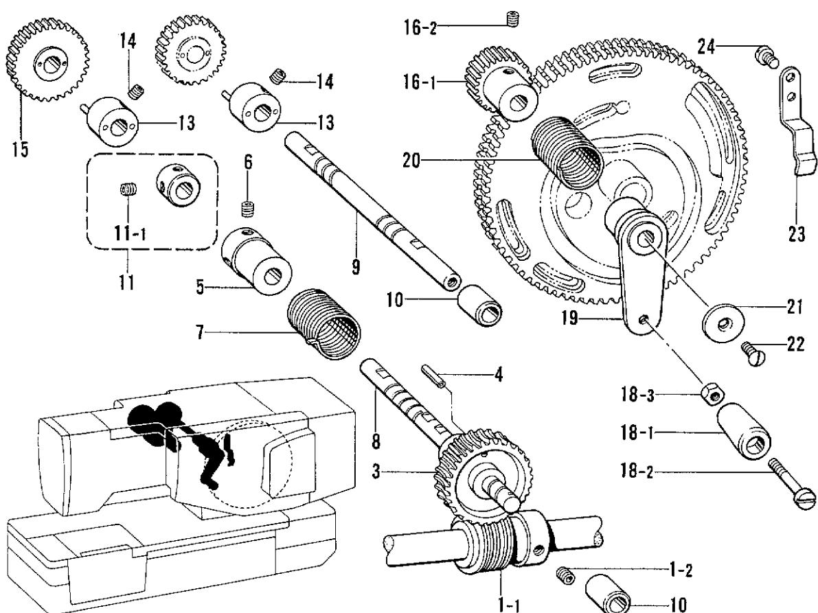
J. テンションプーリ関係 / Tension pulley mechanism / Spannrolle /
