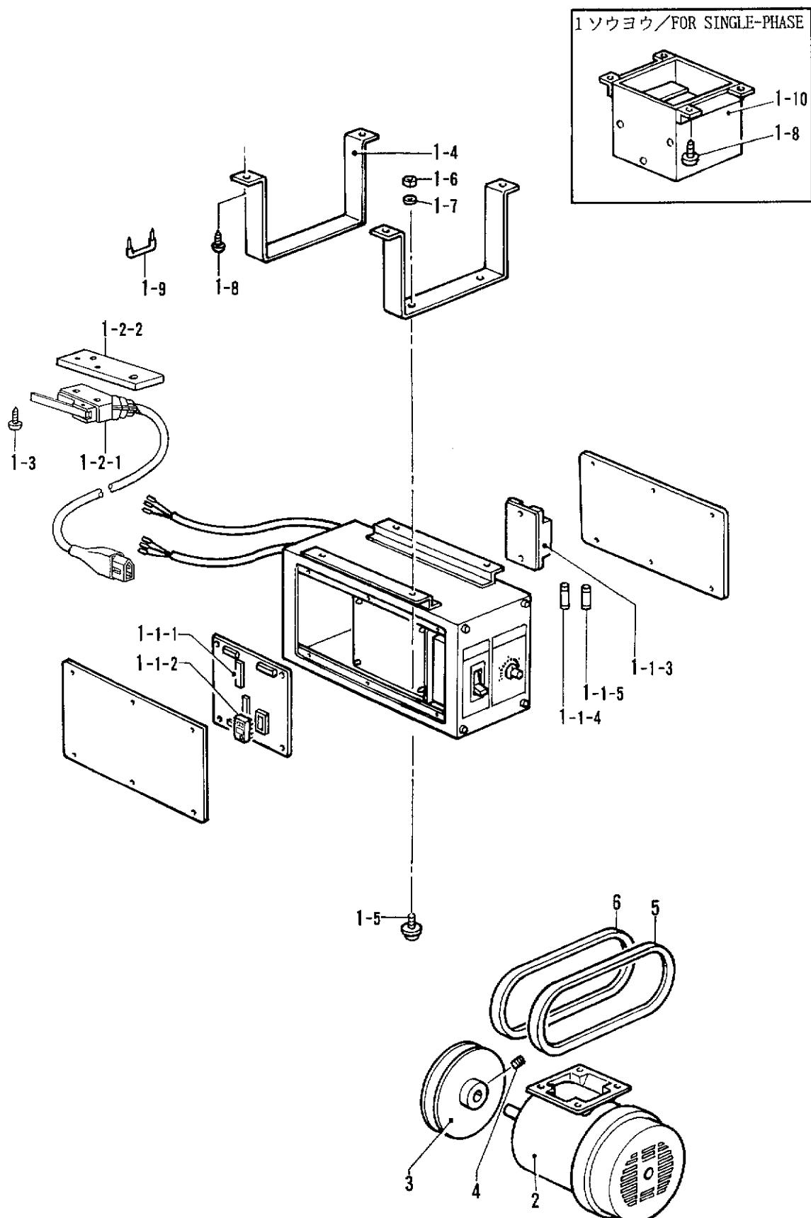
Y. 可変速モータ装置 /Variable speed motor device/Motoreinheit für variable drehzahl/
