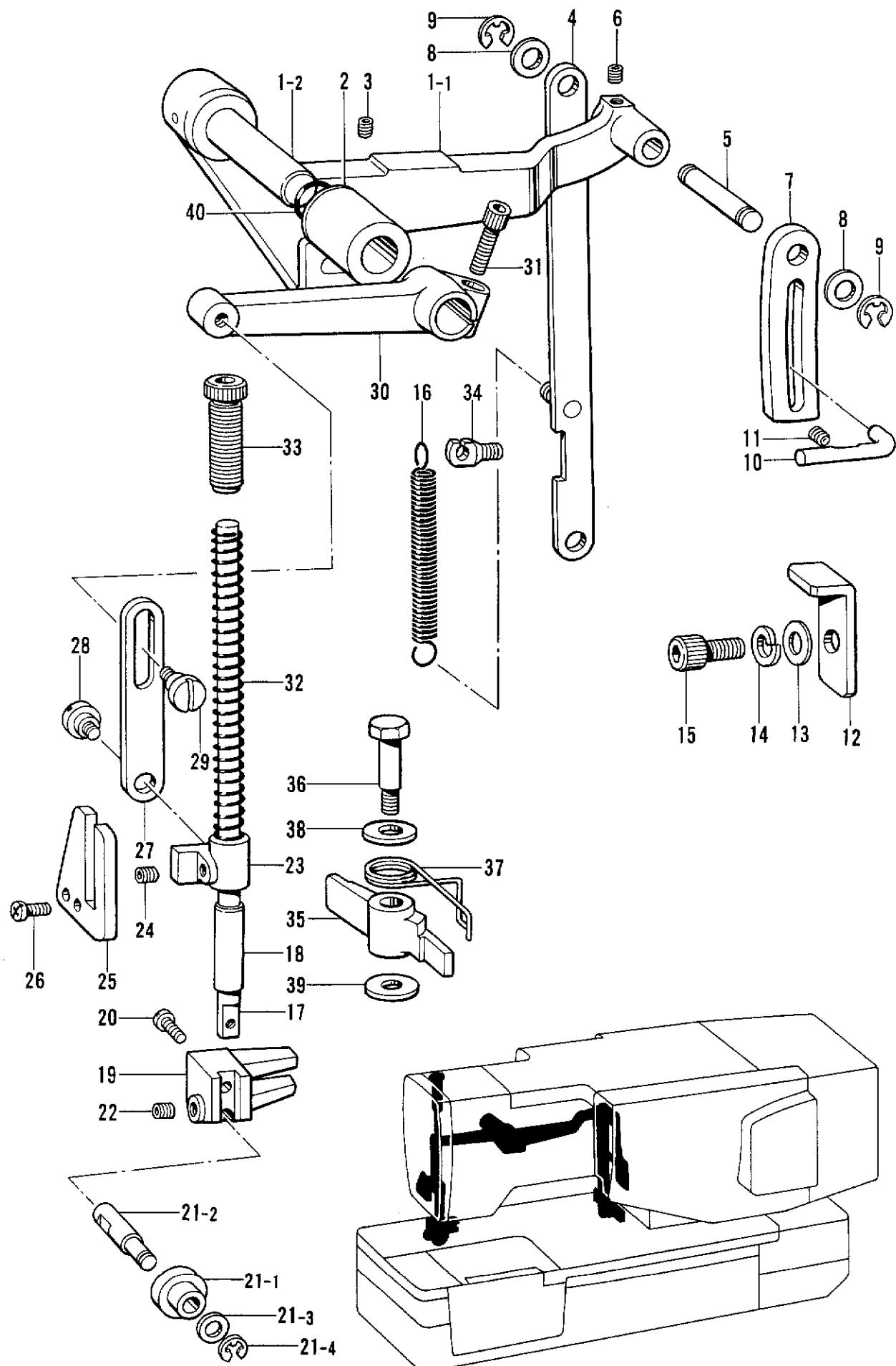
L. 押工関係/Presser foot mechanism/Stoffdrückerfuß/
