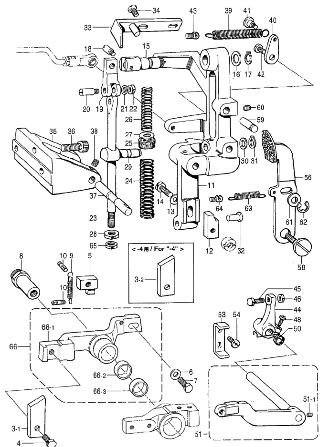
E . 停止関係 / Clutch mechanism
