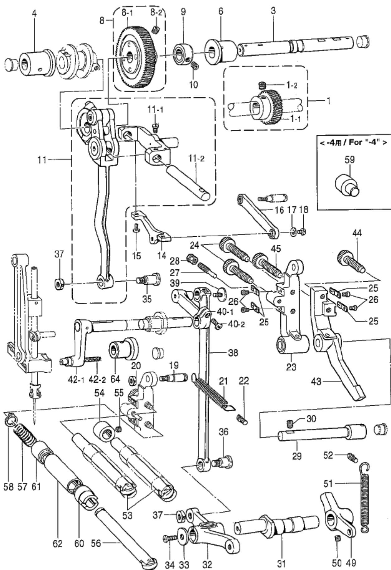
D . 針振関係 / Zigzag mechanism
