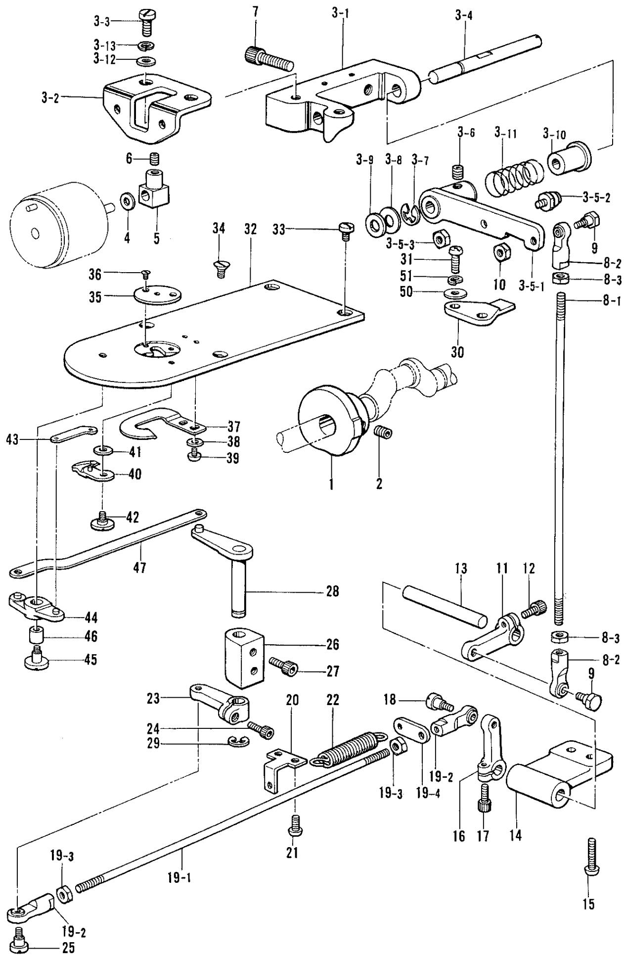
L. 糸切り関係/Thread trimmer mechanism/Fadenabschneidevorrichtung/
