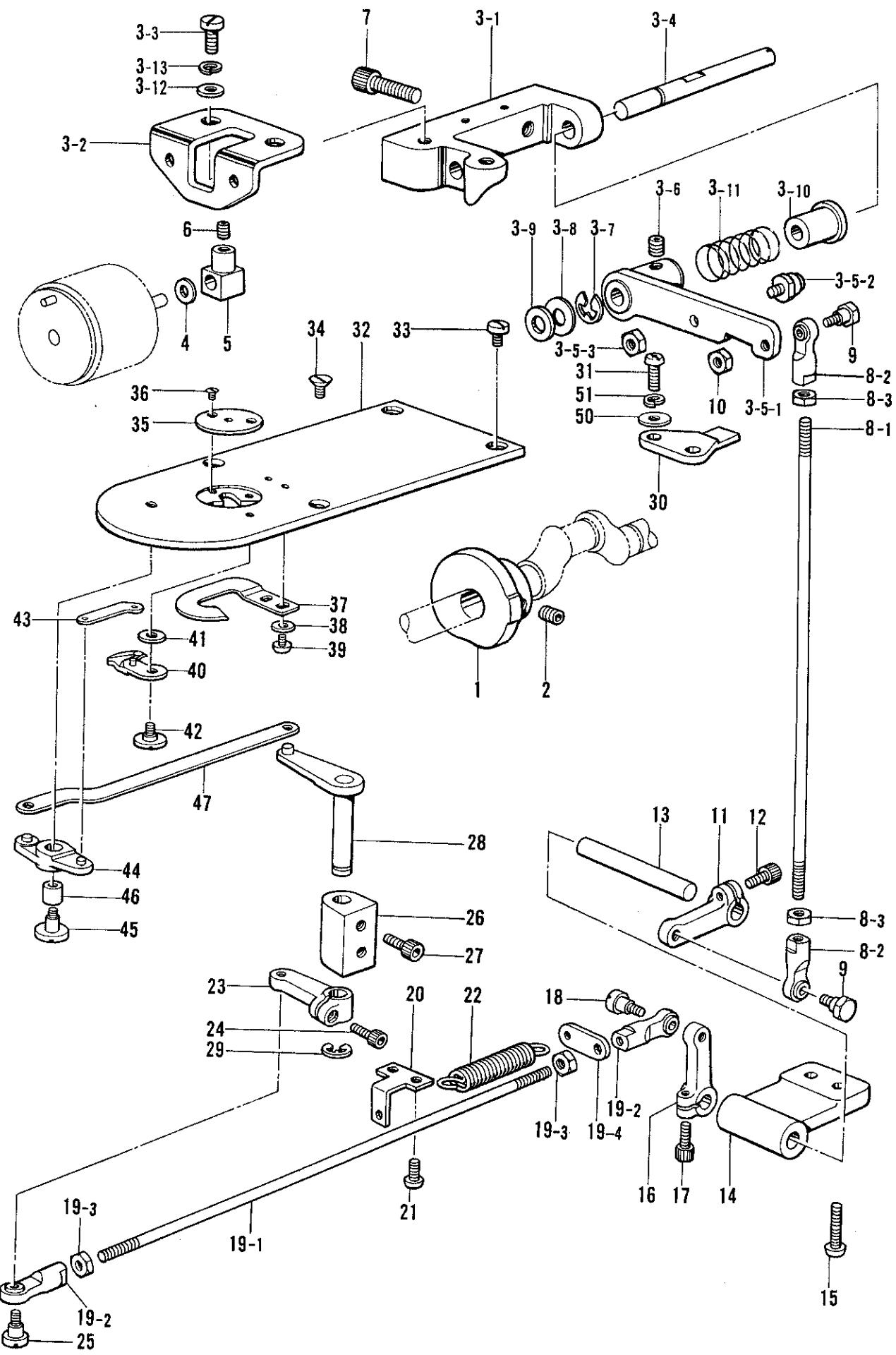
L. 糸切り関係/Thread trimmer mechanism/Fadenabschneidevorrichtung/
