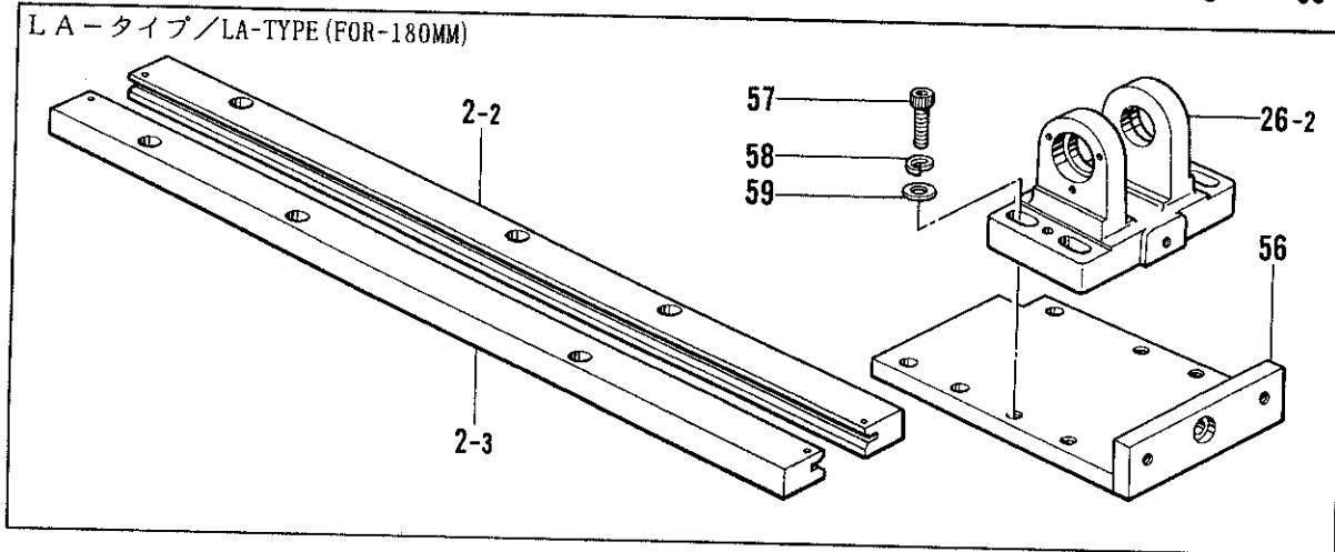
F. 駆動側・送り関係 / Feed guide mechanism / Transportführung /
