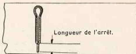
Pour régler la longueur de la boutonnière desserrer la vis (A) et déplacer la règle (B) en avant pour allonger la boutonnière, en arrière pour la raccourcir.
