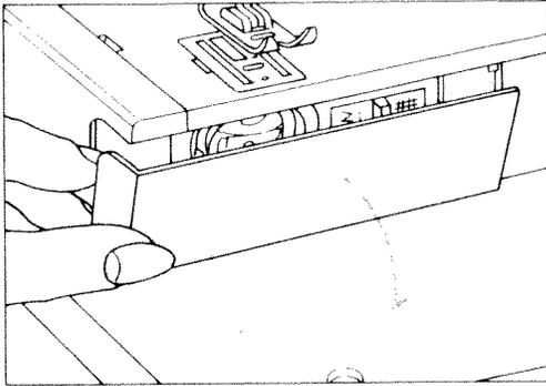
Verschlussklappe 19 nach unten öffnen.
