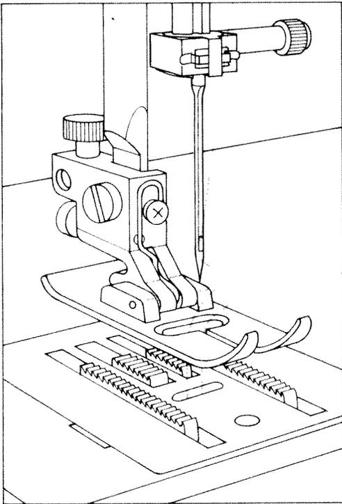
**Unterfaden heraufholen:** Oberfaden festhalten. Handrad nach vorn drehen und einen Stich nähen bis Nadel und Fadengeber wieder oben stehen. Mit dem Oberfaden den Unterfaden nach oben ziehen.
