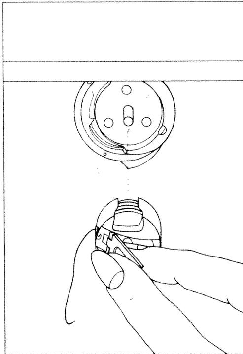
**Spulenkapsel einsetzen:** ● *Hauptschalter 8 ausschalten.* Klappe Q anheben und die Kapsel bis zum Anschlag auf Stift R schieben. Ausschnitt S muß dabei nach oben zeigen.
