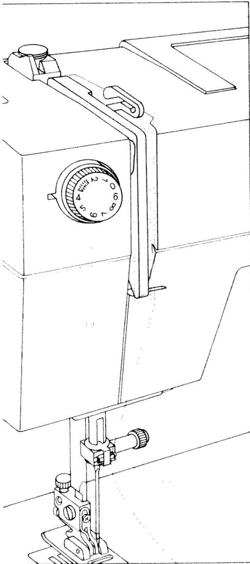
**Oberfaden einlegen:** ● *Hauptschalter 8 ausschalten.* Nadel und Fadenhebel müssen oben stehen. Nähfuß anheben. Den Faden von der Garnrolle in die Spulervorspannung 2, durch die Öffnung P, den Schlitz Q, hinter das Führungsstück R, nach oben in den Schlitz S, in den Fadenhebel 1, zurück durch den Schlitz S, hinter die Führung T und in die rechte Fadenführung U am Nadelhalter ziehen.
