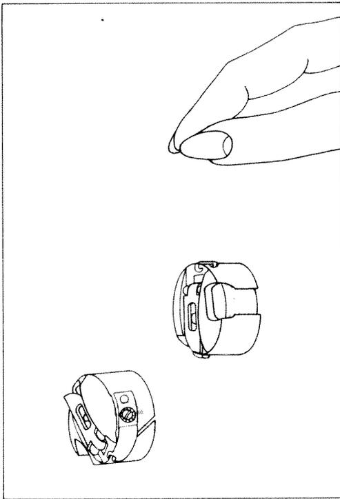
**Unterfadenspannung prüfen:** Kapsel leicht ruckartig aufwärtsbewegen. Sie muß stufenweise niedersinken. (Einstellschraube P nach links drehen = loser, nach rechts drehen = fester).
