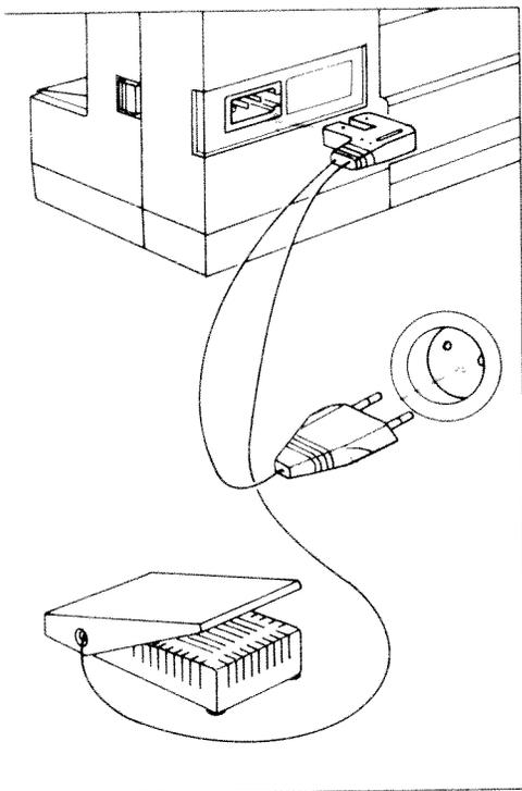
**Elektrischer Anschluß:** Anlasser auf den Boden stellen. Stecker N in die Maschine, und Stecker O in die Wandsteckdose stecken.
