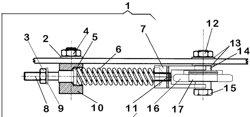
Durch Lösen der Mutter (12) spannt sich die Kette automatisch.
