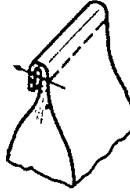
**GB(S)29915G / FB(S)29915A** Kombinierte Sackzuführ-, Beschneide- und Umfalteinrichtung. Zuführgeschwindigkeit 11-23 m/min. bei 50 Hz. Getriebemotor I = 30:1. Eignungsversuch des Sackmaterials erforderlich. Der Papier- oder HDPE-Foliensack wird an seiner Oberkante ca. 20 mm (max. 50 mm) beschnitten, ca. 30-40 mm nach hinten umgeschlagen und der Nähmaschine zugeführt. Geeignet für Nähmaschinen der Typen BC111P12-1M, -1A, -1B.
