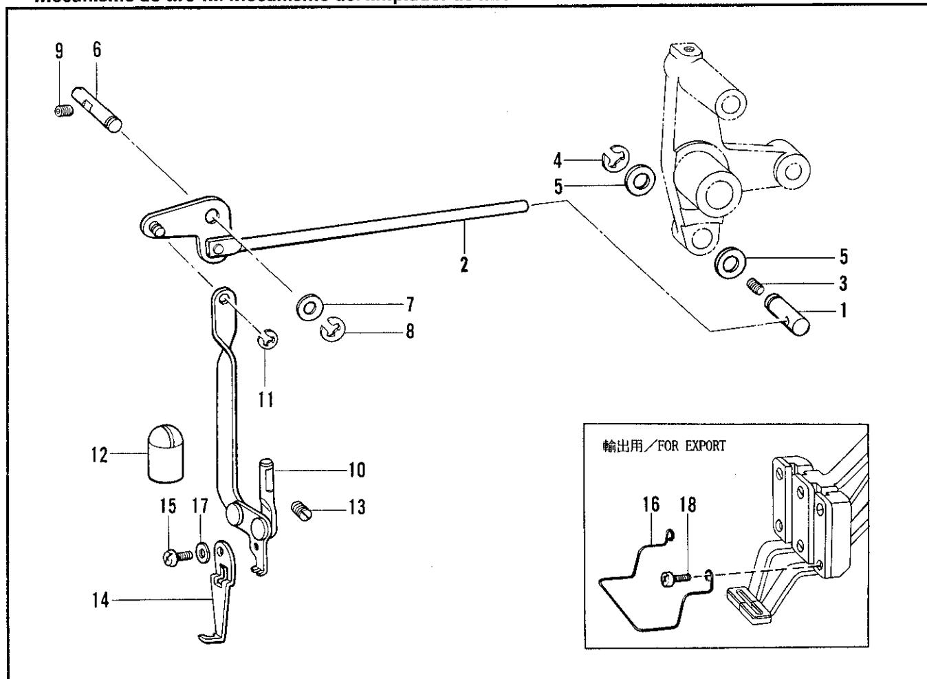
R. 糸締×関係 / Thread nipper mechanism / Fadenspannvorrichtung /
