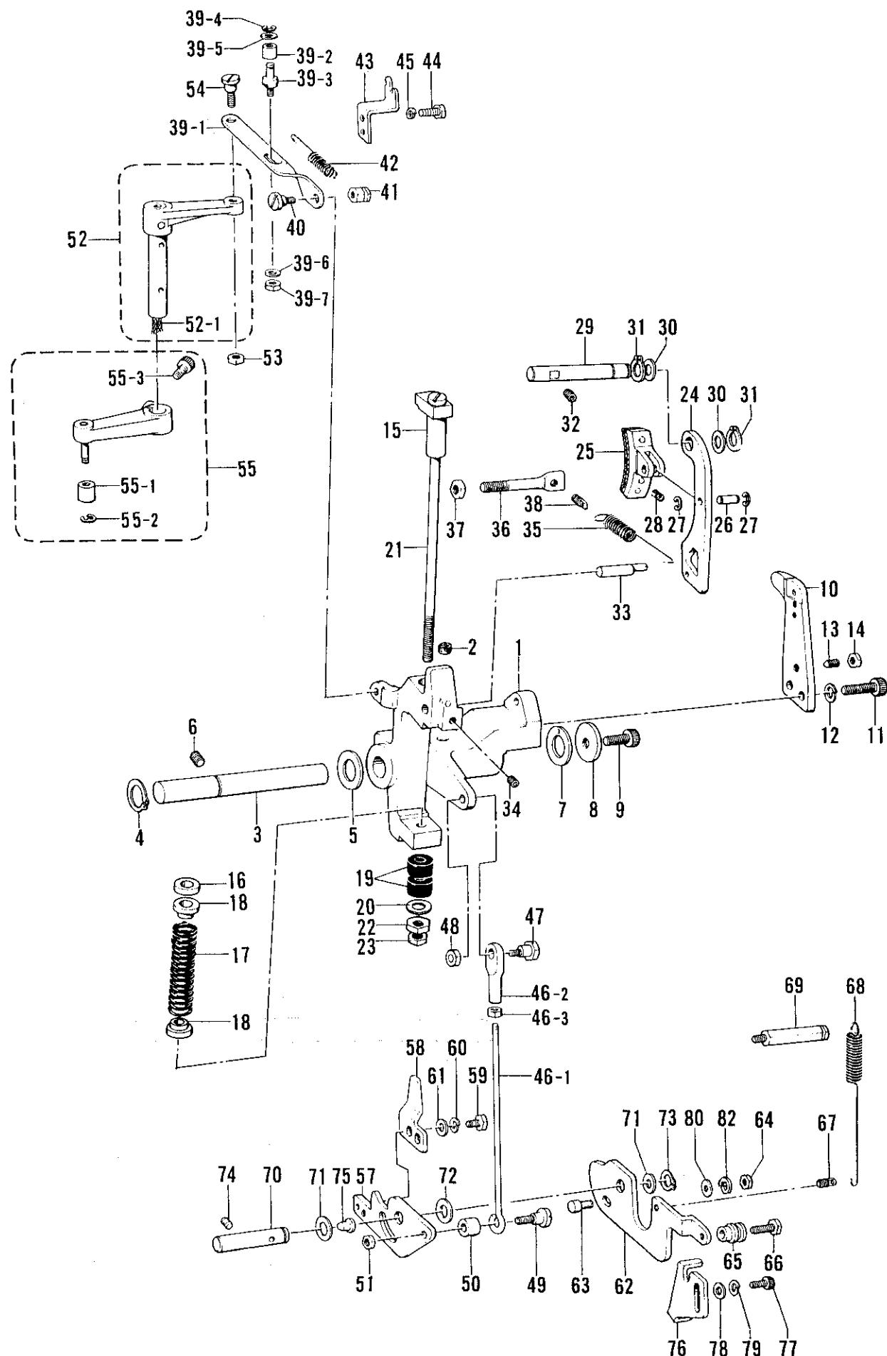
B. クラッチ関係/ Clutch mechanism/ Kupplungsvorrichtung/
