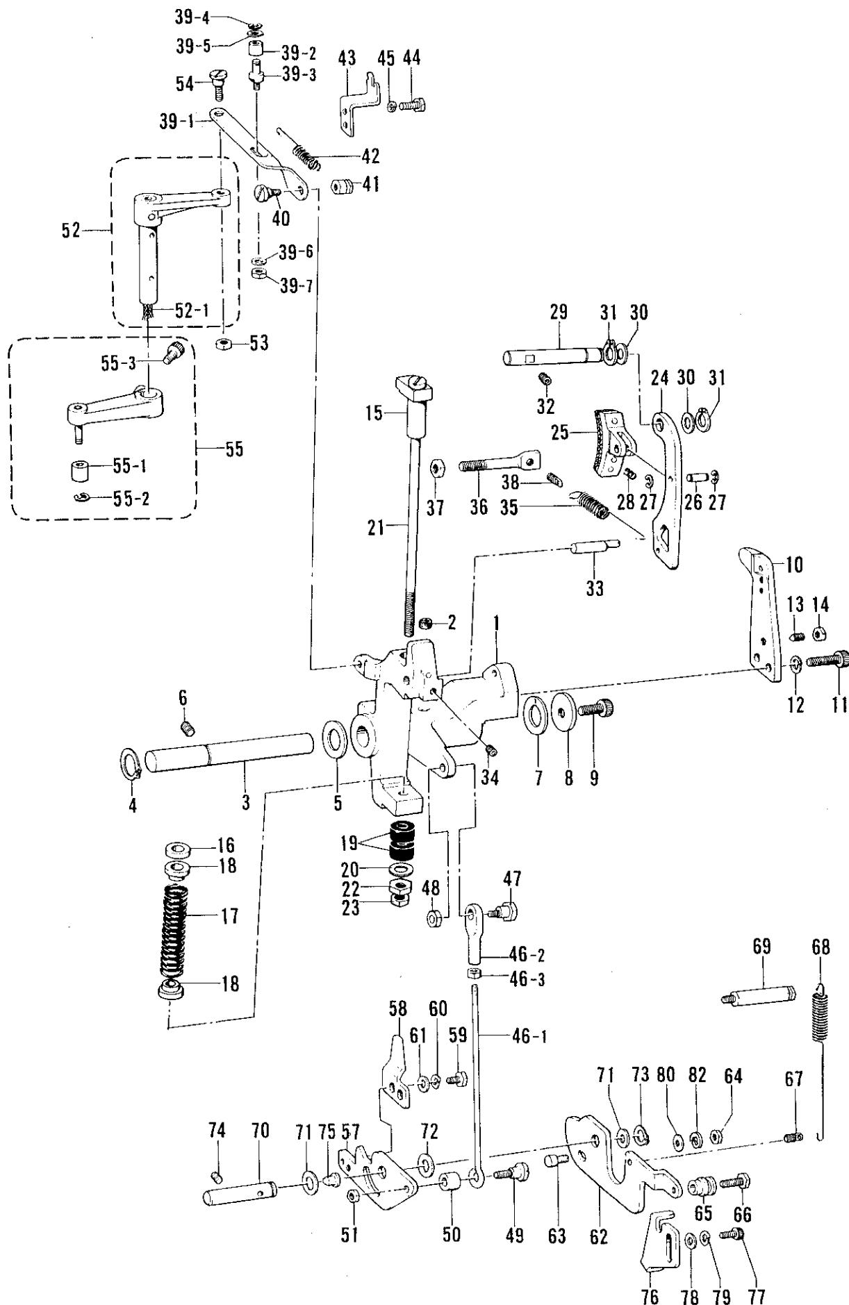
B. クラッチ関係/Clutch mechanism/Kupplungsvorrichtung/
