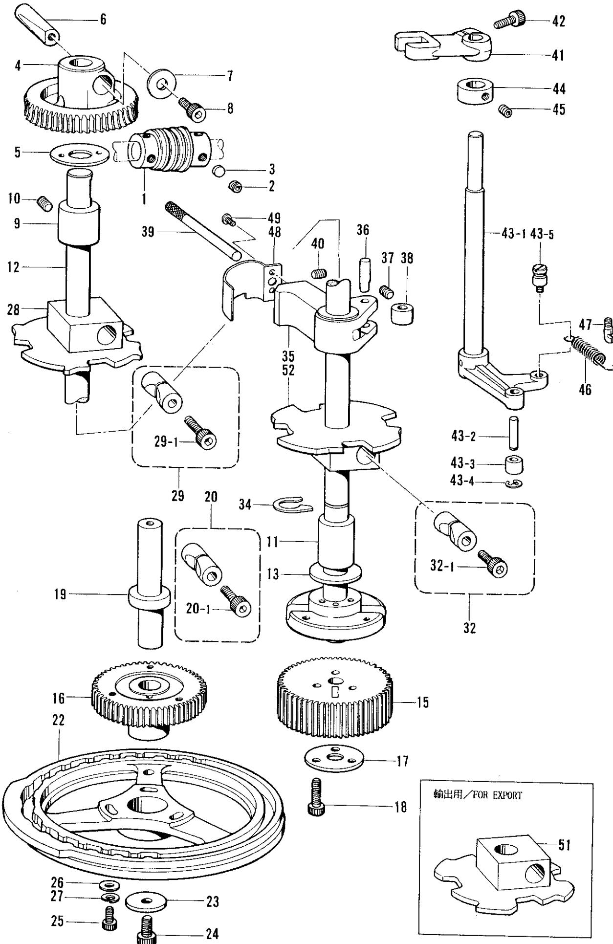
H. カム伝導関係 / Vertical shaft mechanism / Vertikale Welle /
