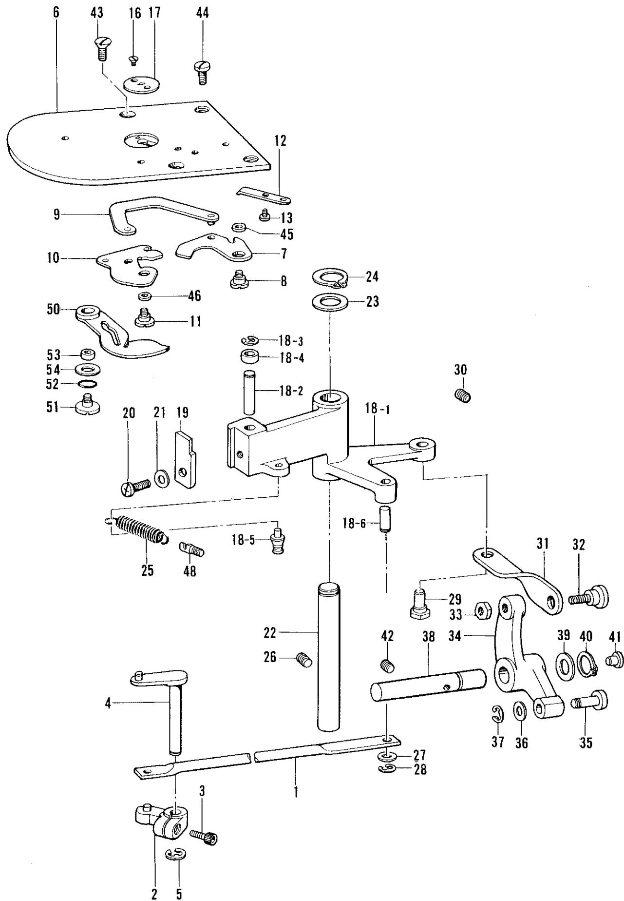
P. 糸切り関係/Thread trimmer mechanism/Fadenabschneidevorrichtung/
