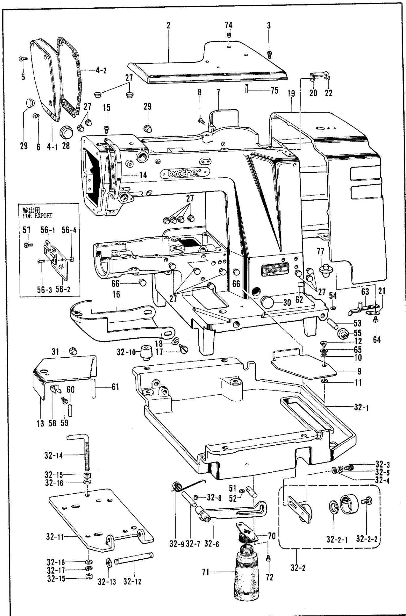
A. 主体関係 / Machine body / Maschinengehäuse / Corps de la machine / Cuerpo de la máquina
