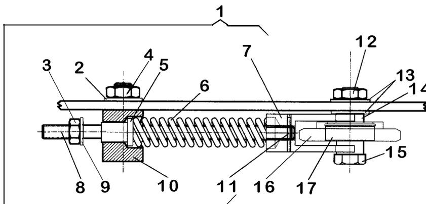
Durch Lösen der Mutter (12) spannt sich die Kette automatisch. Durch anschließendes Festziehen der Mutter ist die Sackzuführeinrichtung wieder einsatzbereit.
