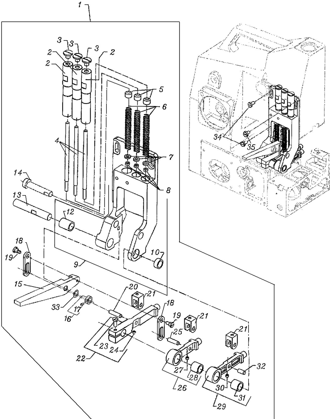
**PRESSER FOOT LIFTER BM111C1, C1H, C2, BML111C1, C1H, C2**
