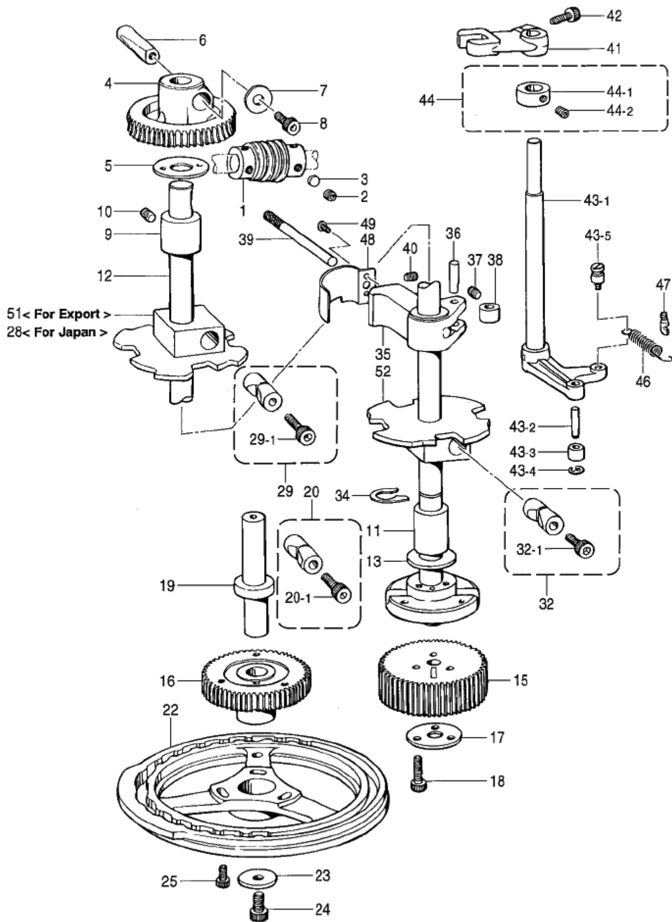
H. カム伝導関係 / Vertical shaft mechanism
