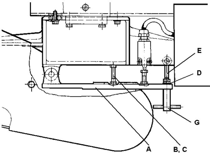
**BEACHTEN SIE:** Die Grundplatte A der Säule 20600 muß gleichmäßig an den beiden Schrauben B und C, sowie mit geringer Spannung an der Bundmutter D der Augenschraube E anliegen. Richten Sie die Nähmaschine zuerst mit der Schraube B parallel zur Vorschubrichtung F aus. Stellen Sie danach die Schraube C dicht zur Grundplatte und die Bundmutter D mit geringem Abstand zur Grundplatte A und kontern Sie die Anschläge. Sichern Sie die Grundplatte mit der Knebelmutter G.
