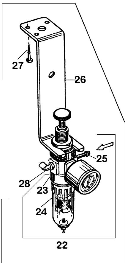
**PNEUMATIC PARTS FOR PRESSER FOOT LIFTER 80700C. CD**
