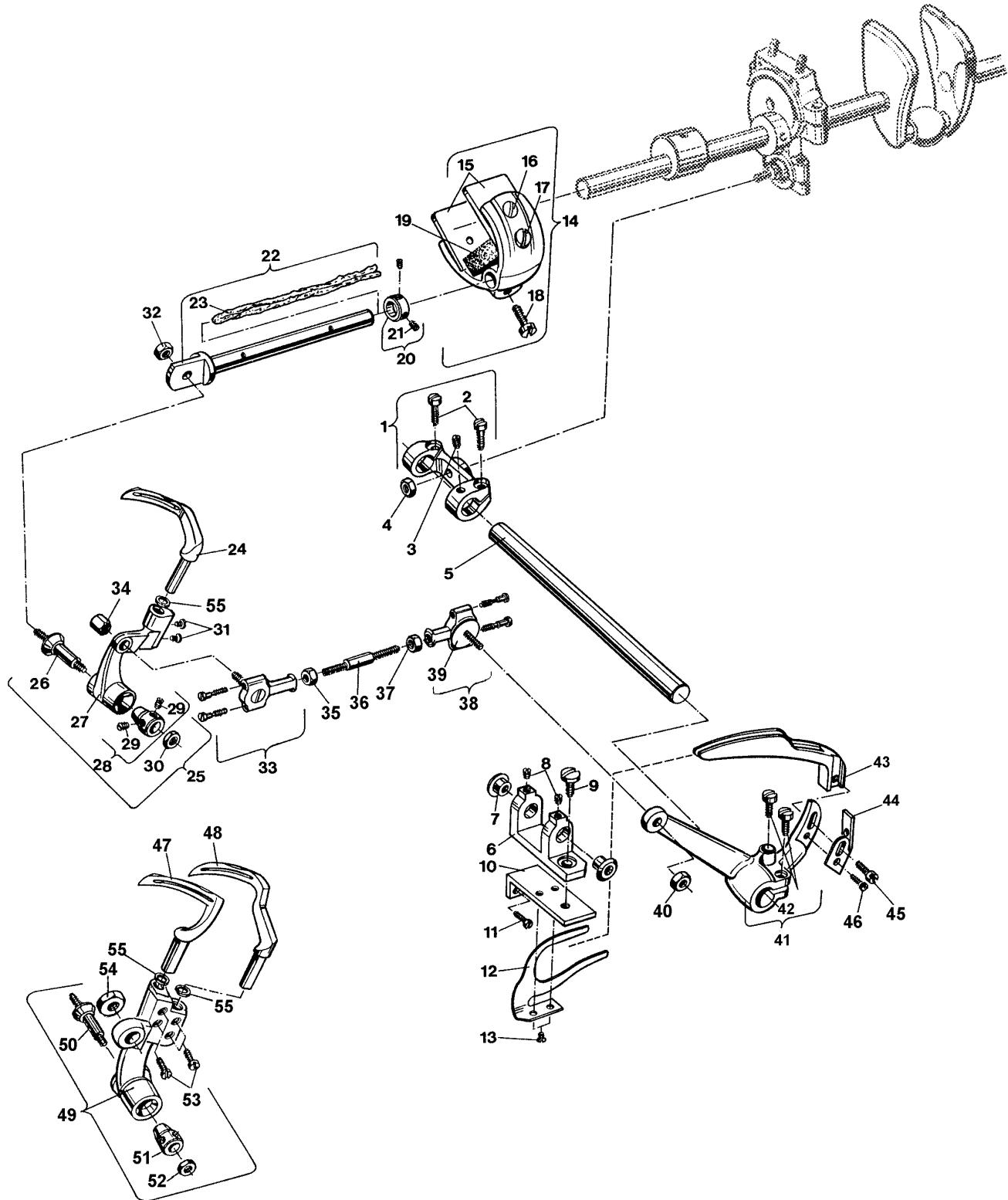
**LOOPER AVOID ECCENTRIC FORK, LOOPER LEVER AND ROCKER, LOOPER THREAD CAST-OFF**
