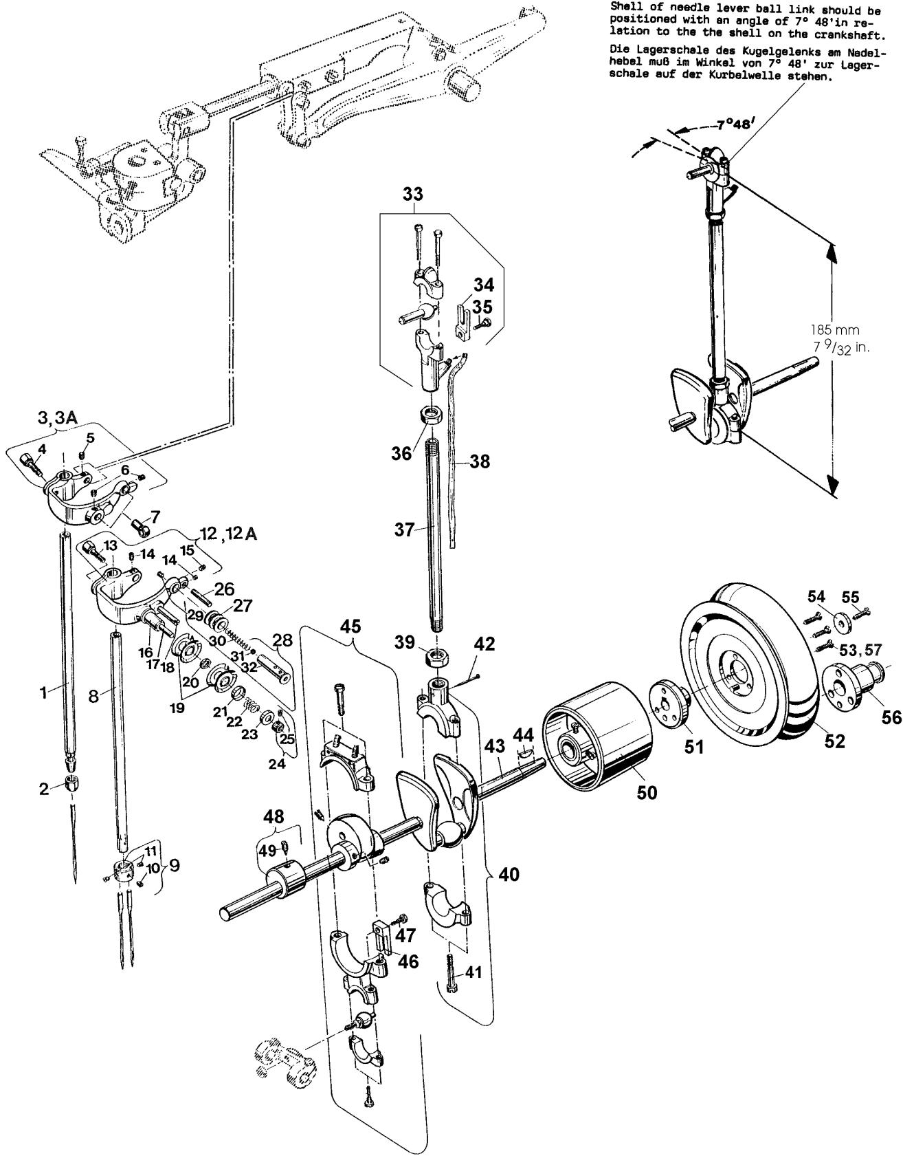
**NEEDLE BAR, NEEDLE LEVER LINK, CRANK SHAFT, PULLEY, LOOPER DRIVE AND LOOPER AVOID ECCENTRIC**
