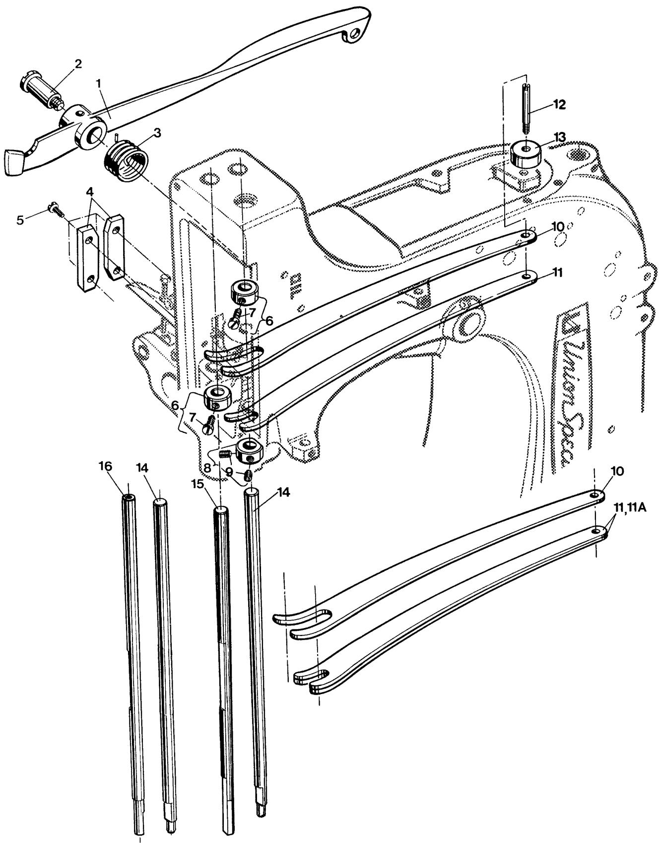
**PRESSER BAR, PRESSER BAR SPRINGS AND PRESSER FOOT LIFTER LEVER**
