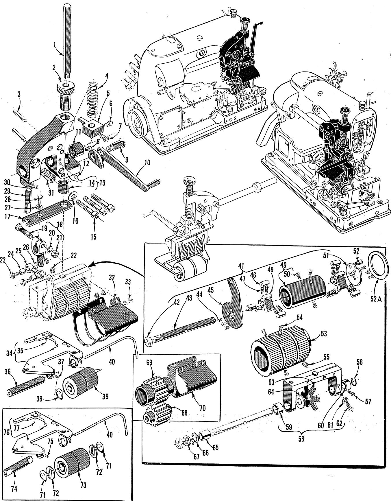
FEED ROLLER AND PULLER CLUTCH PARTS
