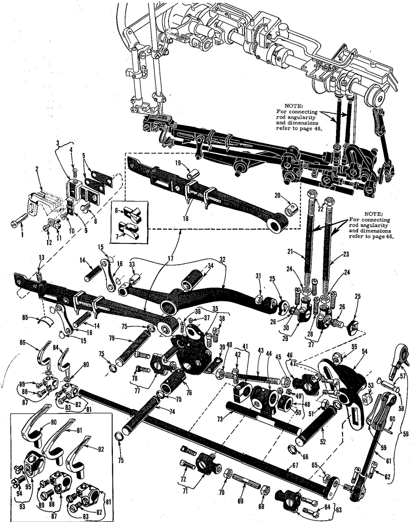
MISCELLANEOUS FEED PARTS, LOOPER DRIVE PARTS AND NEEDLE GUARDS
