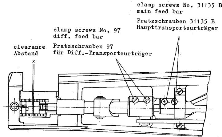
Die Transporteurträger sind nun zugänglich und können nach dem Lösen der Pratzschrauben 31135 B und 97 verstellt werden (siehe Abbildung). Nach erfolgter Einstellung sind die Pratzschrauben wieder gut anzuziehen und der Zylinderdeckel sauber auf die Dichtung aufzusetzen. Sollten die Korkdichtungen und die Gummischnur an den Stirnseiten des Zylinderdeckels beschädigt sein, so sind diese durch neue Dichtungen zu ersetzen.
