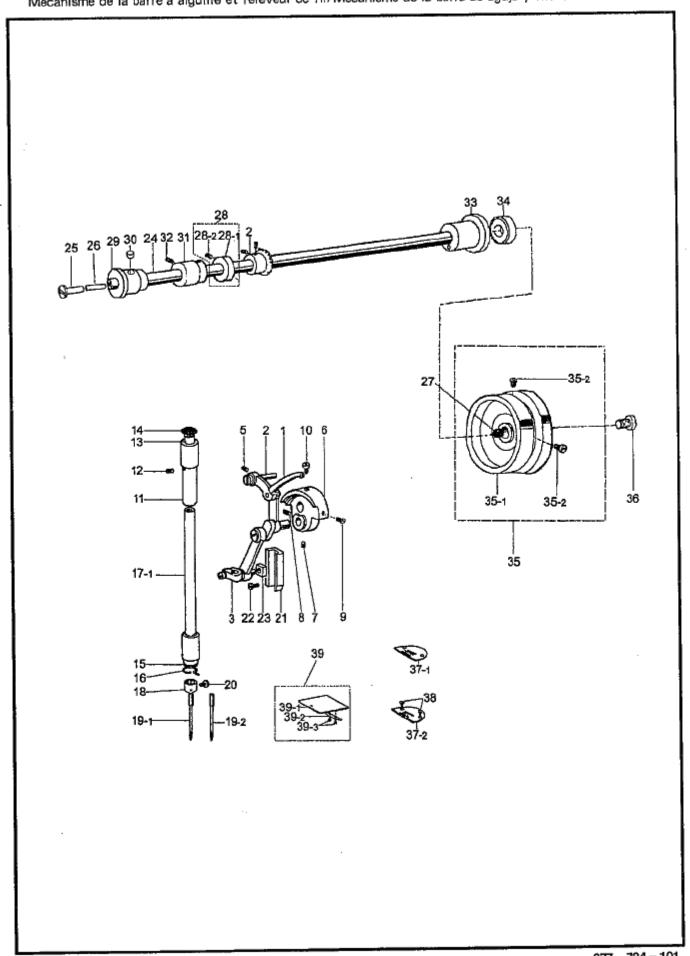
C. 針棒·天秤関係/Needle bar and thread take-up mechanism/Nadelstange und Fadenabnahmevorrichtung/ Mécanisme de la barre à aiguille et releveur de fil/Mecanismo de la barra de aguja y tirahílos
