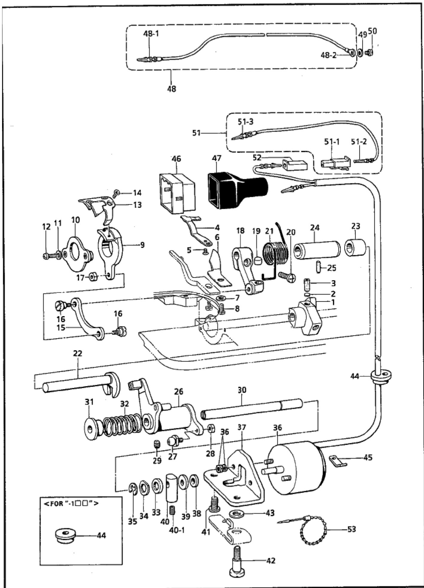
K. 糸切り関係 / Thread trimmer mechanism / Fadenabschneidevorrichtung
