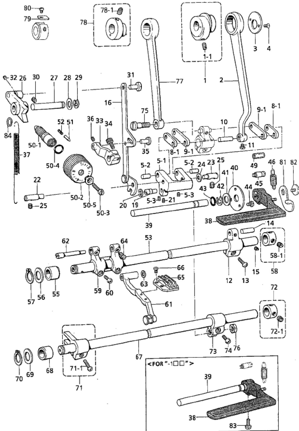
D. 送り関係 / Feed mechanism / Transportvorrichtung / Mécanisme de l'entraînement
