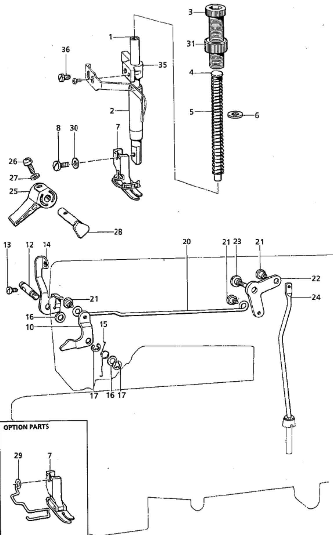
C. 押工関係 / Presser foot mechanism / Stoffdrückerfuß / Mécanisme de pied presseur
