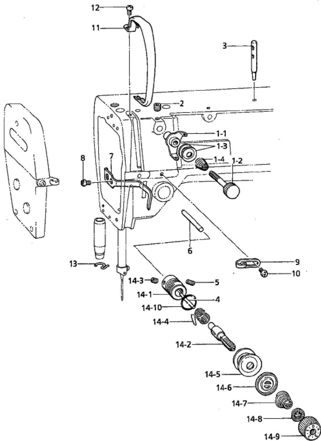
J. 糸通シ関係 / Threading mechanism / Fadenführungs vorrichtung / Mecanisme de filage
