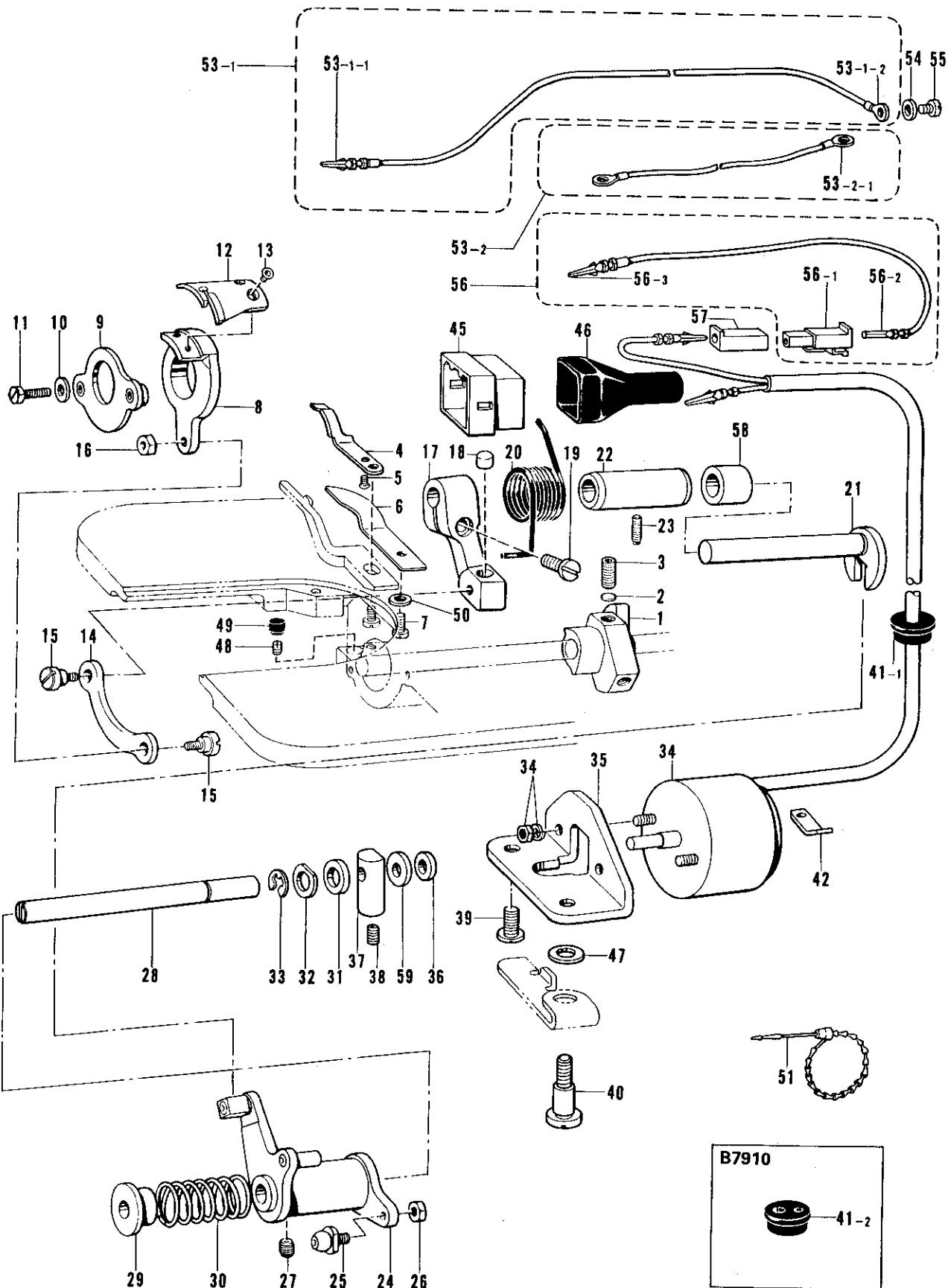
N. 糸切り関係/Thread trimmer mechanism/Fadenabschneidevorrichtung/
