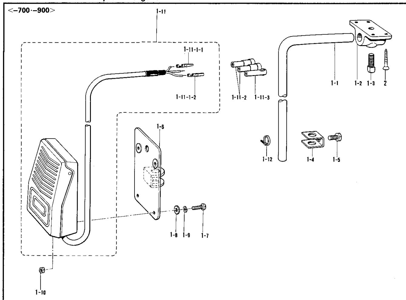
U. 逆転スイッチ関係 / Quick reverse switch mechanism / Umkehrschalter /
