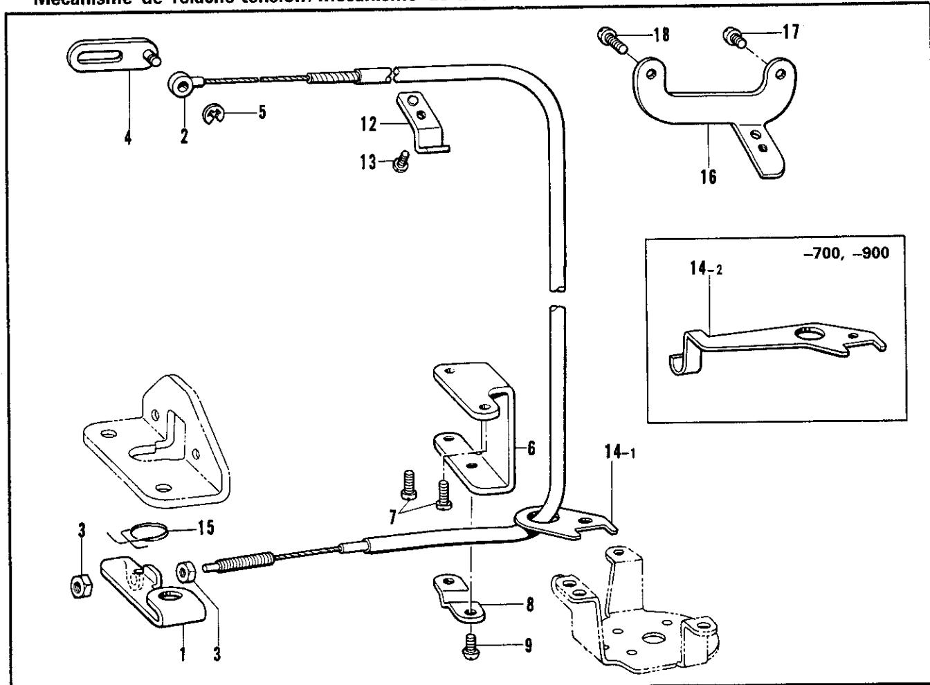
S. コントロールボックス関係 / Control box mechanism / Schaltkasten /
