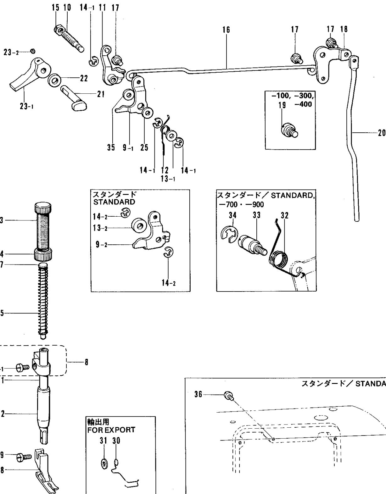
E. 押工関係 / Presser foot mechanism / Stoffdrückerfuß /
