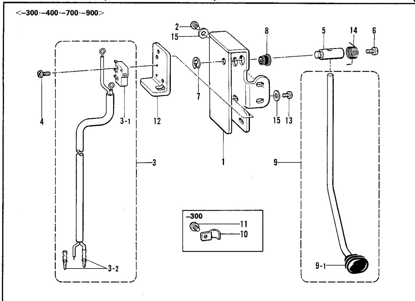
**T. ヒザスイッチ関係 / Knee switch mechanism / Knieschalter /
