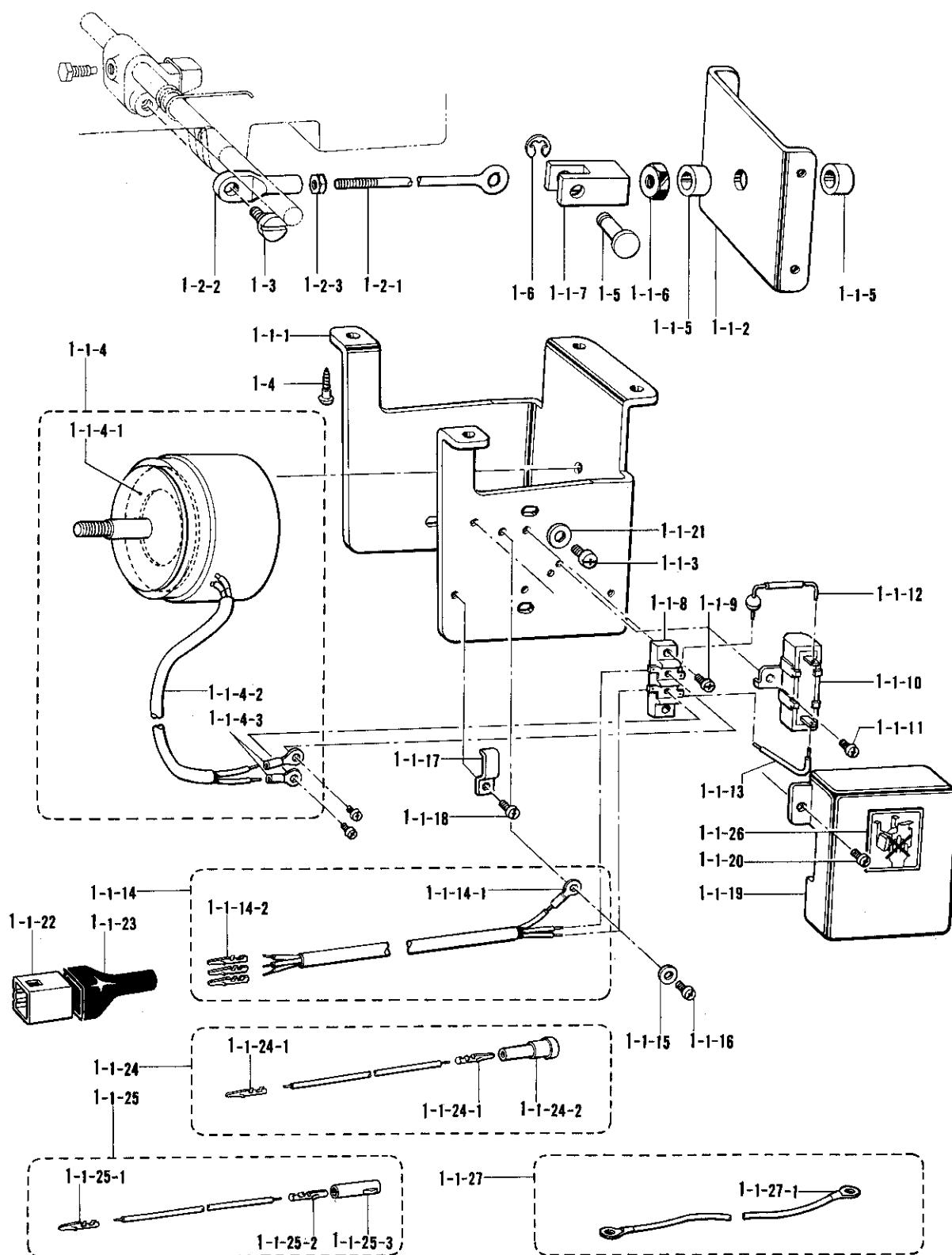
X1. 電磁押工上ヶ関係 / Presser foot lifting solenoid set / Solenoidsatz für die Anhebung de Stoffdrückerfußes /
