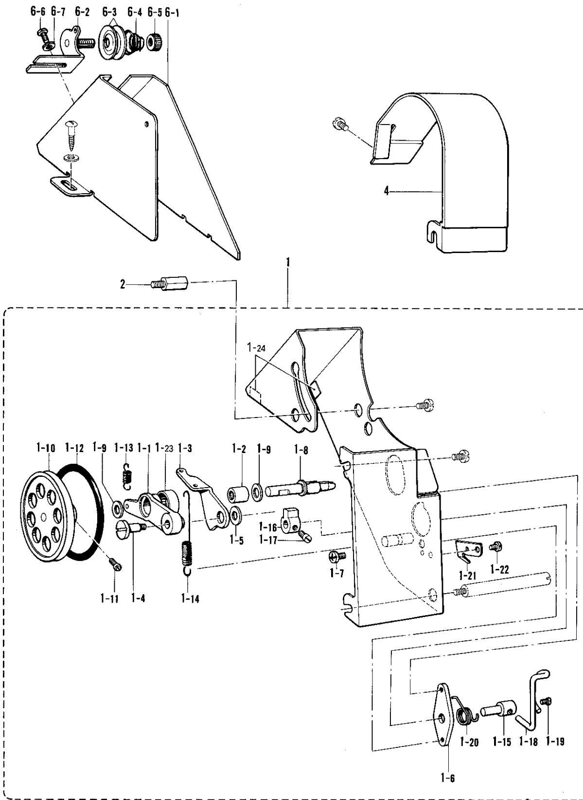
**M. 糸巻き装置関係 / Bobbin winder mechanism / Spuler /
