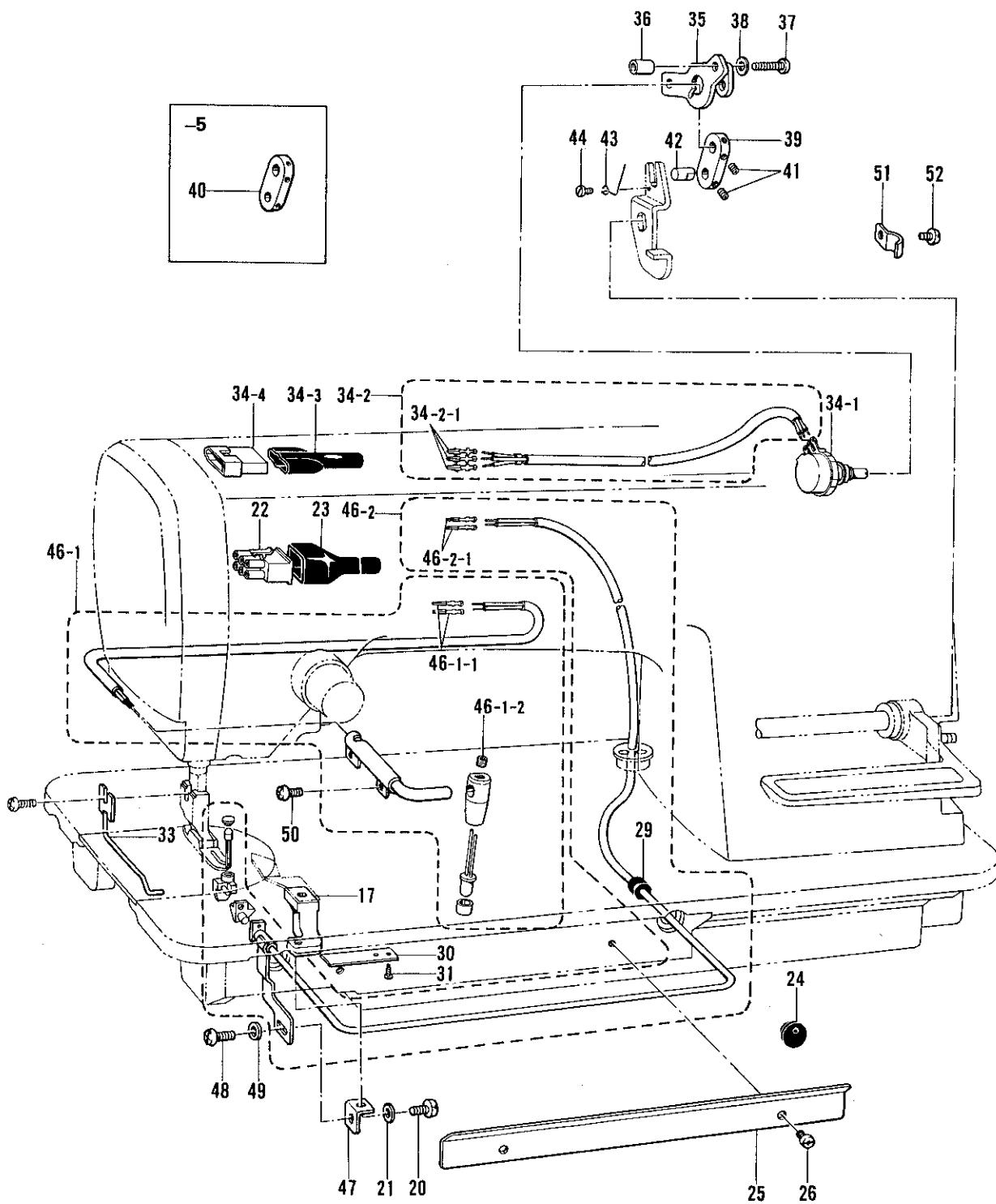
W. 布制御関係 / Cloth control system mechanism / Stoffführungs vorrichtung /
