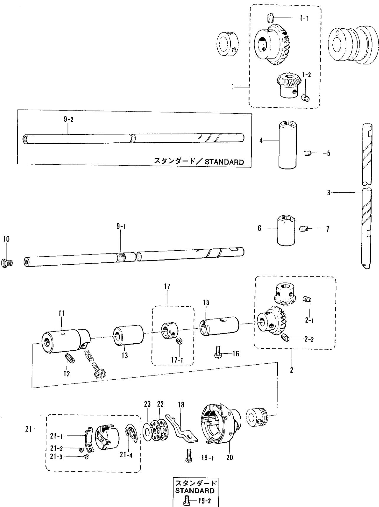
J. カマ関係 / Rotary hook mechanism / Greifervorrichtung /
