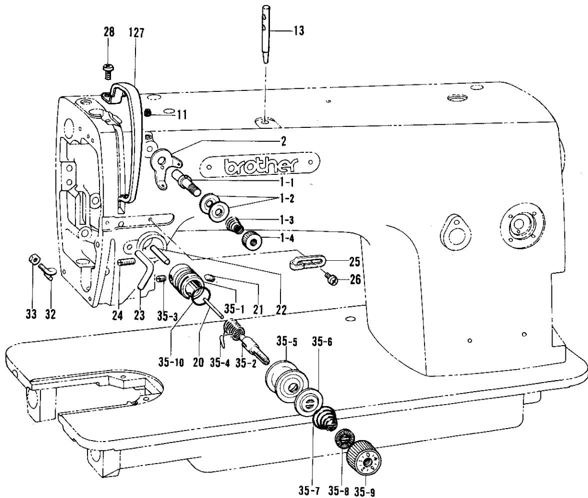
L. 糸通シ関係 / Threading mechanism / Fadenführungs vorrichtung /
