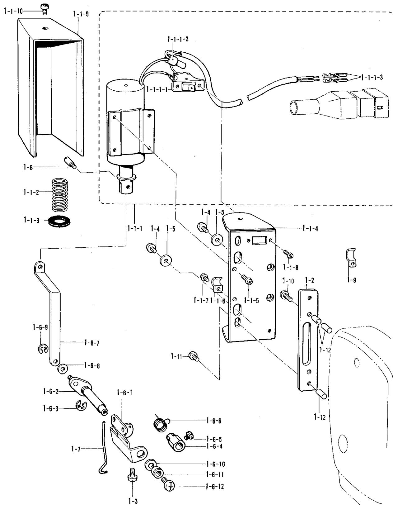
Z. 糸拭イセット / Thread wiper set / Fedenspannvorrichtung /
