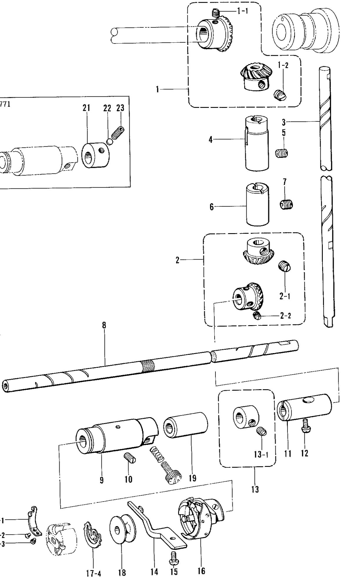
J. カマ関係 / Rotary hook mechanism / Greifervorrichtung /
