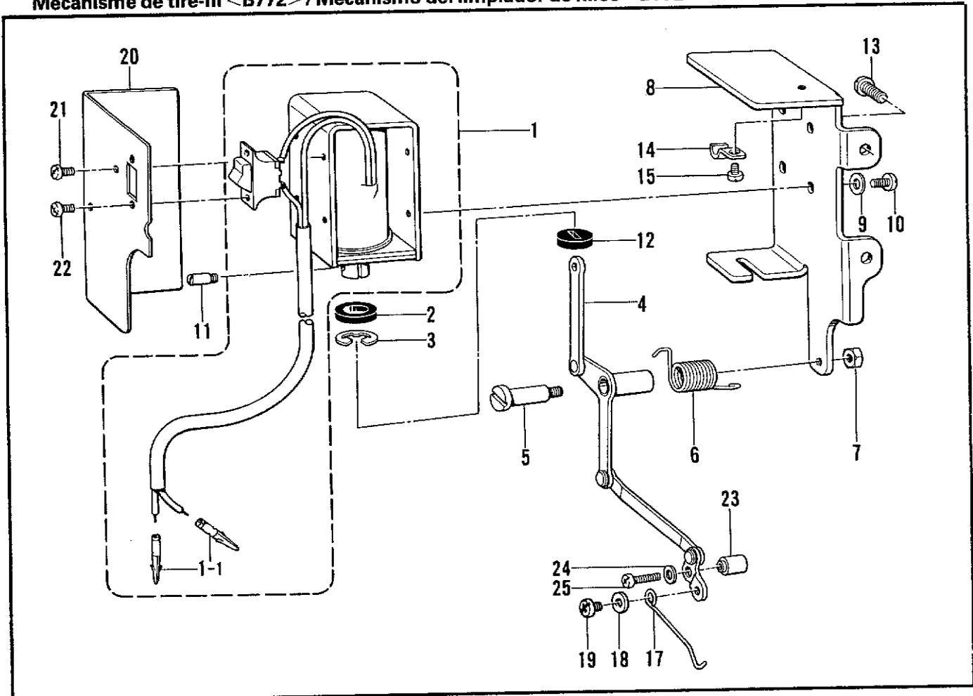
P. 糸ユルメ関係 <B772> / Tension release mechanism <B772> / Spannungsverminderungsvoerrichtung <B772> /
