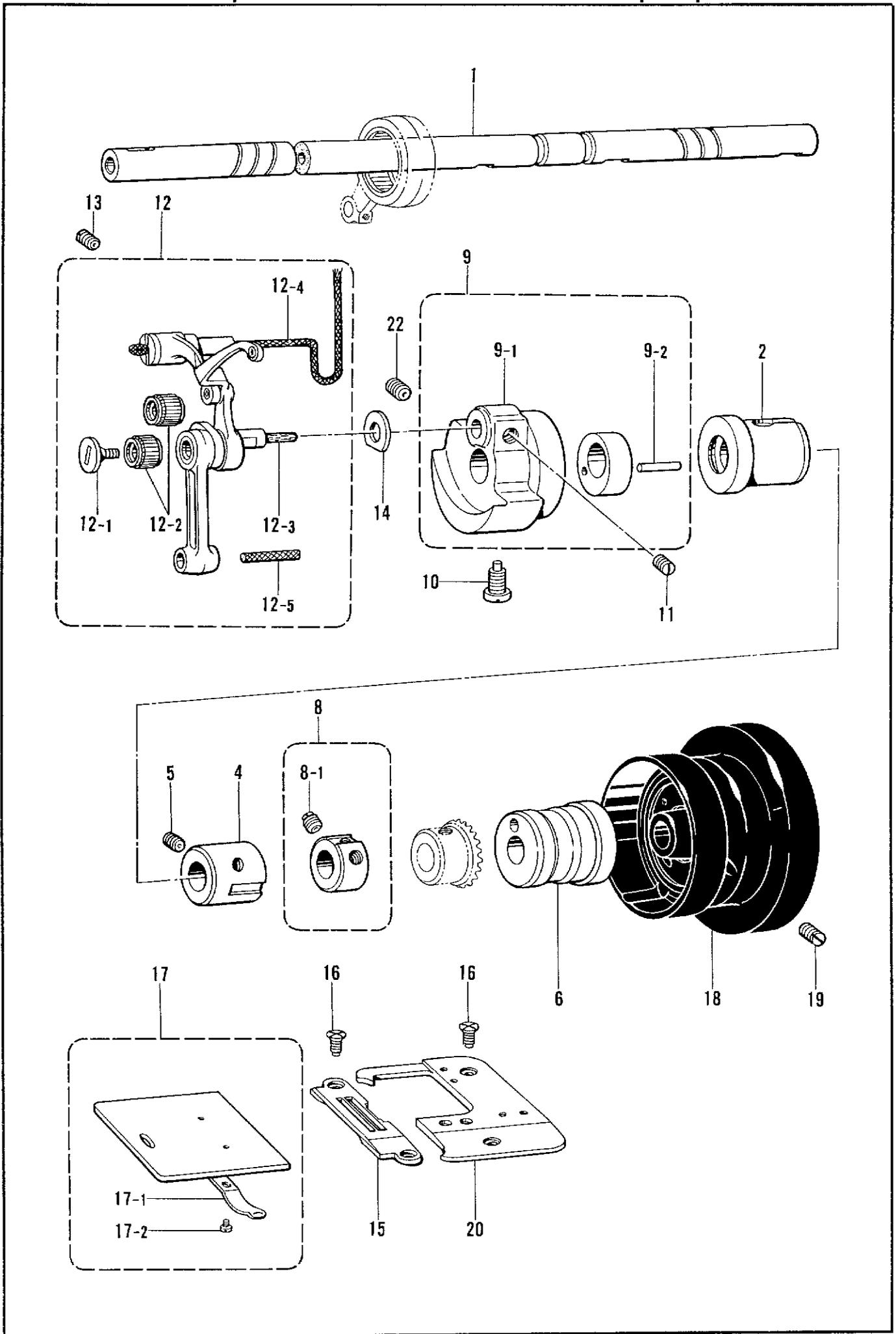
C. 上軸天ビン関係 / Upper shaft and thread take-up mechanism / Obere Welle und Fadenabnahmevorrichtung /
