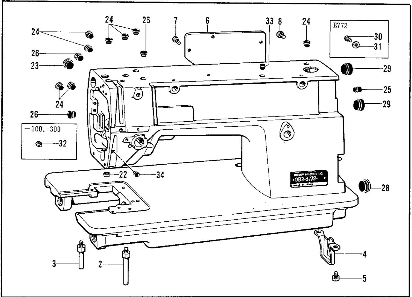
B. ヒザ上げ関係 / Knee lifter mechanism / Kniehebel /
