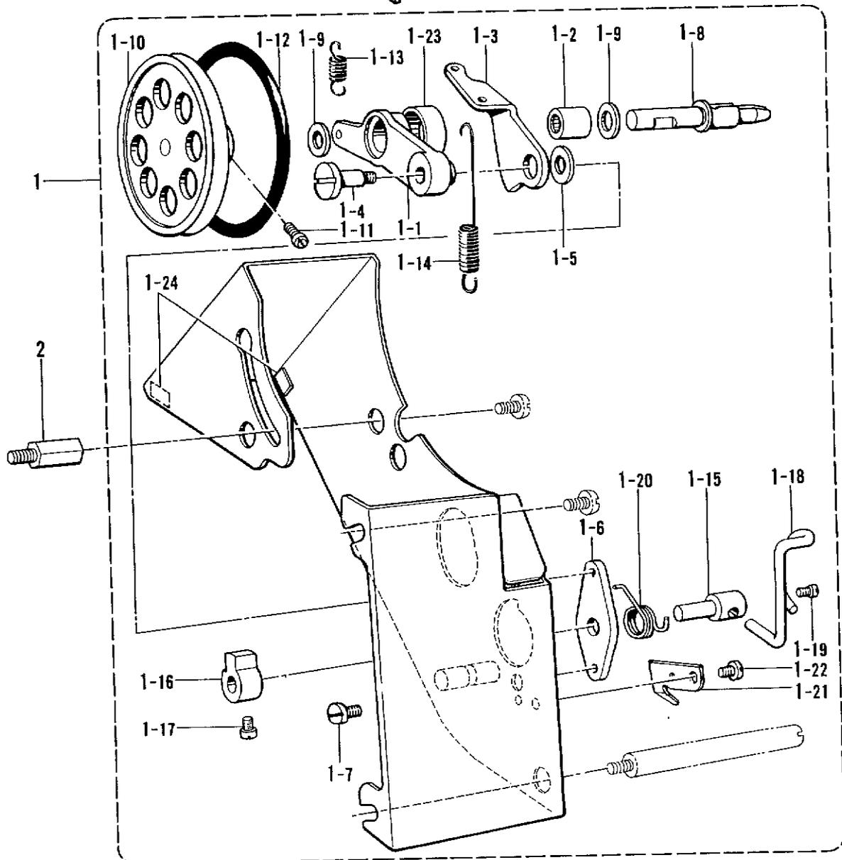
M. 糸巻き関係 <B772> / Bobbin winder mechanism <B772> / Spuler <B772> /
