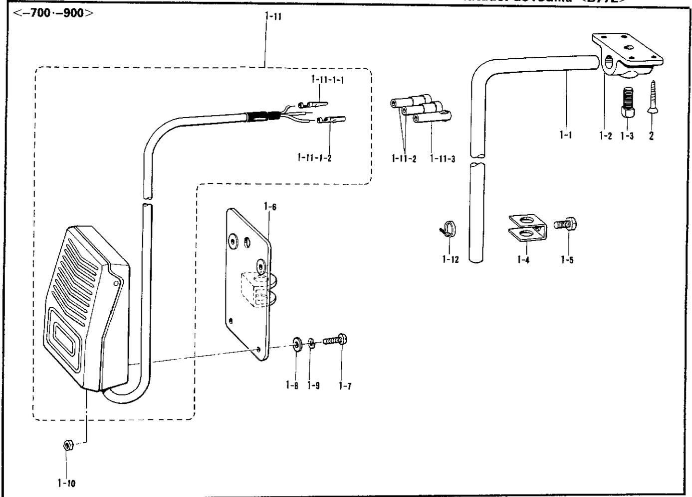
U. 逆転スイッチ関係 <B772> / Quick reverse switch mechanism <B772> / Umkehrschalter <B772> /
