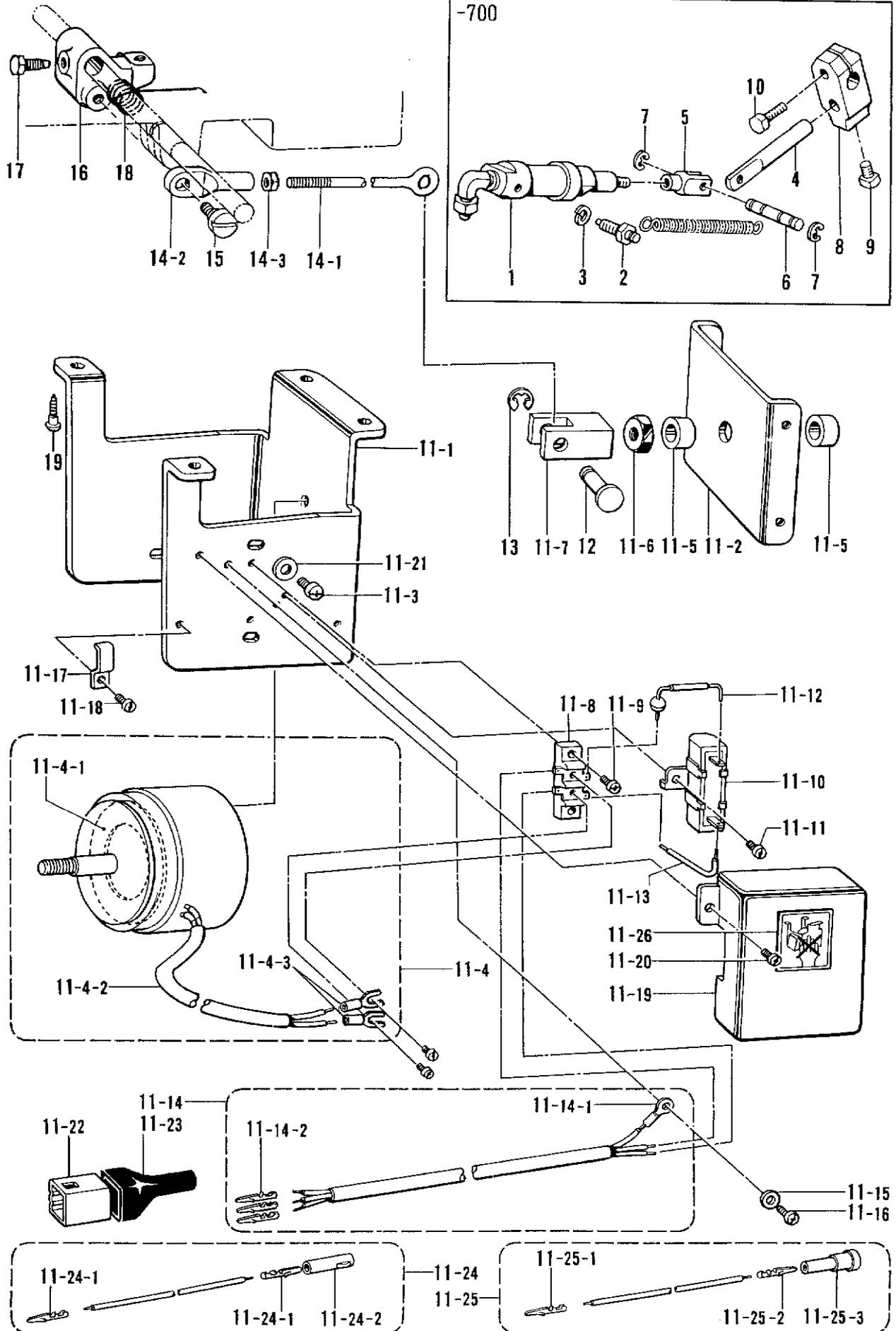
G. 押工上げ関係/Work clamp lifter mechanism / Stoffhalterhebevorrichtung /
