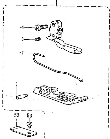
D. 押工関係/Presser foot mechanism/Stoffdrückerfuß/
