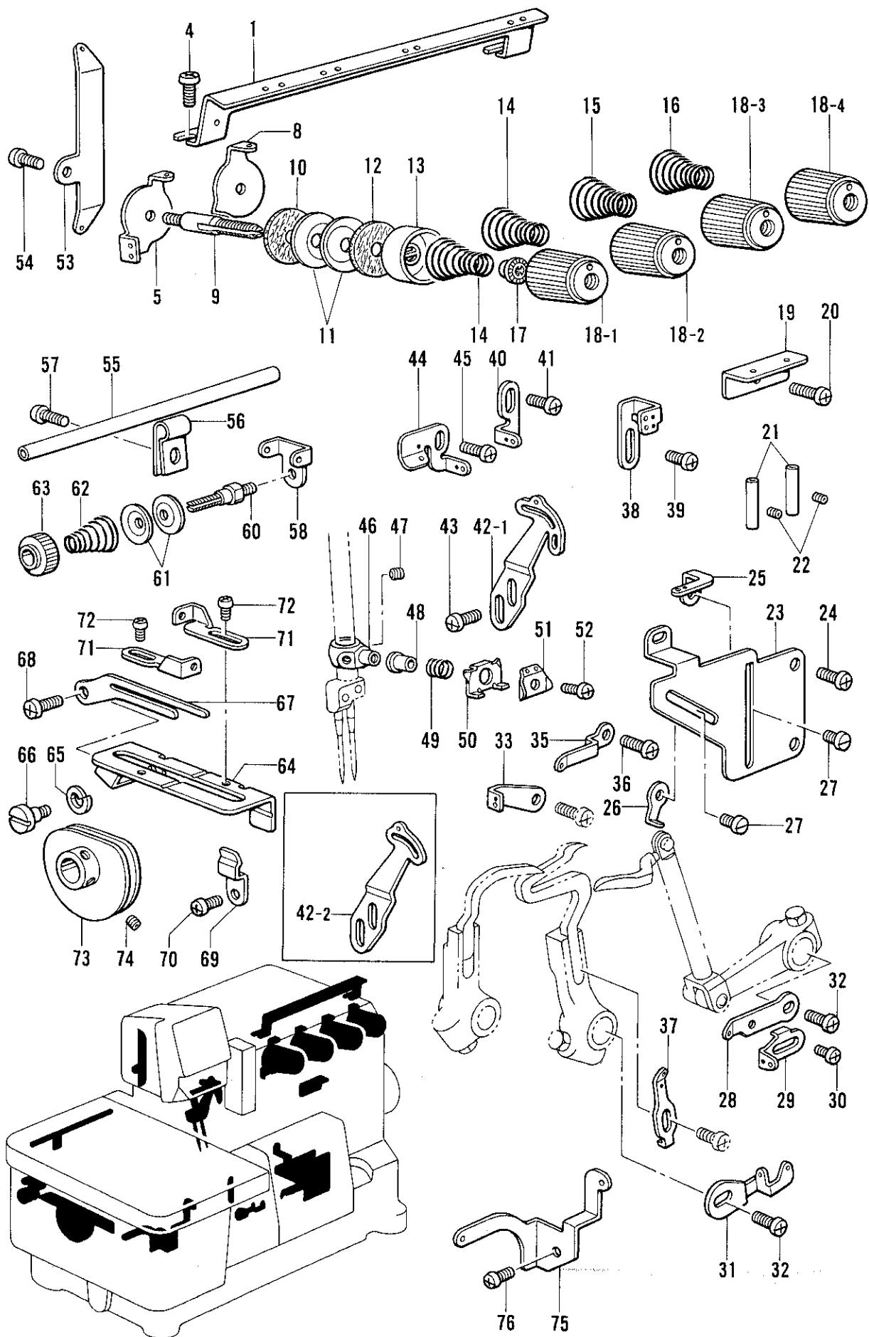
N. 糸調子関係/Thread tension/Faderspannung/
