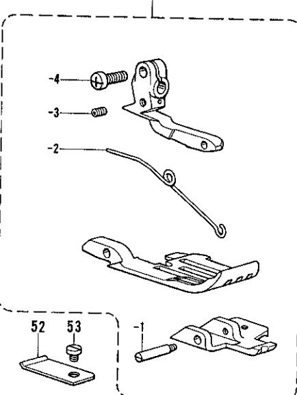
D. 押工関係/Presser foot mechanism/Stoffdrückerfuß/
