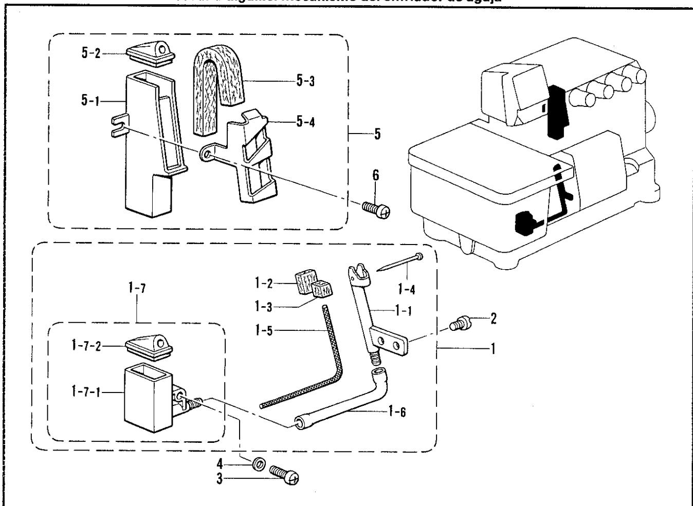
L. 給油・潤滑関係/Lubrication/Schmierung/
