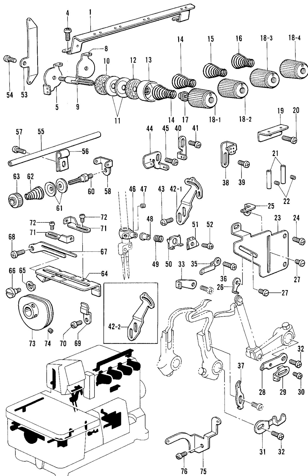
N. 糸調子関係 / Thread tension / Faderspannung /
