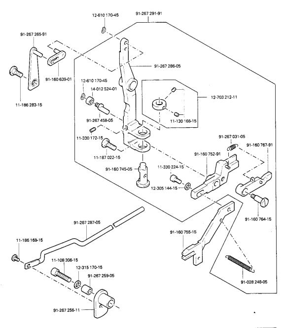
Fadenspannung Thread tension
