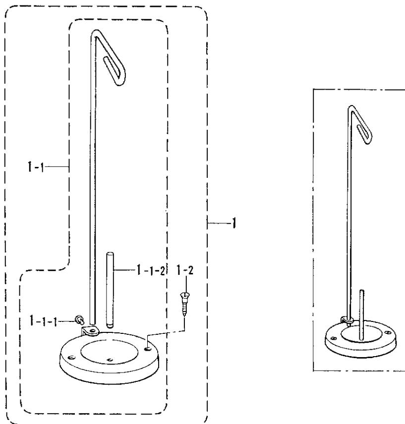
P. テープワインダー関係 / Tape winder mechanism / Bandaufwickelvorrichtung /
