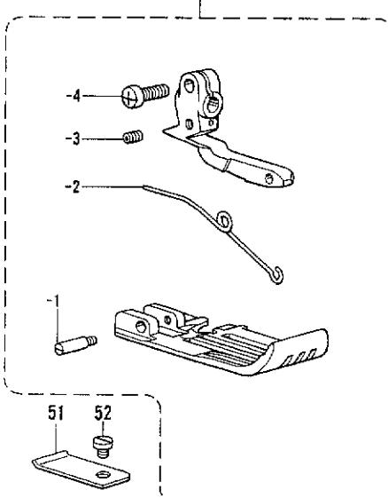
D. 押工関係/Presser foot mechanism/Stoffdrückerfuß/
