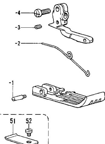
D. 押工関係/Presser foot mechanism/Stoffdrückerfuß/
