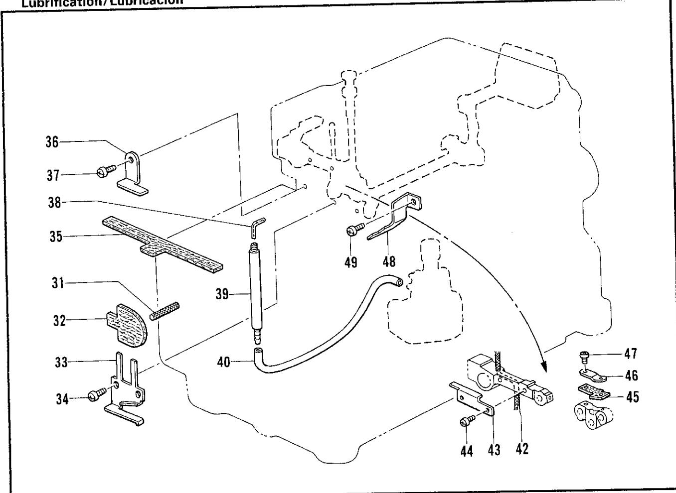
L. 針冷却装置 / Needle cooler / Nadelkühlungsvorrichtung /
