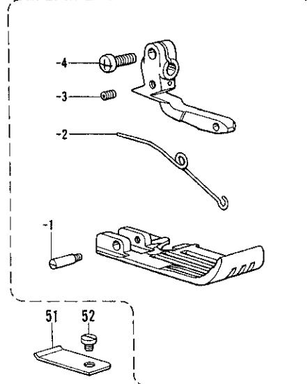
D. 押工関係/Presser foot mechanism/Stoffdrückerfuß/
