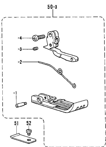
D. 押工関係 / Presser foot mechanism / Stoffdrückerfuß /
