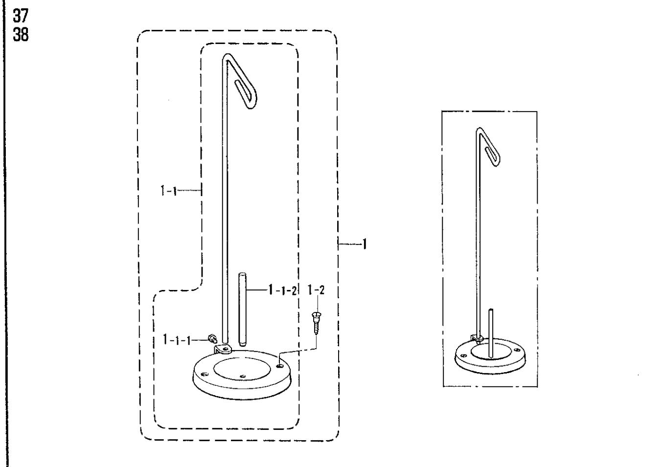
L. 針冷却装置/Needle cooler/Nadelkühlungsvorrichtung/
