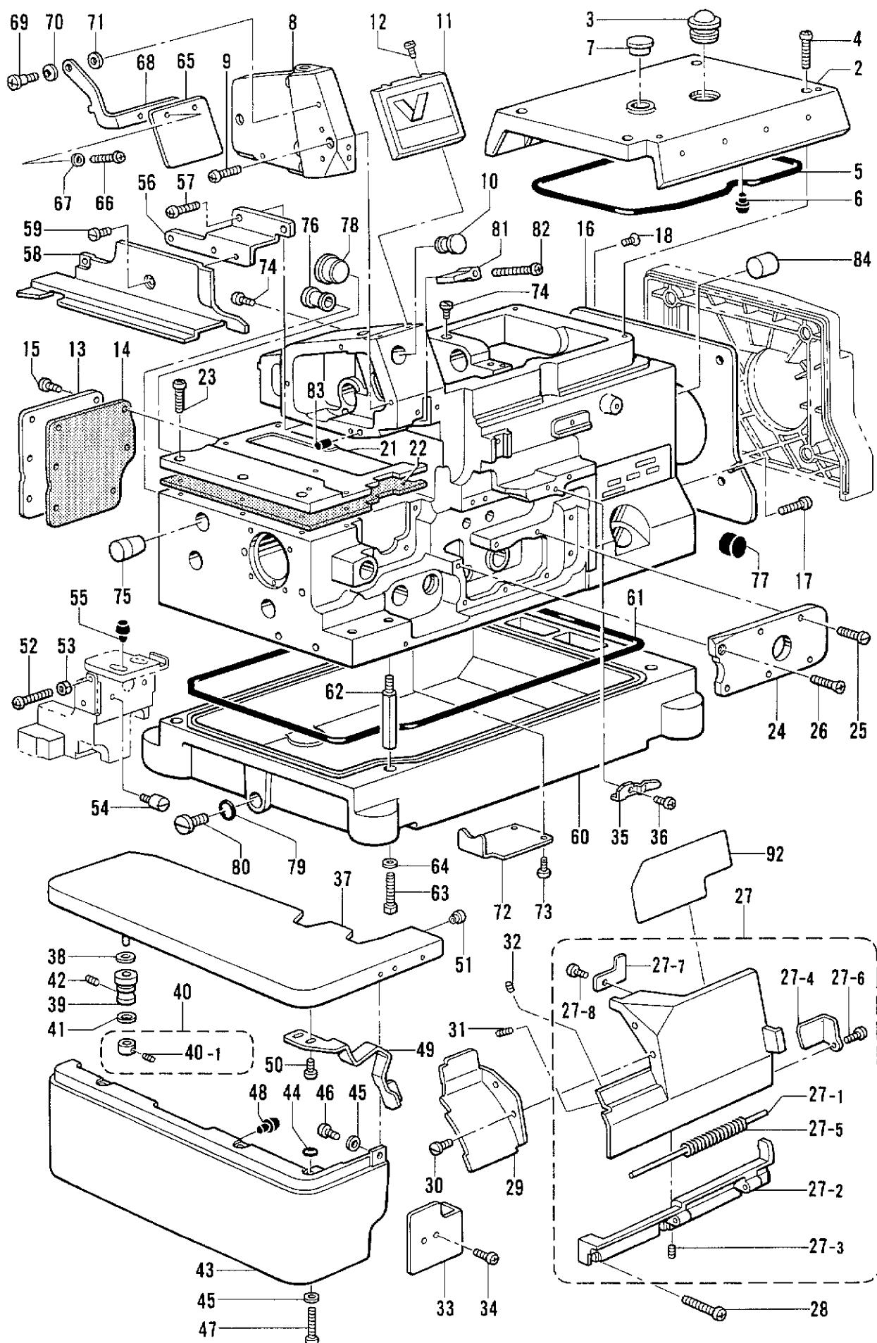
A. フレーム関係 /Machine body/Maschinengehäuse/
