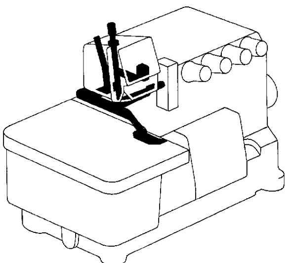
D. 押工関係 / Presser foot mechanism / Stoffdrückerfuß /
