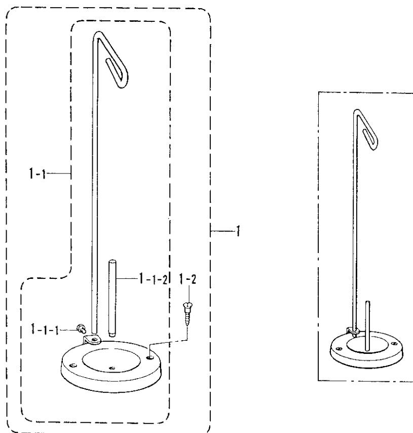
L. 針冷却装置 / Needle cooler / Nadelkühlungsvorrichtung /
