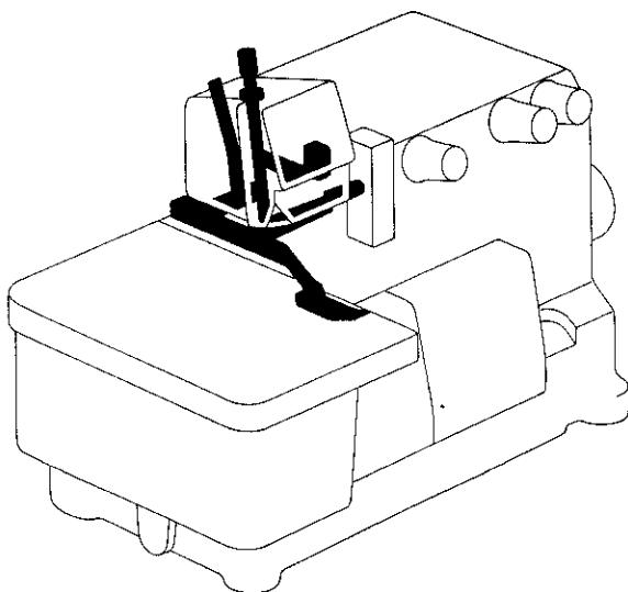
D. 押工関係/Presser foot mechanism/Stoffdrückerfuß/
