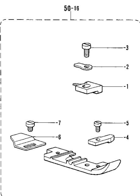
D. 押工関係/Presser foot mechanism/Stoffdrückerfuß/
