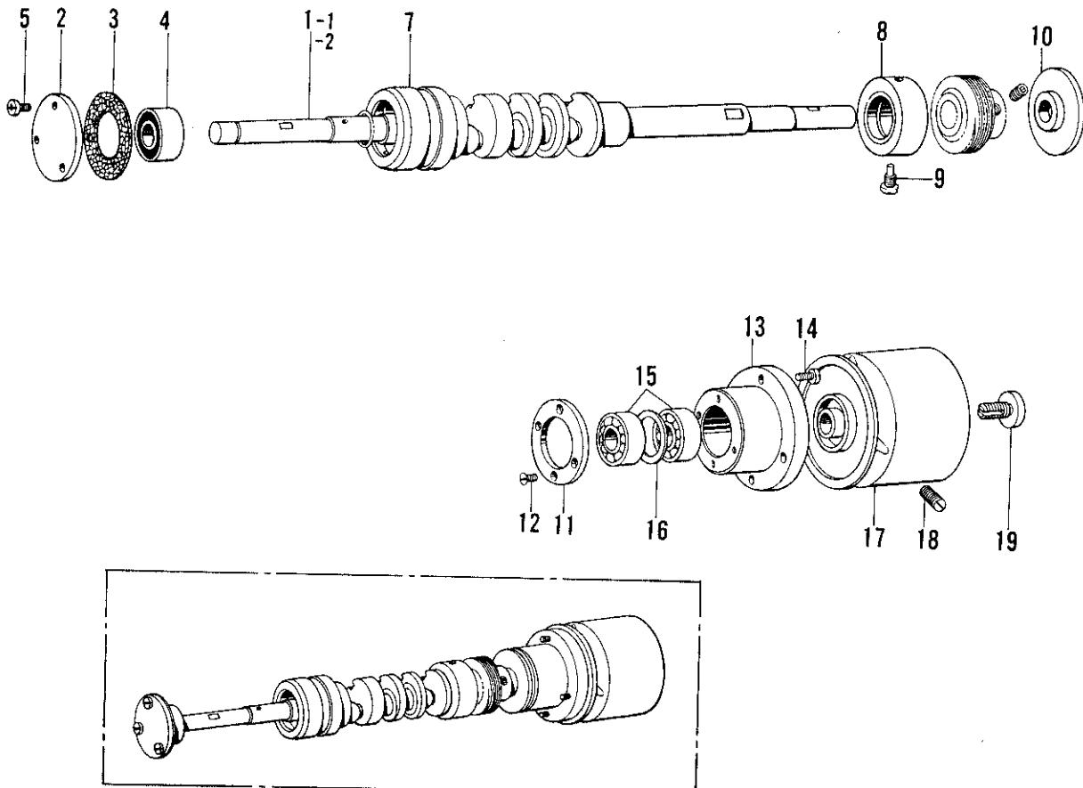
C. 針冷却装置/Needle cooler/Nadelkühlungsvorrichtung/
