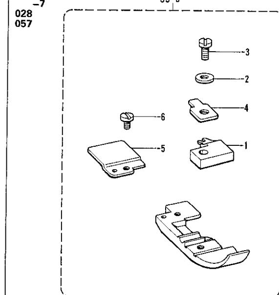
E. 押工関係/Presser foot mechanism/Stoffdrückerfuß/
