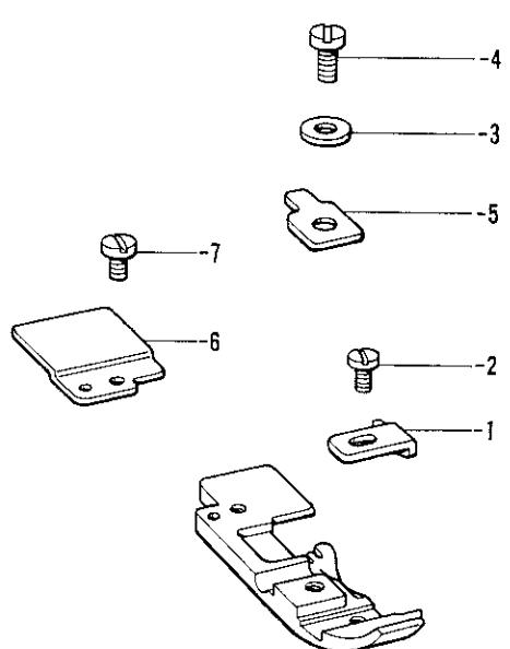
E. 押工関係/Presser foot mechanism/Stoffdrückerfuß/
