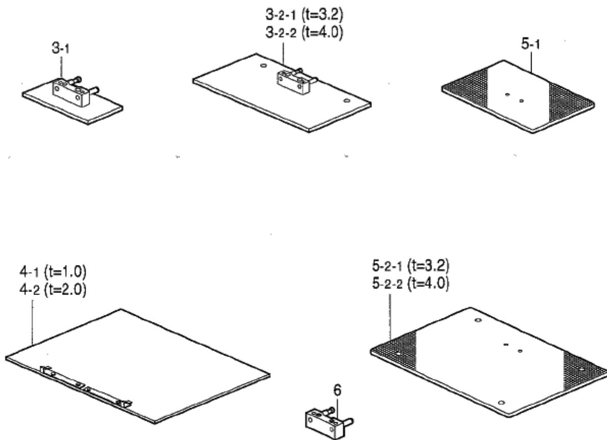
X3. 中押工反転装置関係 (オプション部品) / Inner clamping device (Option parts)
