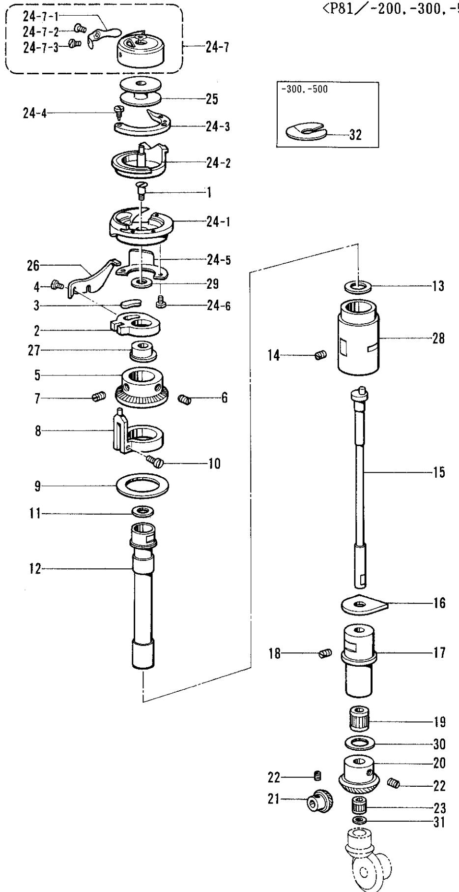
J2. カマ関係/Rotary hook mechanism/Greifervorrichtung/
