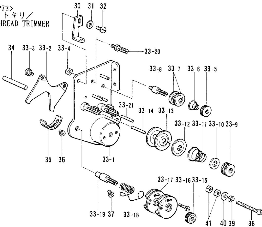
**K4. 糸調子関係 / Thread tension / Faderspannung /
