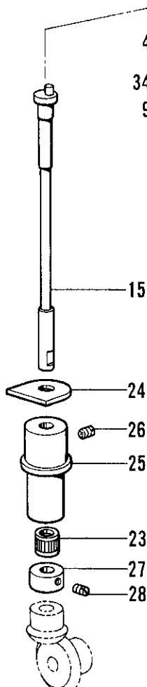
J4. カマ関係/Rotary hook mechanism/Greifervorrichtung/
