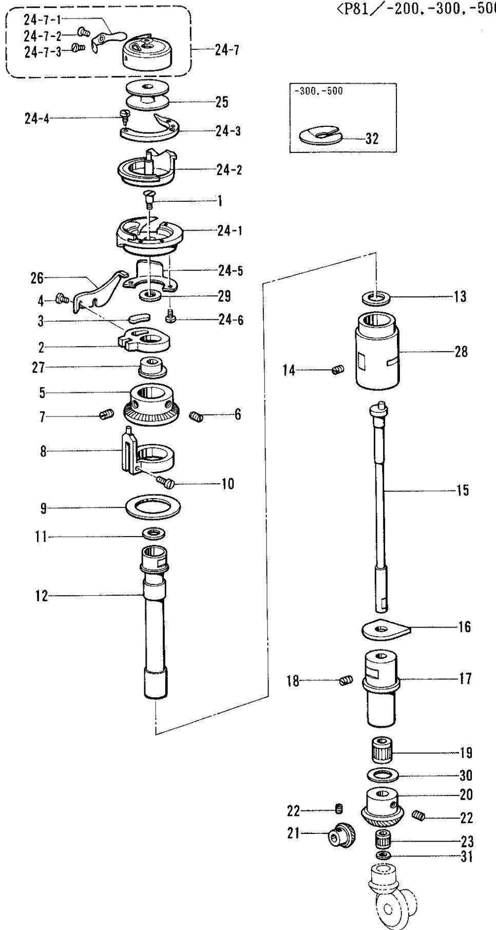
J2. カマ関係/Rotary hook mechanism/Greifervorrichtung/
