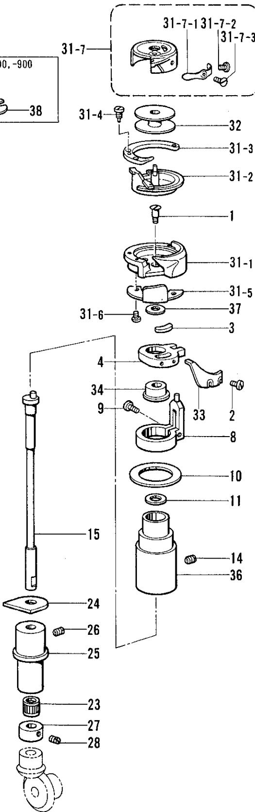
J4. カマ関係/Rotary hook mechanism/Greifervorrichtung/
