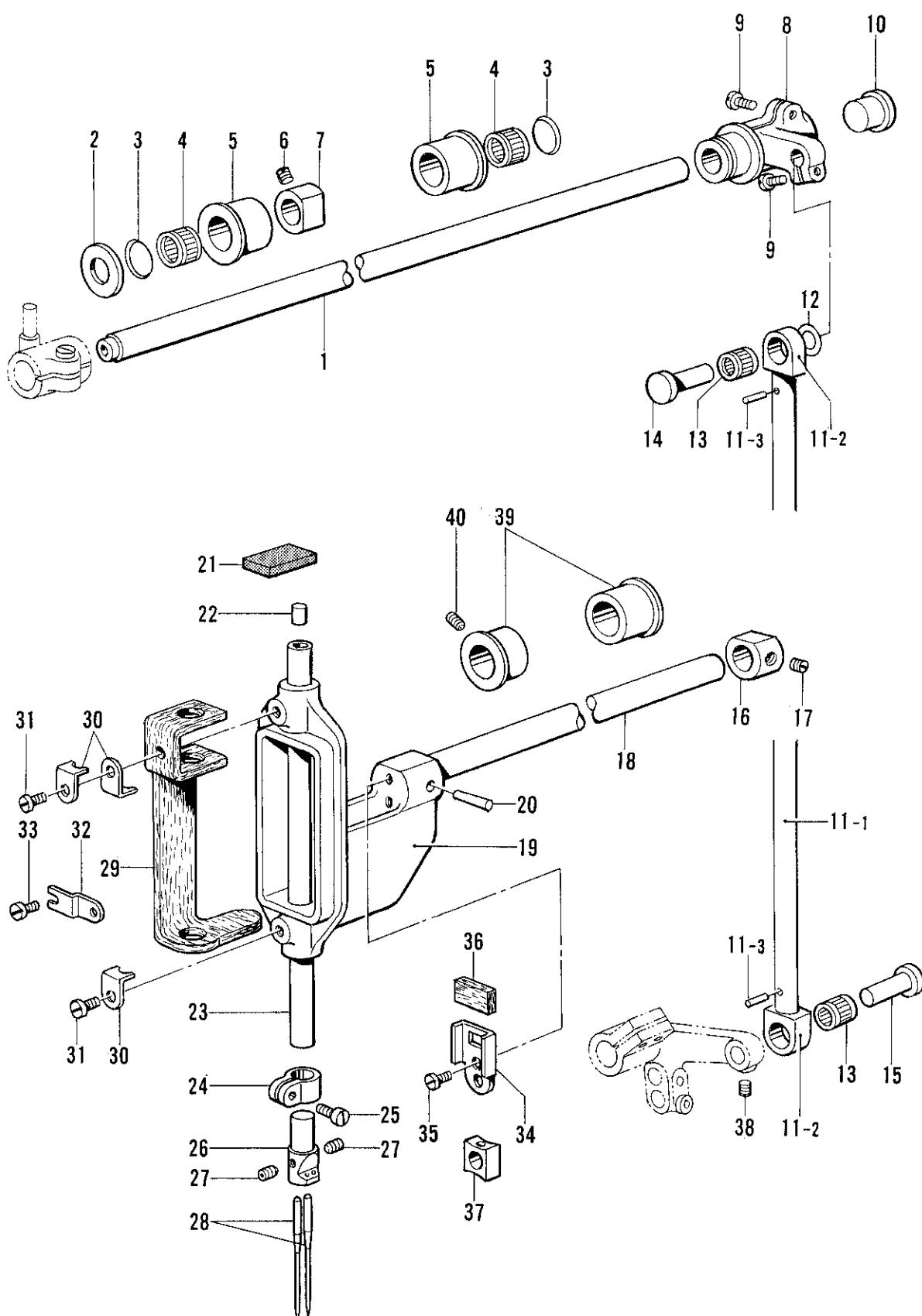
C2. 針棒振動関係 / Needle bar rocking mechanism / Nadelstangenbetäigung /
