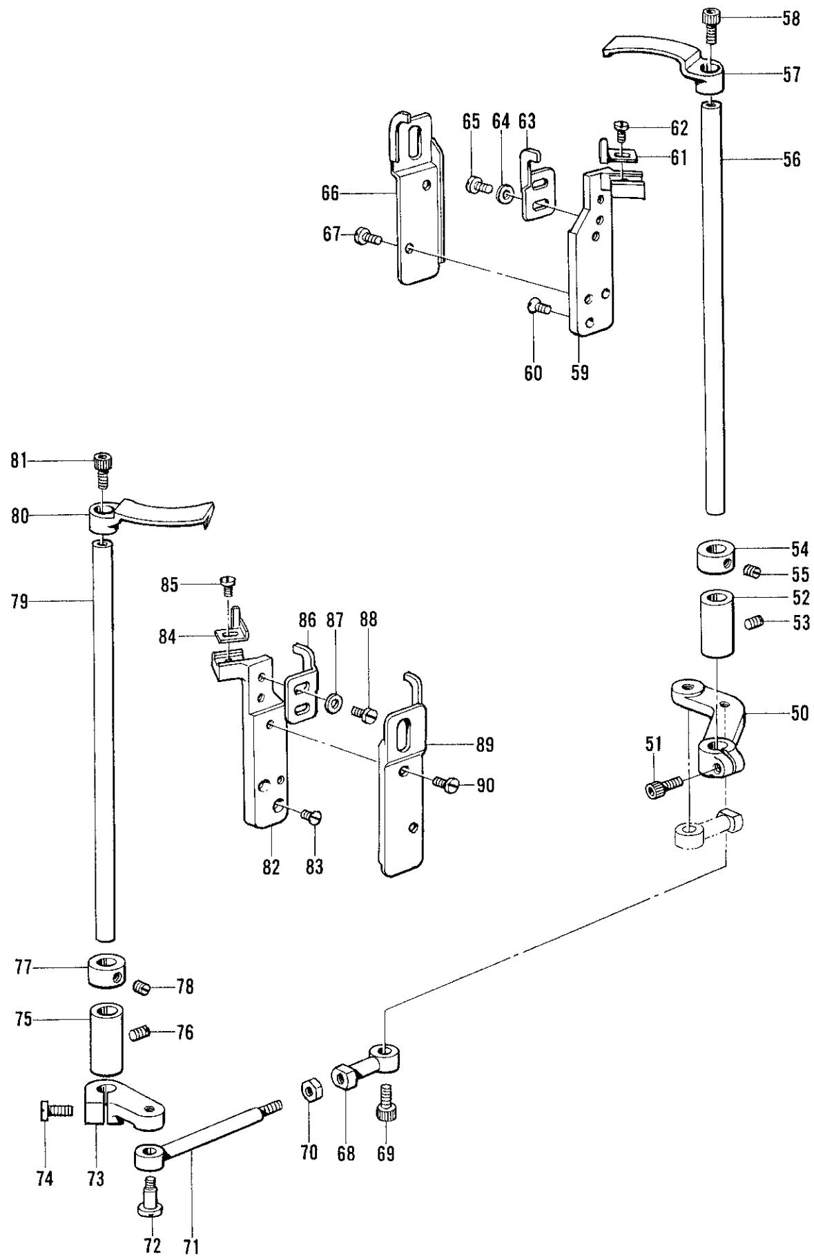
N2. 糸切り関係/Thread trimmer mechanism/Fadenabschneidevorrichtung/
