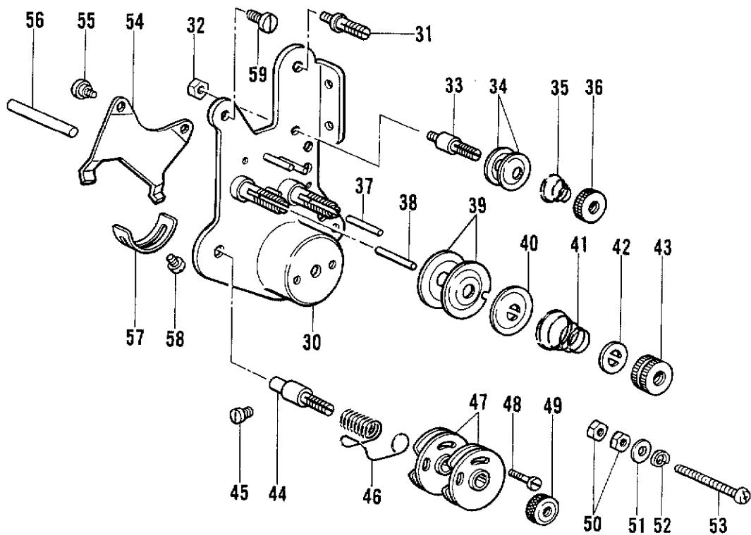
L3. 糸調子関係/Thread tension/Faderspannung/
