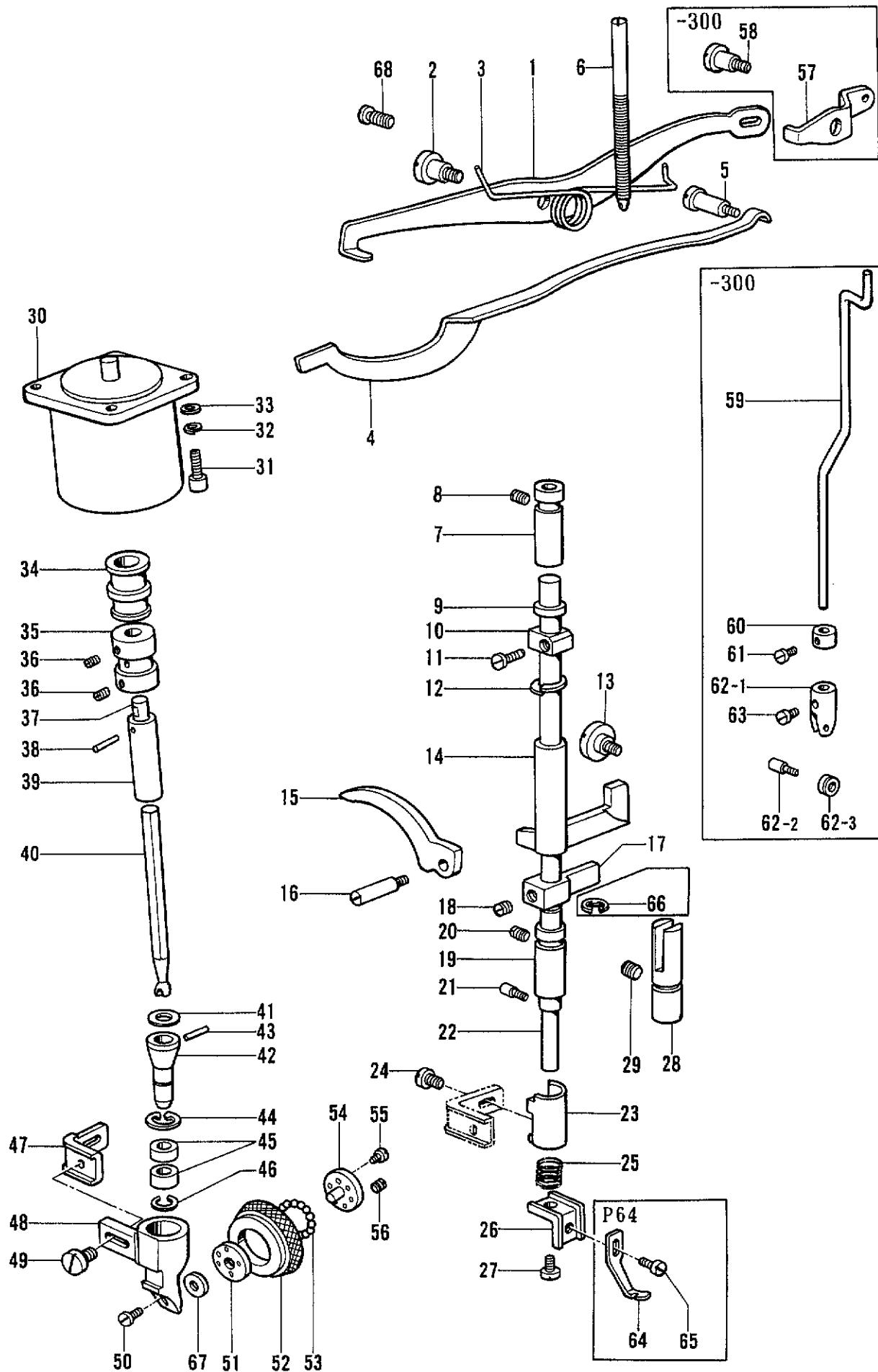
D. 押工関係/Presser foot mechanism/Stoffdrückerfuß/
