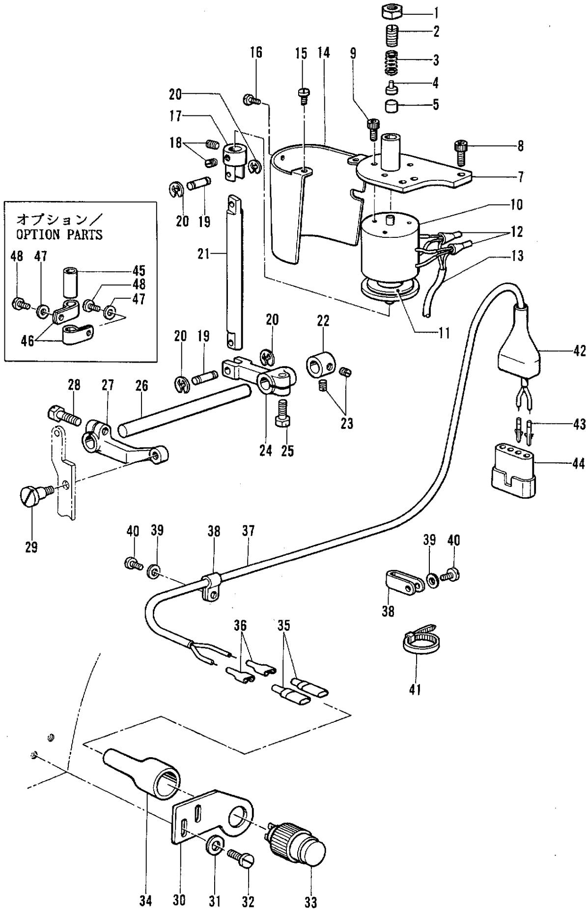
K. タッチバック関係 / Quick back mechanism / Schnellumkehrvorrichtung /
