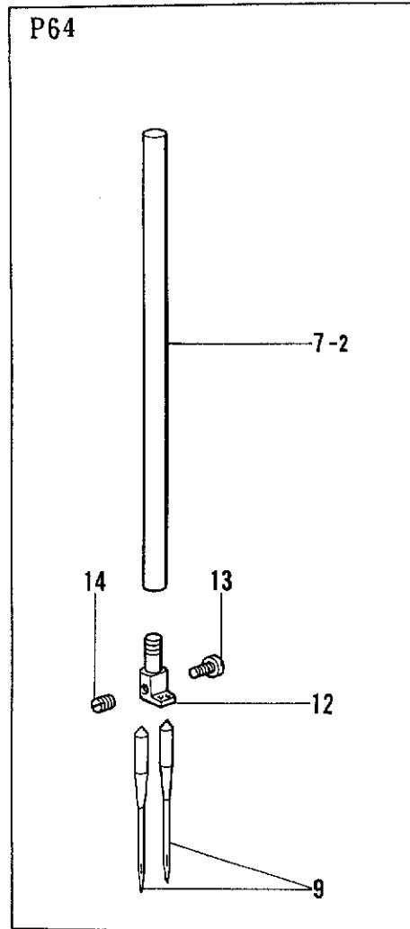
C. 針棒関係 / Needle bar mechanism / Nadelstangenvorrichtung /
