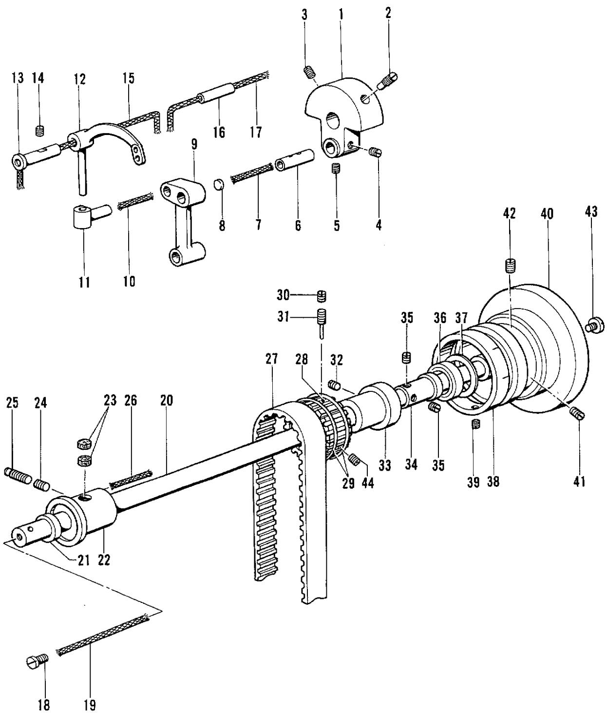
B. 上軸天ビン関係 / Upper shaft and thread take-up mechanism / Obere Welle und Fodenabnahmeverrichtung /
