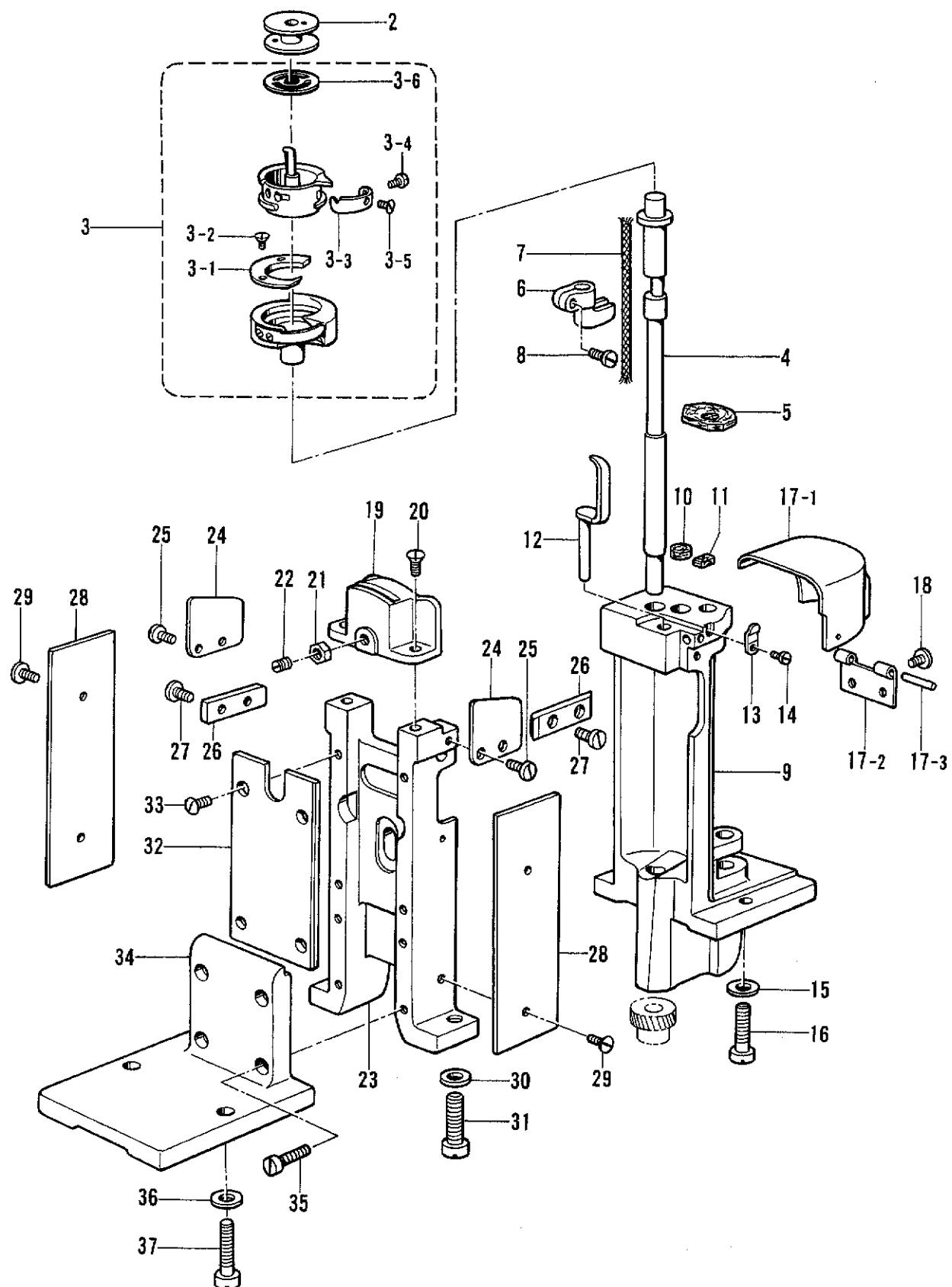
J1. カマ関係/Rotary hook mechanism/Greifervorrichtung/
