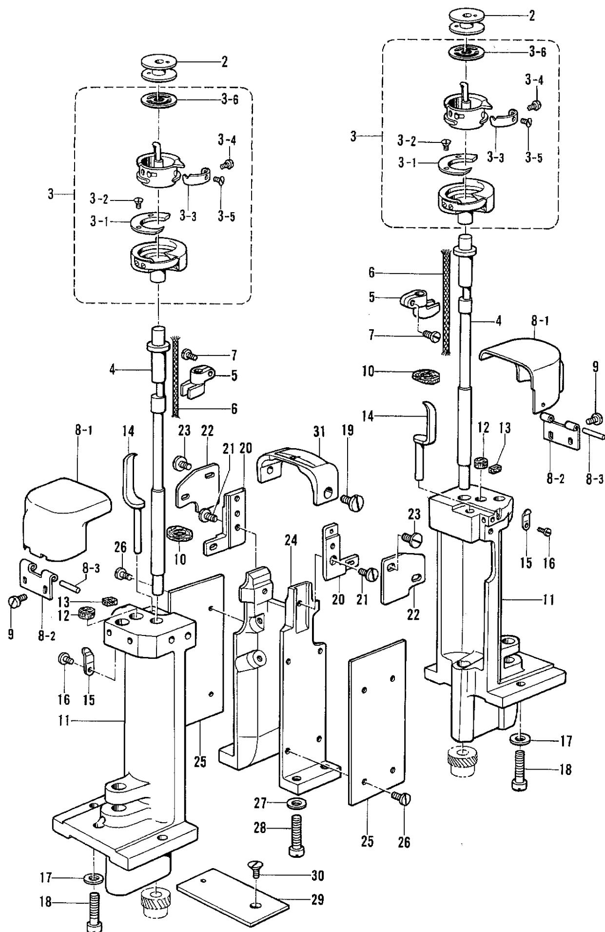
J2. カマ関係/Rotary hook mechanism/Greifervorrichtung/
