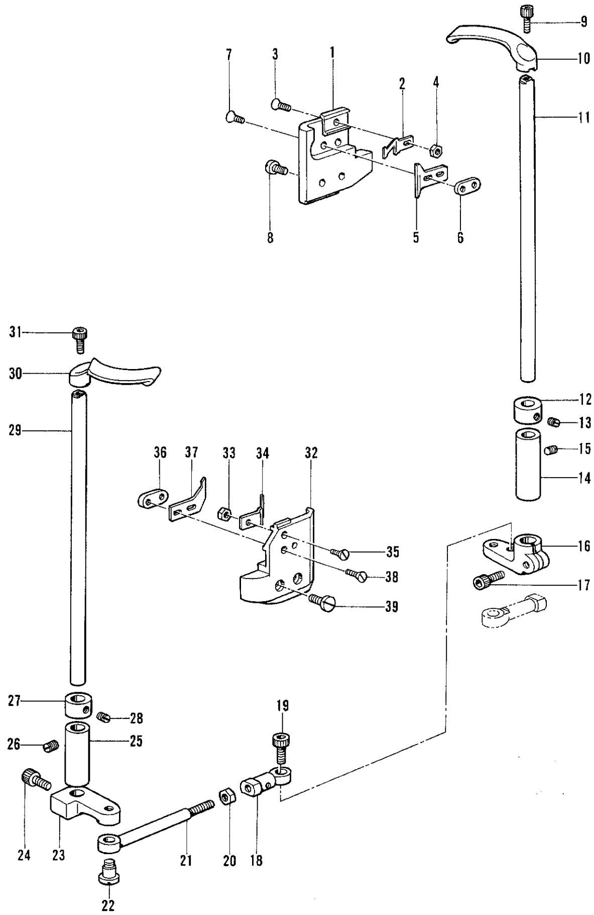
**M1. 糸切り関係/Thread trimmer mechanism/Fadenabschneidevorrichtung/
