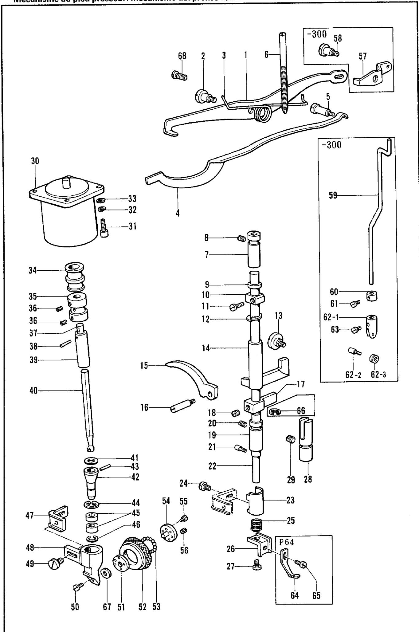
D. 押工関係/Presser foot mechanism/Stoffdrückerfuß/
