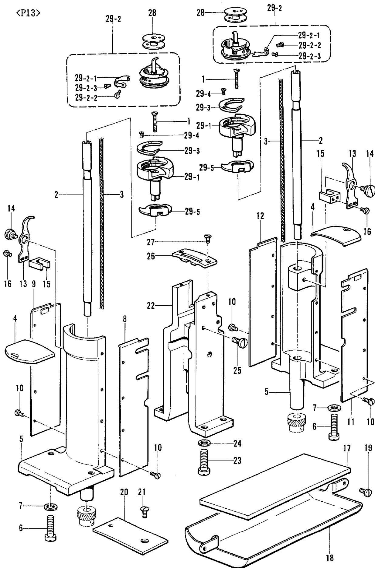
J2. カマ関係 /Rotary hook mechanism/Greifervorrichtung/
