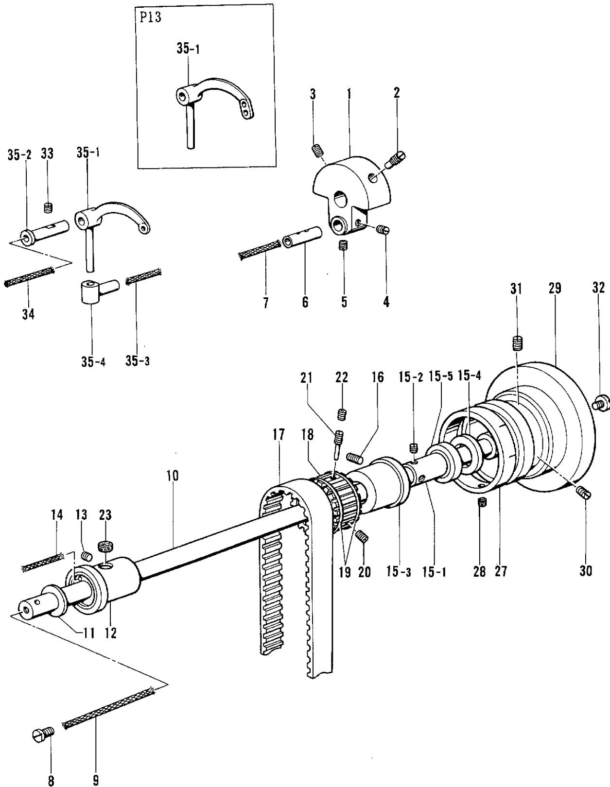
B. 上軸・天ビン関係/Upper shaft and thread take-up mechanism/Obere Welle und Fadenabnahmeverrichtung/
