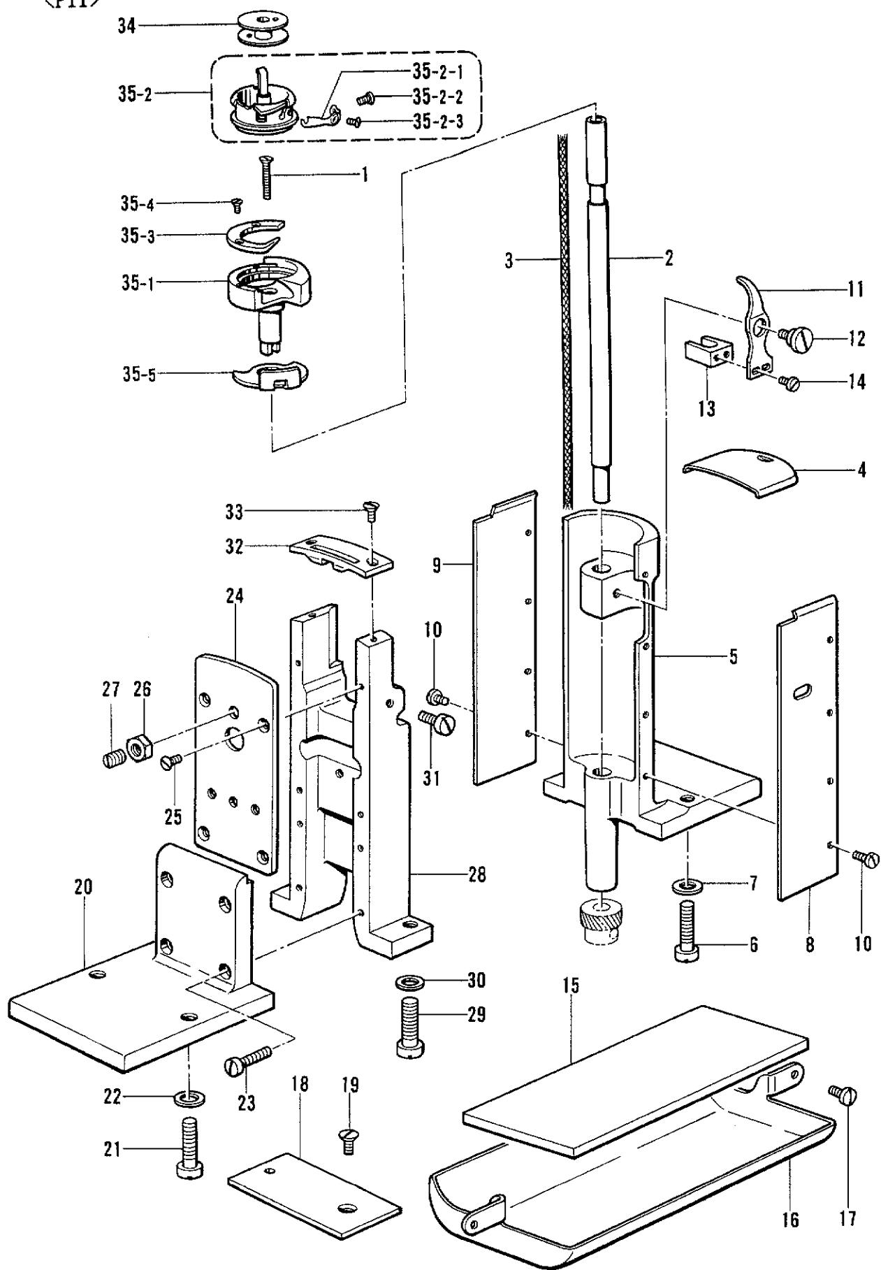
J1. カマ関係 /Rotary hook mechanism/Greifervorrichtung/
