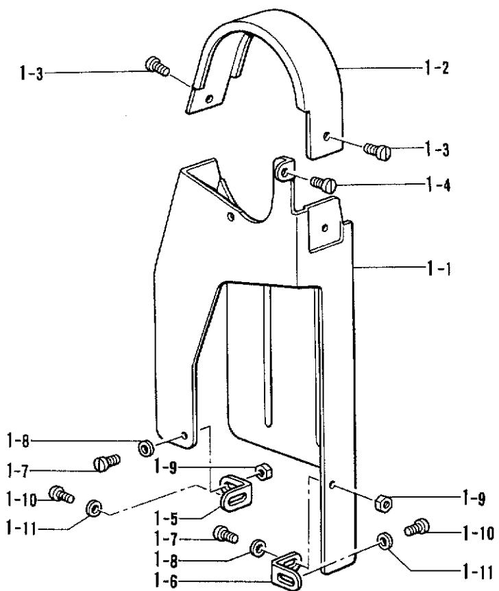
K. ベルトカバー関係 (オプションパーツ) / Belt cover mechanism (Option parts) / Gurtabdeckung (Sonderzubehör) /
