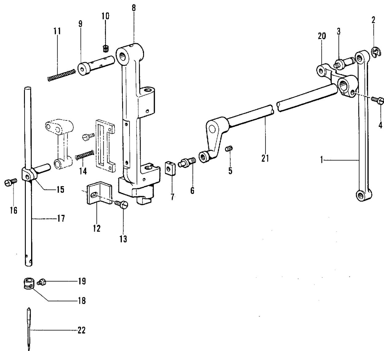
C. 針棒揺動関係 /Needle bar rocking mechanism/Nadelstangenbetätigung/
