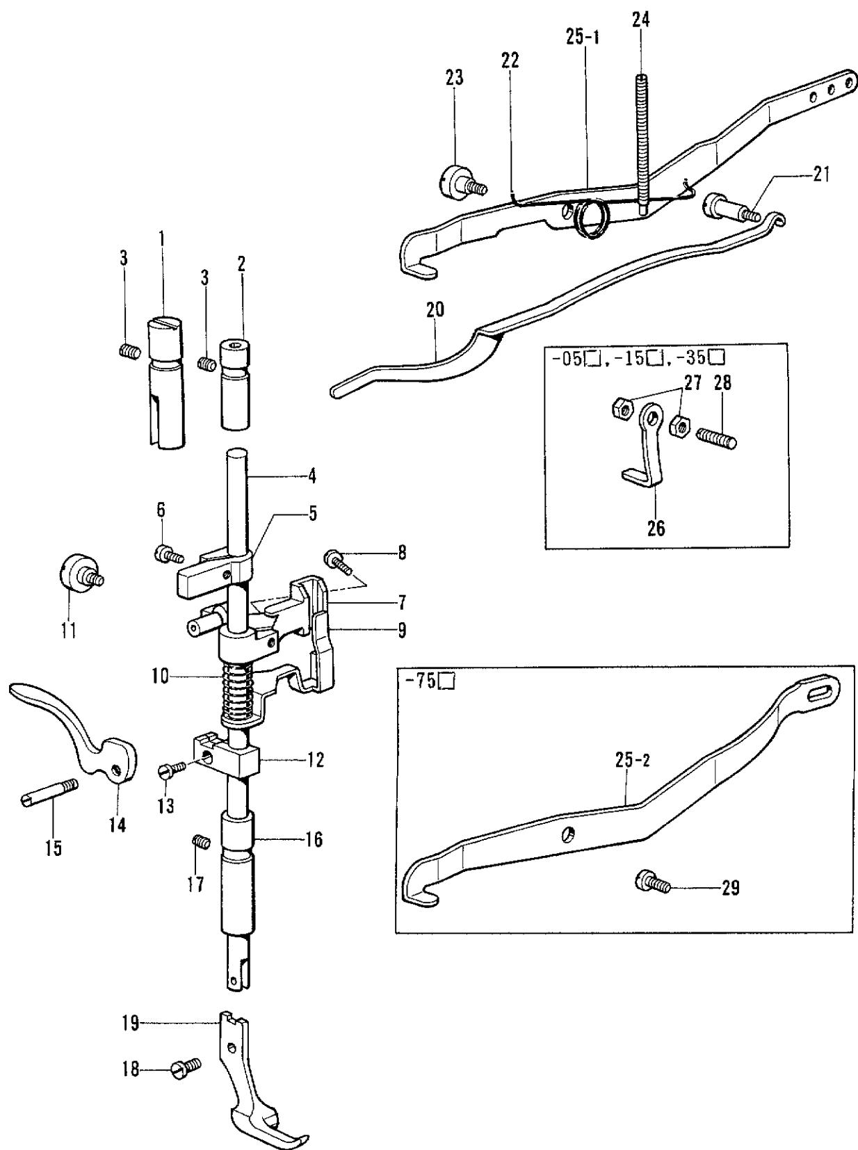
D. 押工関係 /Presser foot mechanism/Stoffdrückerfuß/
