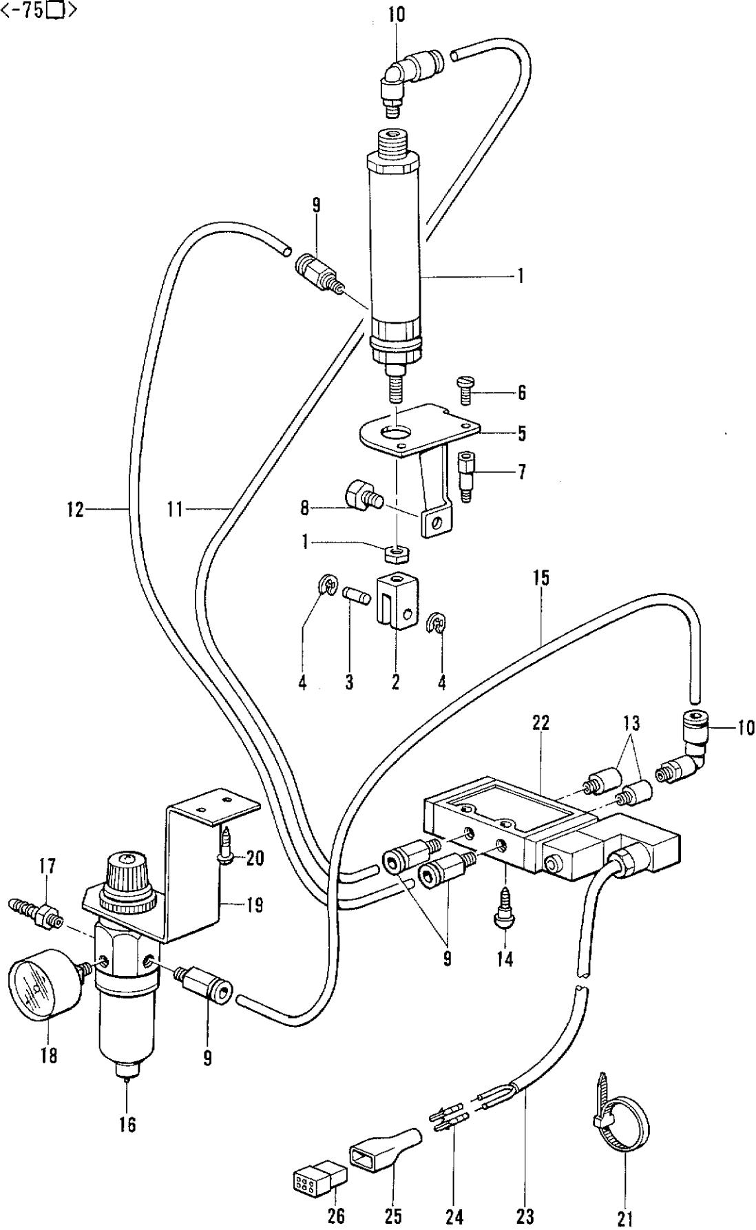
E. 押工上部関係 /Work clamp lifter mechanism/Stoffhalterhebervorrichtung/
