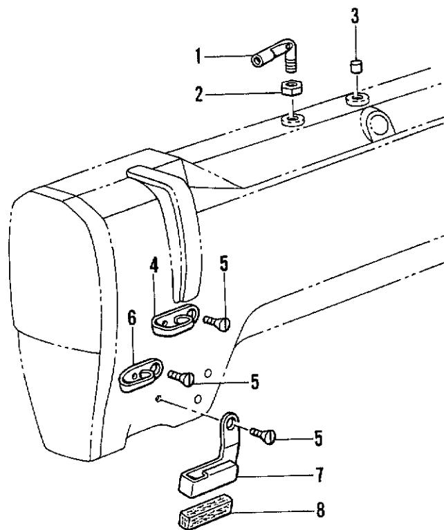
K2. 糸調子関係 / Thread tension / Faderspannung /
