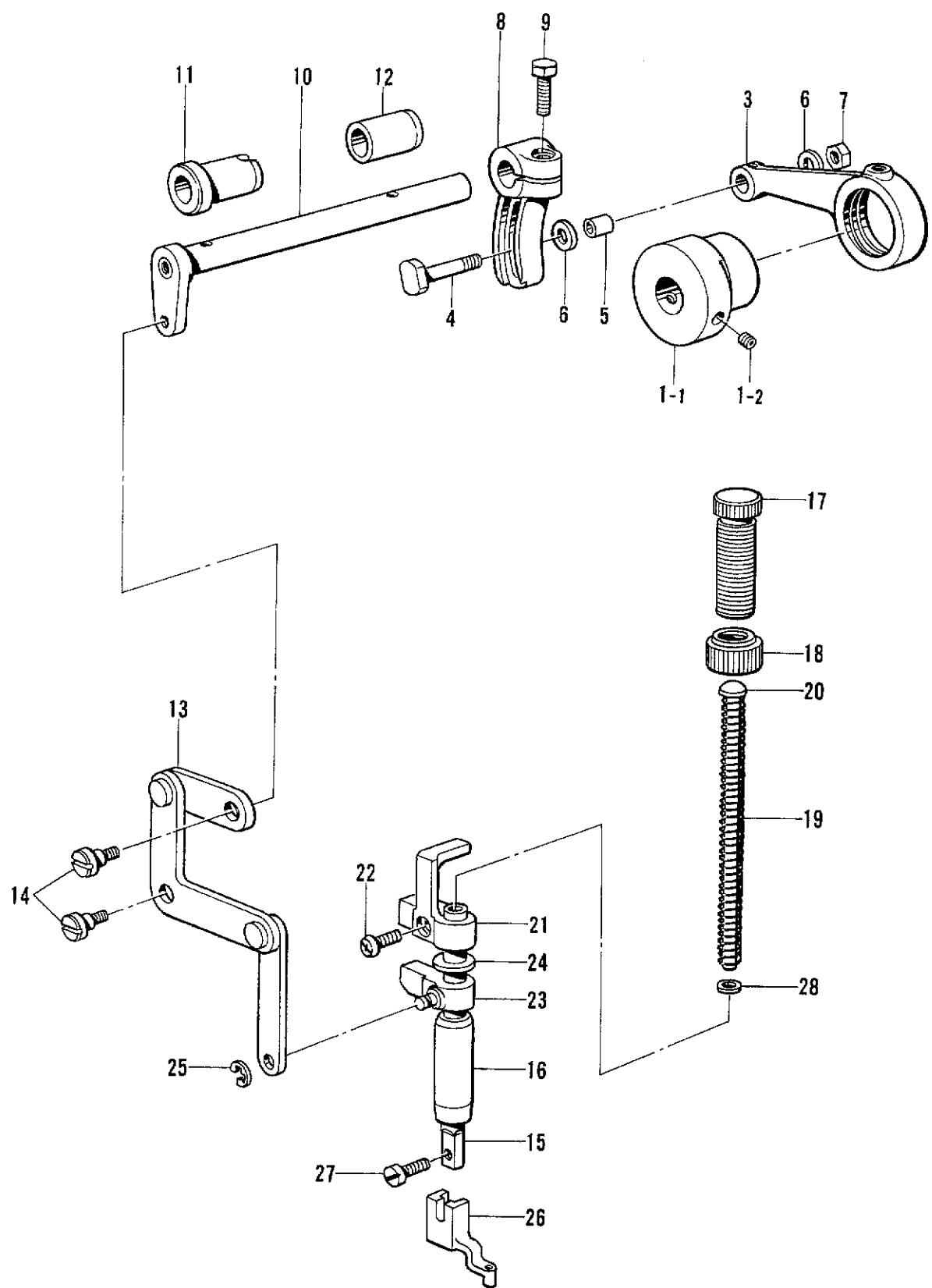
E. 押工上げ関係 / Work clamp lifter mechanism / Stoffhalterhebervorrichtung /
