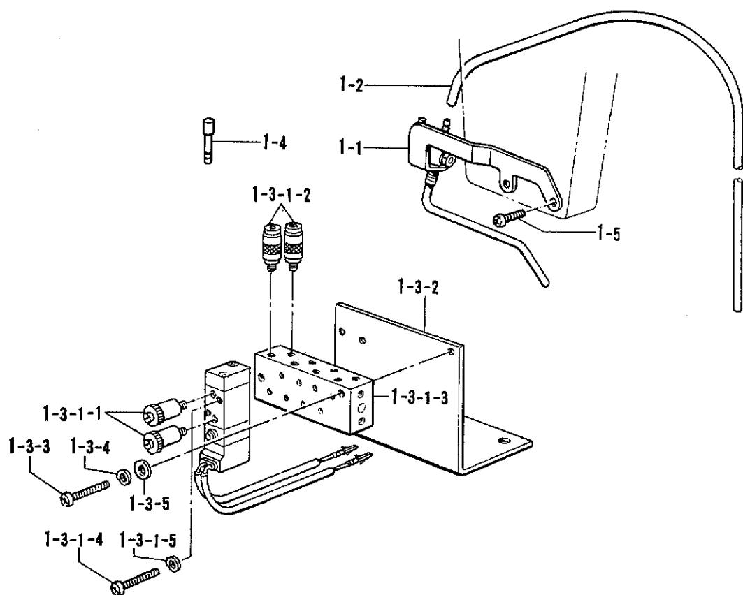
Y. 針冷却装置 /Needle cooler/Nadelkühlungsvorrichtung/
