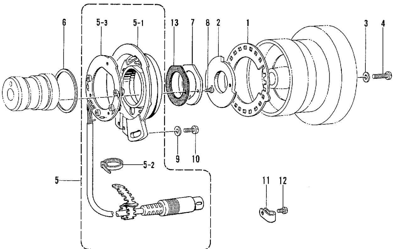
S. 踏板関係/Foot switch pedal mechanism/Fußbetätigung/
