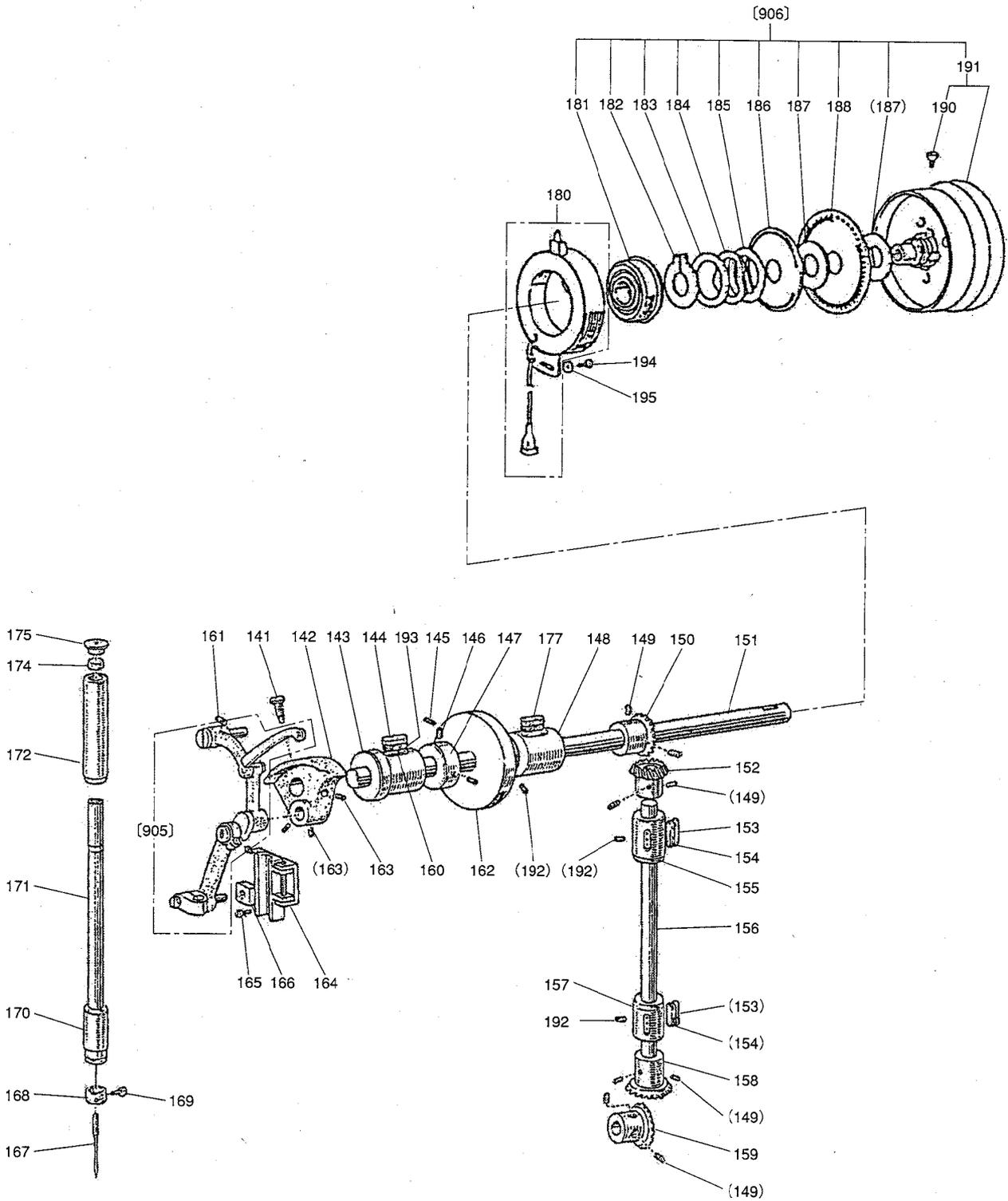
[E]上軸・堅軸・天ビン・針棒機構
