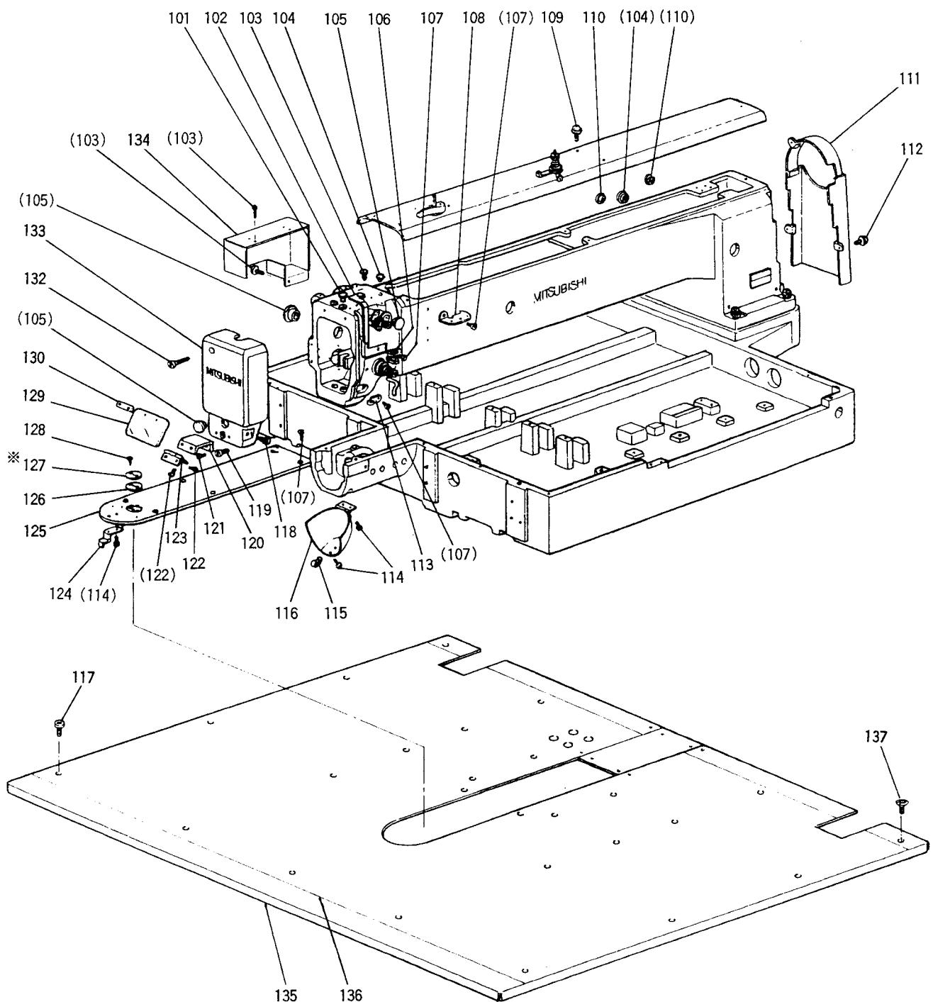
注) 電子ミシン PLK-B5050-LG, ならびに PLK-B10050-LG の機種は図中の Fig.No. に※印を付した部品を変更しています。詳しくは **オプションパーツ** の項を 参照願います。
