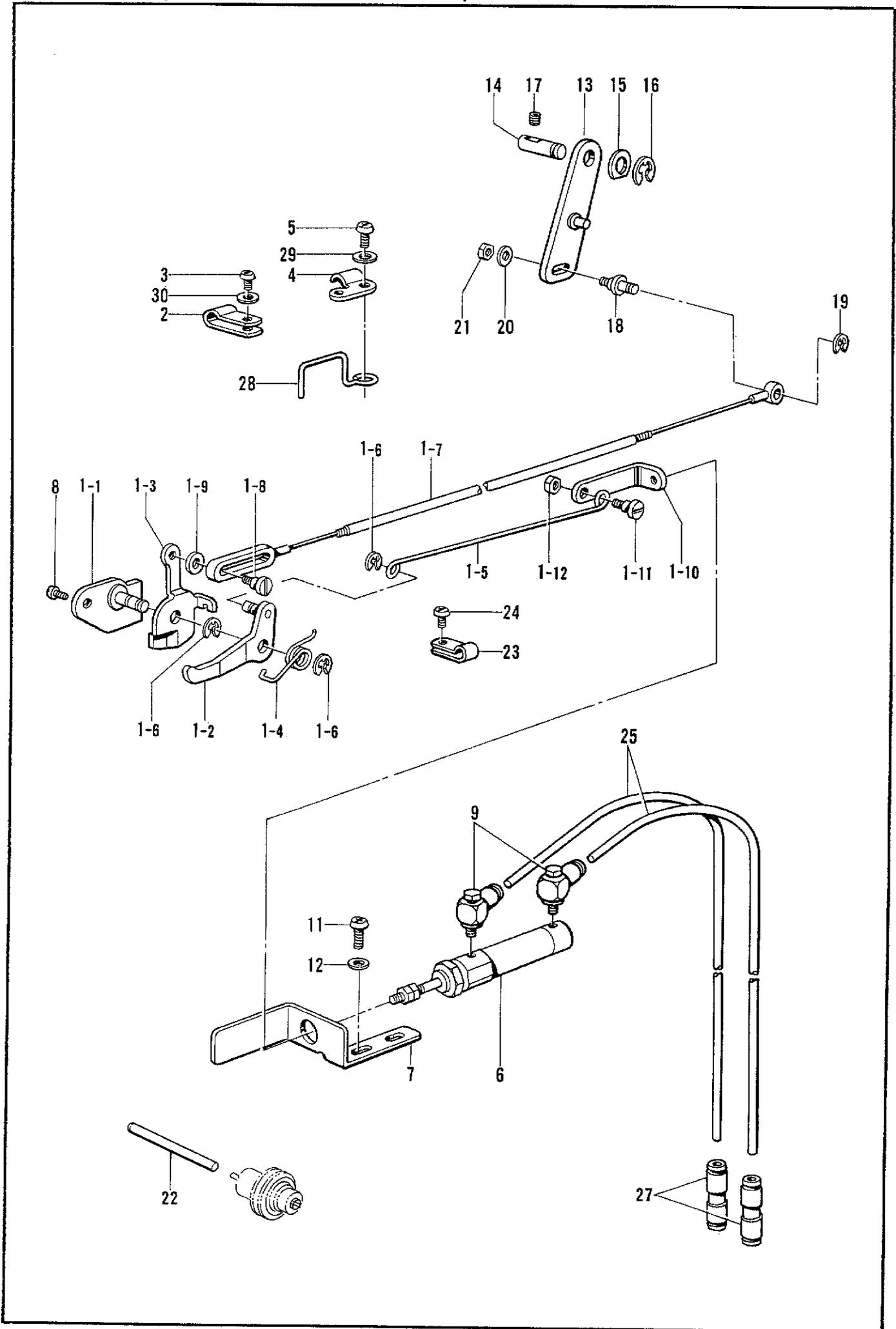
P. 糸締メ関係/Thread nipper mechanism/Fadenspannvorrichtung/
