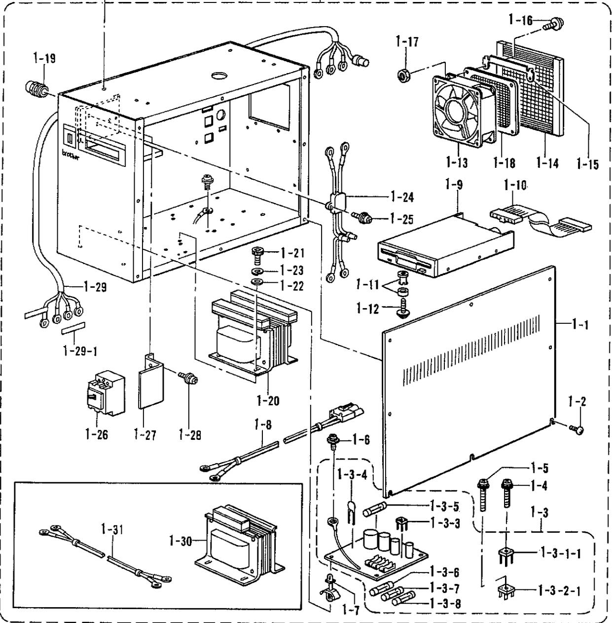
T. コントロールボックス関係/Control box mechanism/Schaltkasten/
