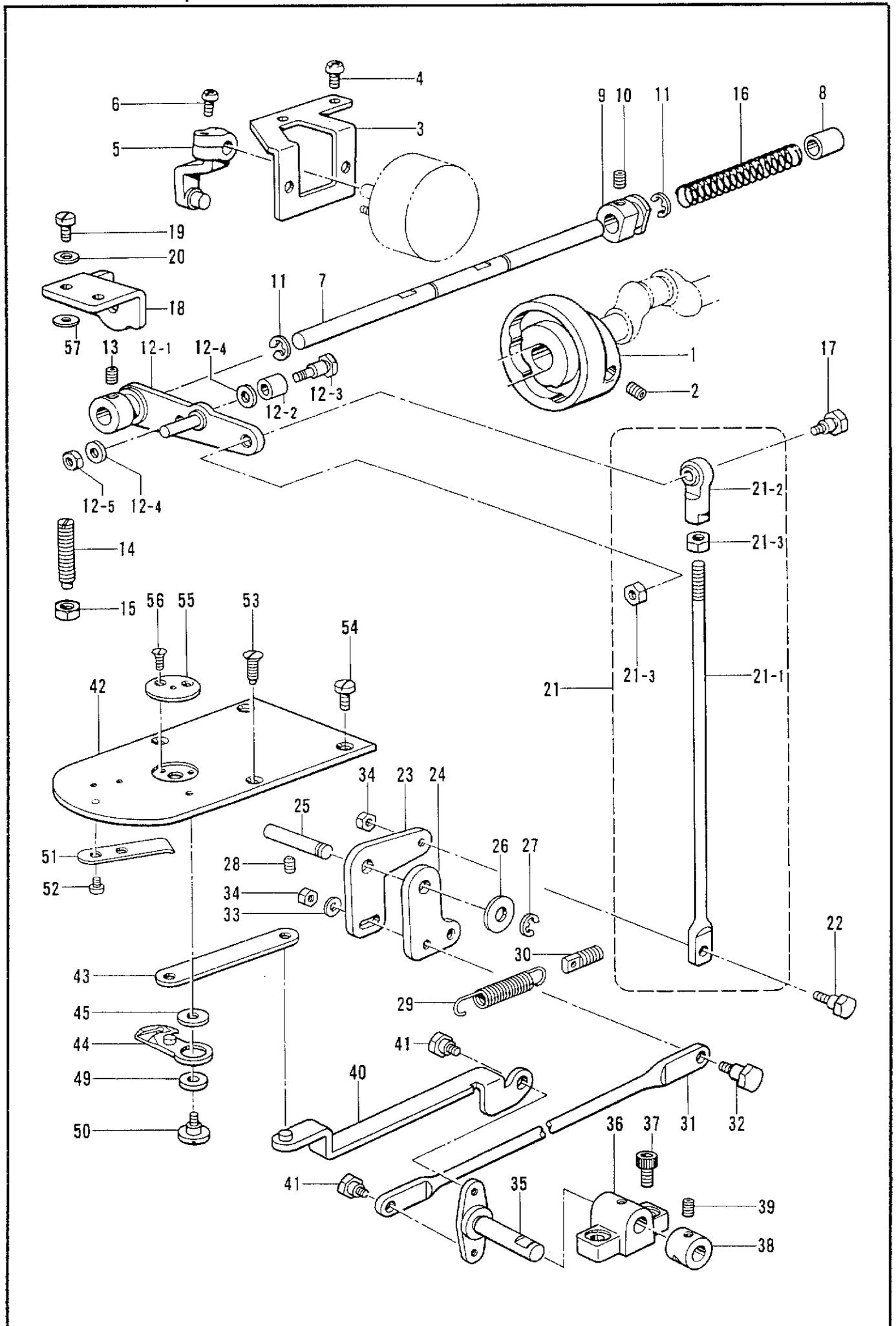
L. 糸切り関係/Thread trimmer mechanism/Fadenabschneidevorrichtung/
