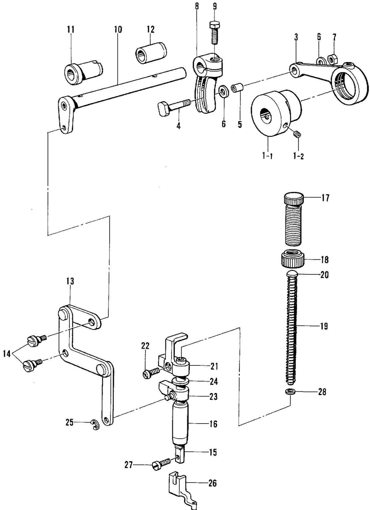
E. 押工上げ関係/Work clamp lifter mechanism/Stoffhalterhebevorrichtung/
