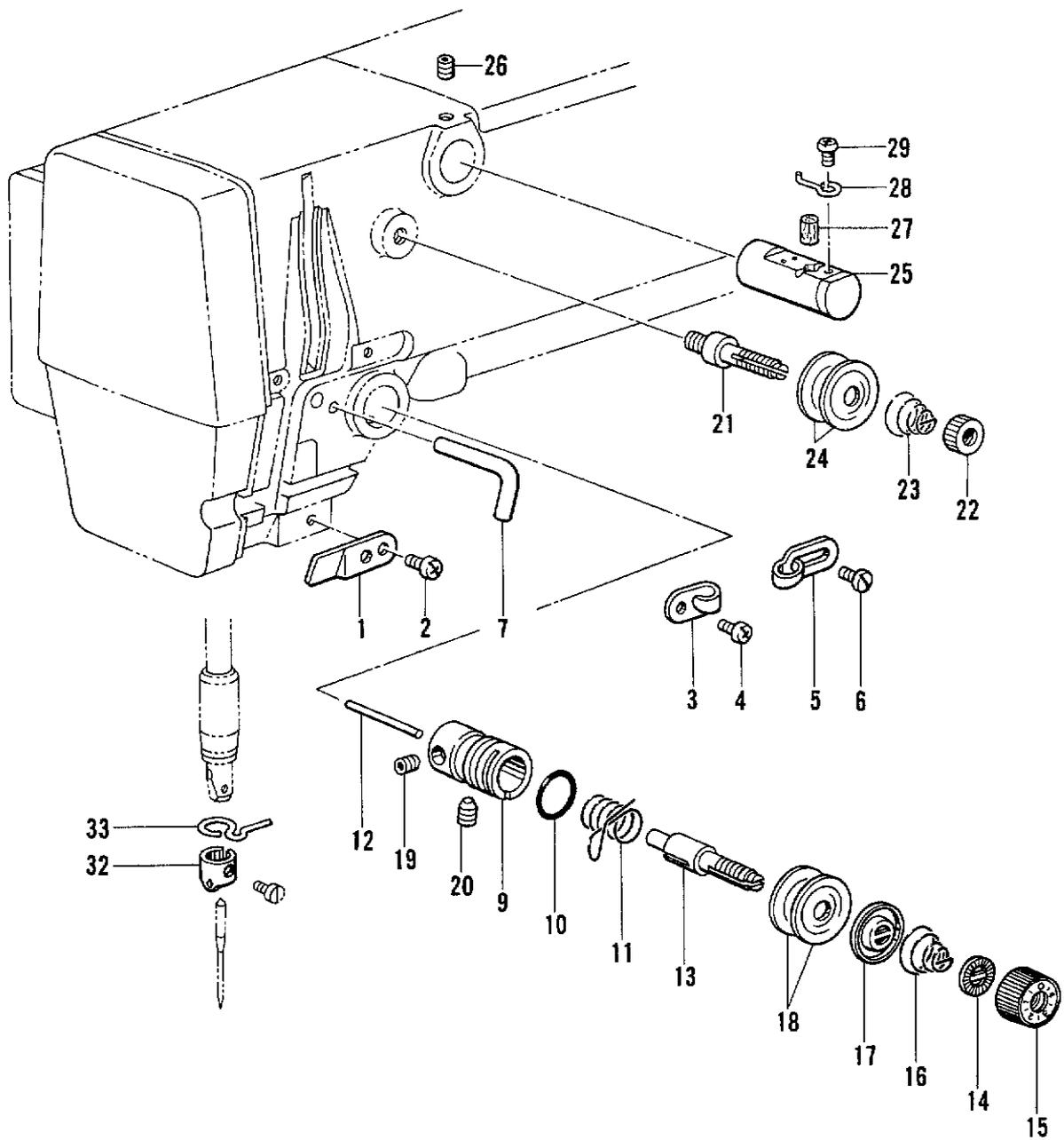
J. 糸通シ関係/Threading mechanism/Fadenführungs-vorrichtung/
