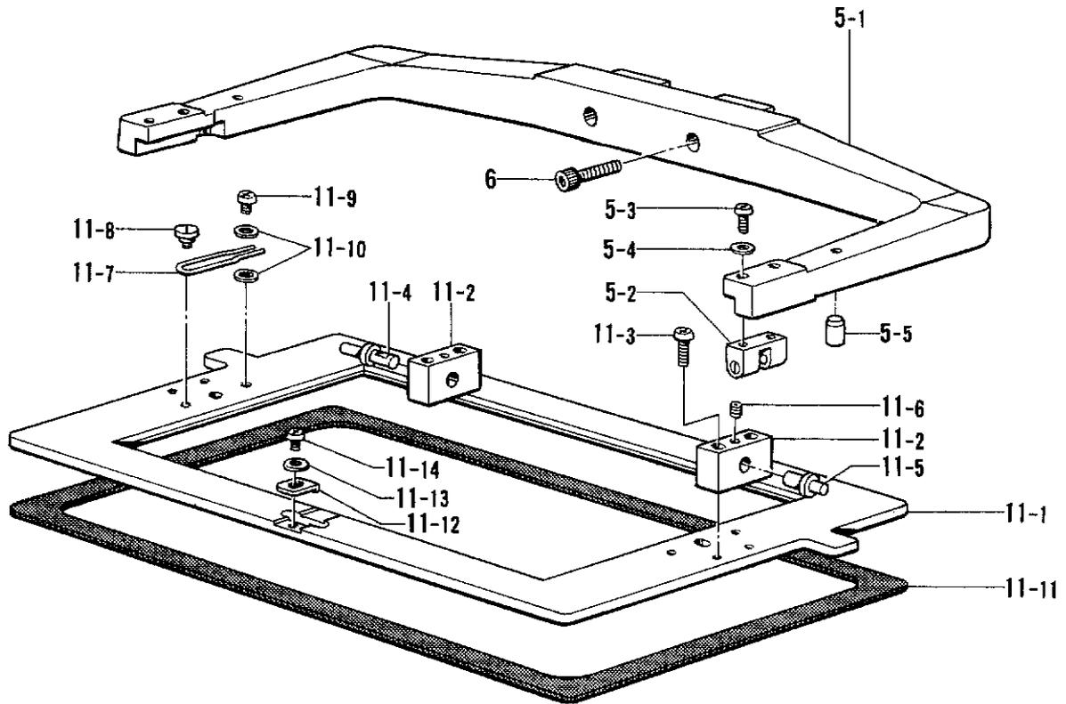
エア-2体押し工用/FOR AIR SEPARATION PRESSER
