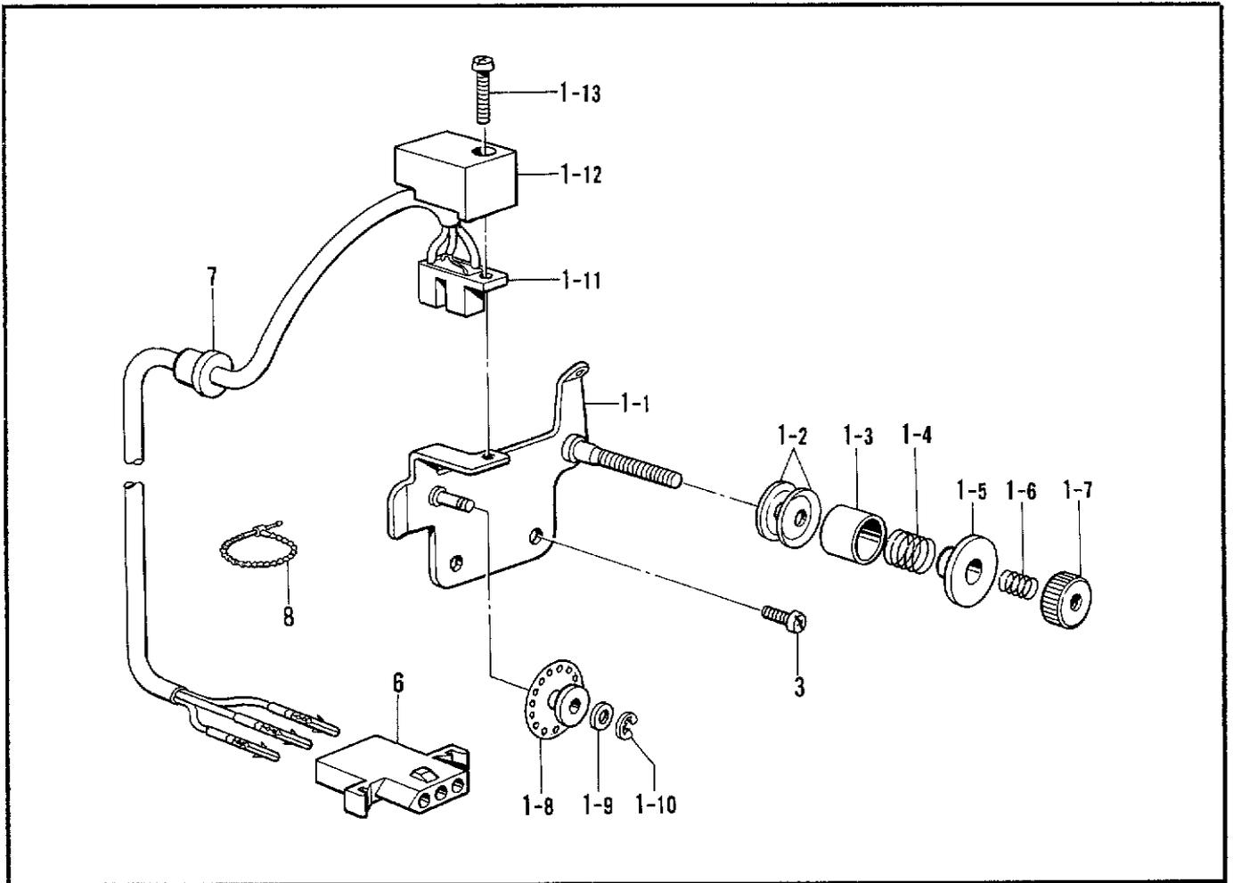
N. 糸払い関係 / Thread wiper mechanism / Fadenwischvorrichtung /
