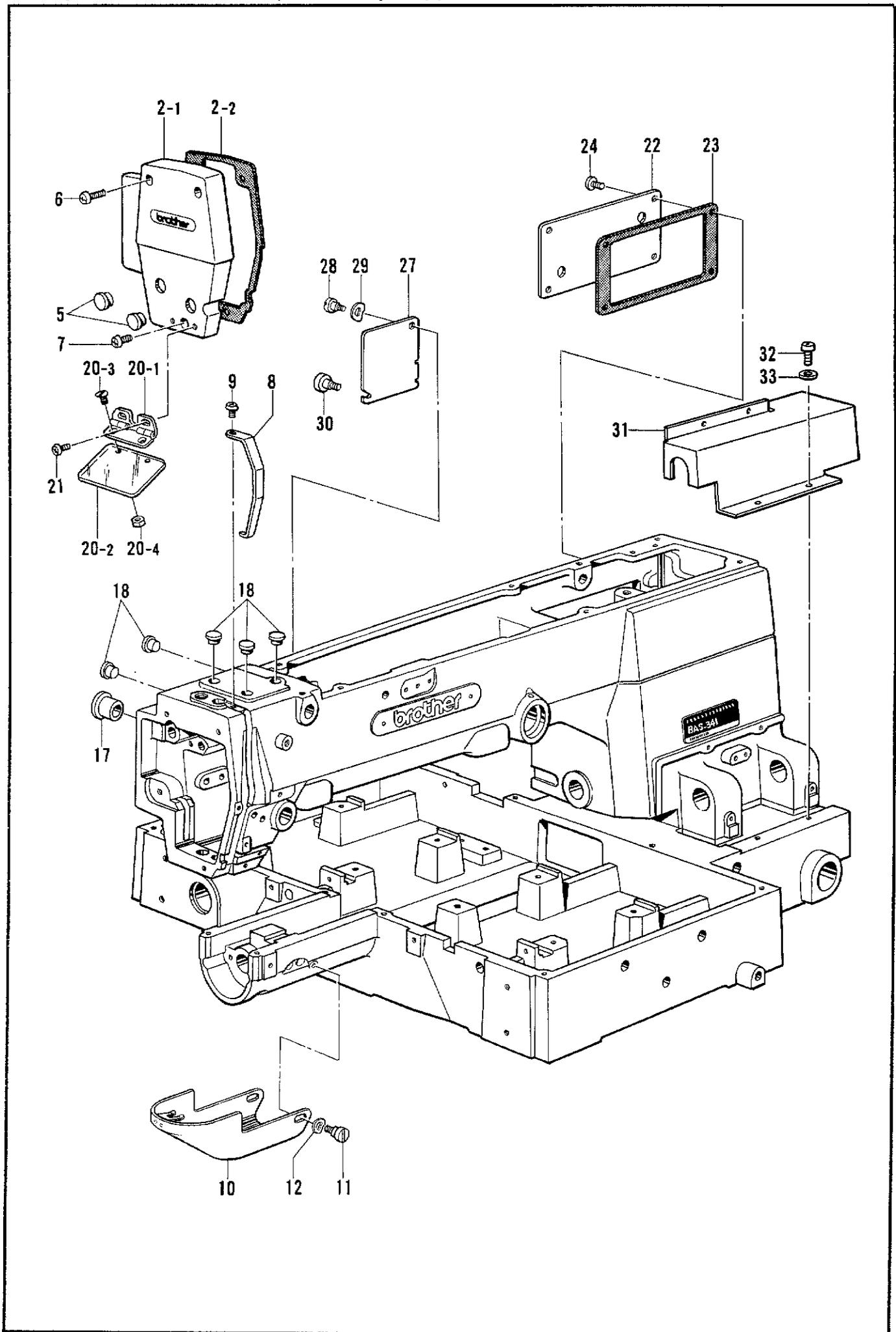
A. 主体関係(1)/Machine body (1)/Maschinengehäuse (1)/
