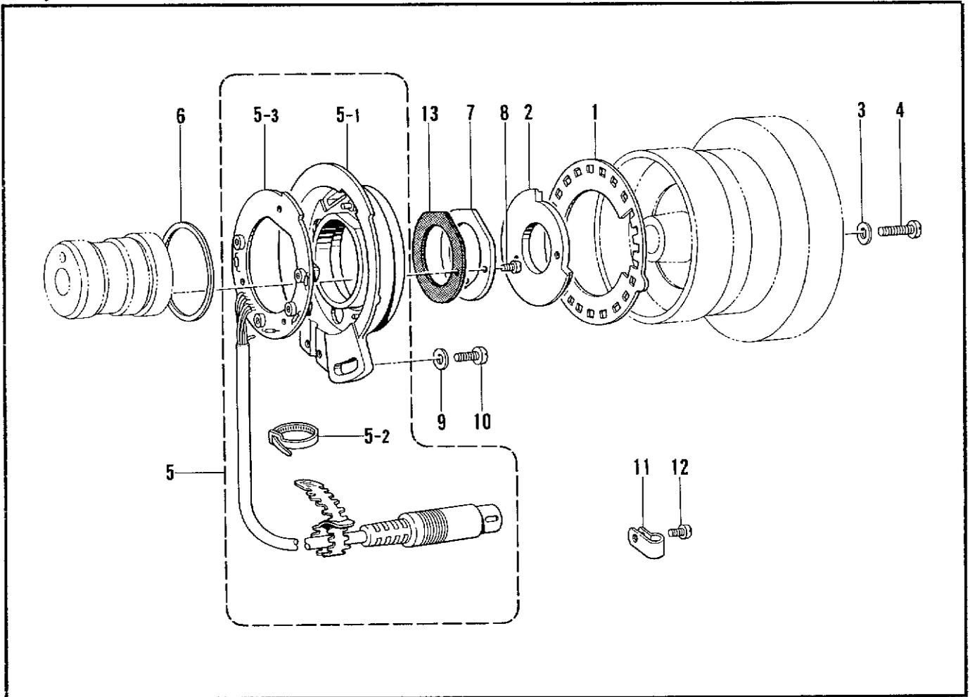
S. 踏板関係 / Foot switch pedal mechanism / Fußbetätigung /
