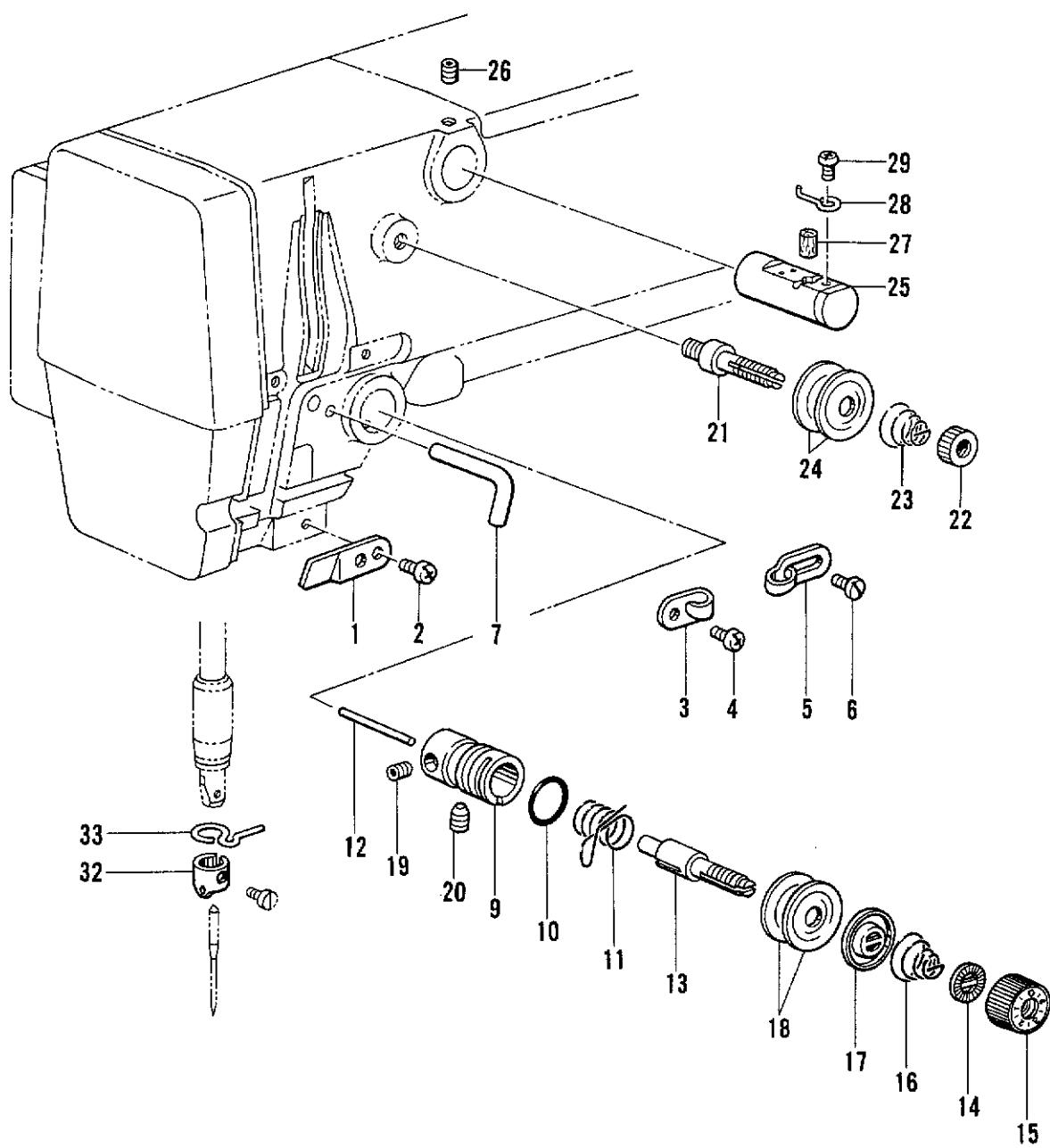
J. 糸通し関係 / Threading mechanism / Fadenführungs vorrichtung /
