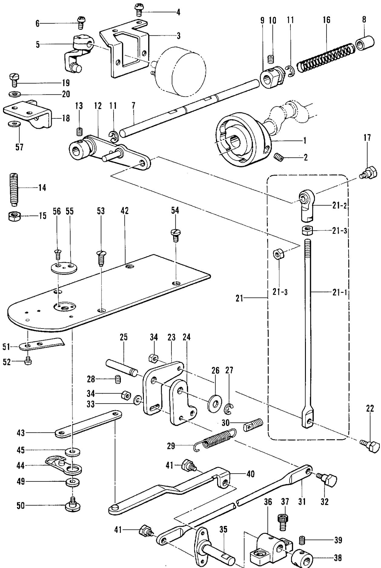
L. 糸切り関係 / Thread trimmer mechanism / Fadenabschneidevorrichtung /
