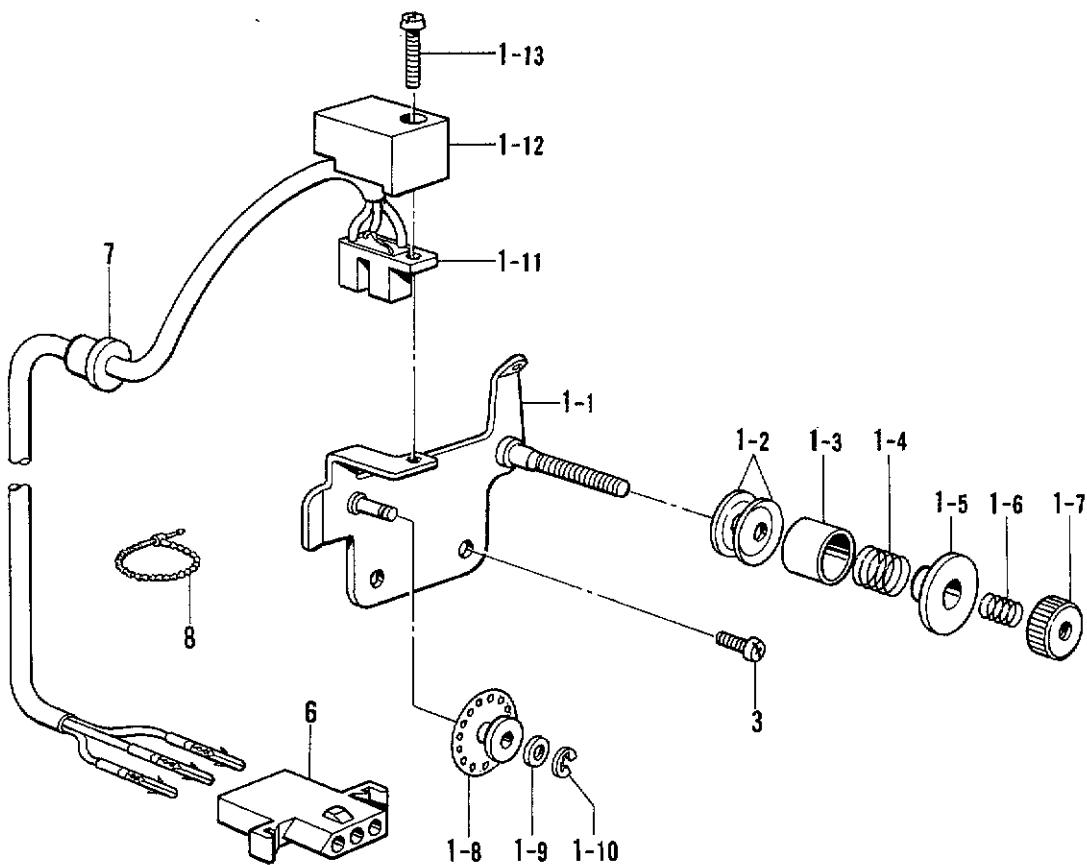
N. 糸拭い関係 / Thread wiper mechanism / Fadenwischvorrichtung /
