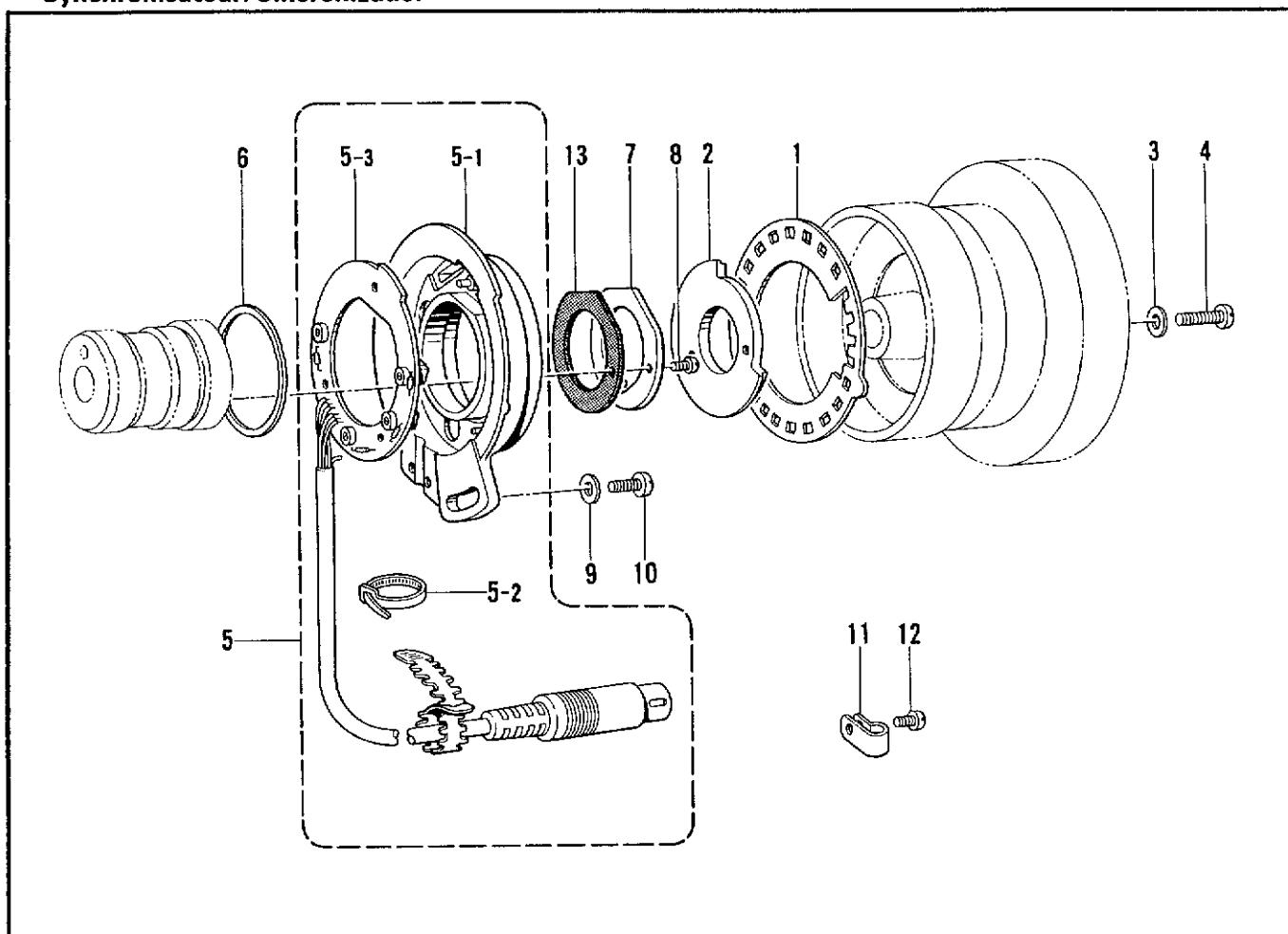
S. 踏板関係 / Foot switch pedal mechanism / Fußbetätigungs /
